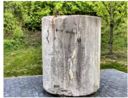
Zur stärkeren Abschirmung wurden Stahlfasern mit Beton ummantelt. Dazu wurde Normal- und Schwerbeton verwendet.
