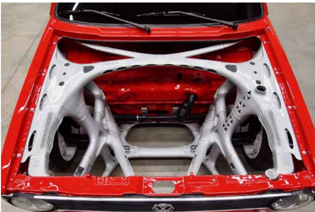
Im Rahmen des von csi initiierten 3i-Print-Projekts wurde der Vorderwagen eines VW Golfi Caddy für den 3D-Druck konstruiert, produziert und montiert.
