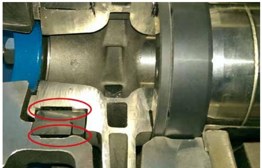
Anwendung in einer Kreiselpumpe: Um unterschiedliche Wärmeausdehnungen von Edelstahl und Siliziumkarbid im Bereich der Gleitlager der Pumpe auszugleichen, werden Toleranzhülsen als Verbindungselement eingesetzt.
