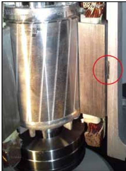
**Anwendung im Elektromotor: Die Toleranzhülse zentriert einen Stator im Gehäuse und fixiert diesen zudem gegenüber der Drehmomentkräfte des Rotors.**
