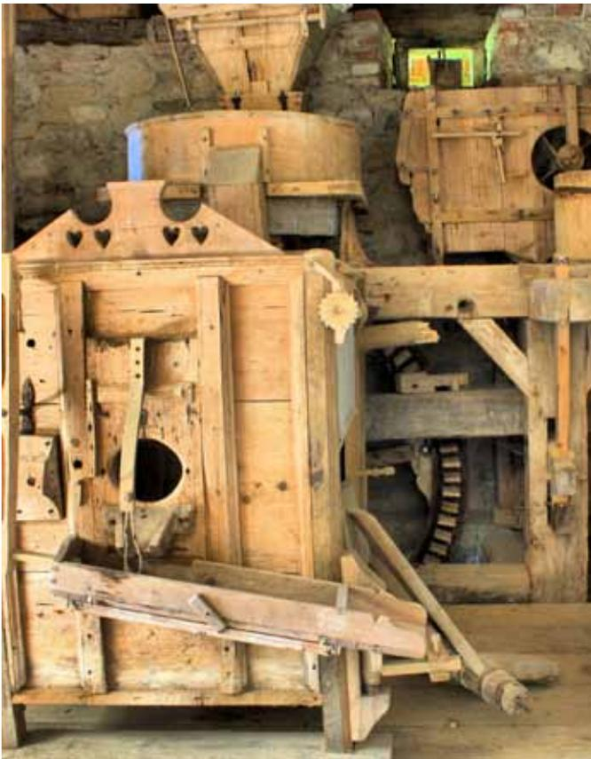
Holz ist ein universeller Rohstoff, der sich auch zum Bau von Mühlen eignet, wie dieses Modell eindrucksvoll demonstriert. Sogar Zahnräder wurden aus Holz hergestellt.
