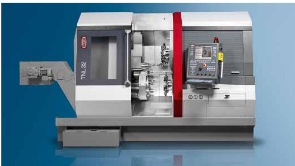
Die Traub TNL32-11 ist eine Lang-/Kurzdrehmaschine mit zwei Revolvern und dreiaxsig verfahrbarem Frontapparat. Es können drei Werkzeuge simultan und unabhängig im Eingriff sein.
