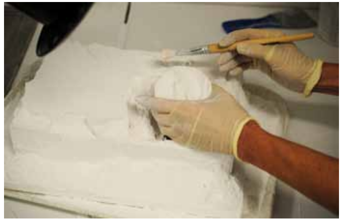
Nach dem 3D-Druck werden die Teile getrocknet, vom überschüssigen Pulver befreit und schließlich gesintert.
