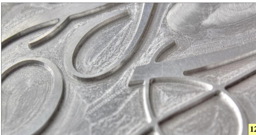
12 Prägestempel, mit Corel Draw entworfen und auf einer Graviermaschine real gefertigt
