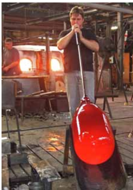
Lamberts-Glas wird von Glasmachern zunächst in eine Zylinderform gebracht, der mit etwa einem Meter Länge die Grundlage für das spätere Flachglas bildet.
