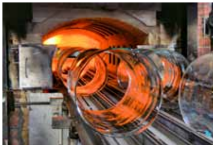
Nach dem Aufschlitzen wird er auf 850 Grad Celsius erhitzt und dadurch formbar. Dies erlaubt, ihn am Ofenende auf einer flachen Platte abzuwickeln.
