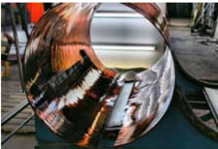
Damit aus einem Zylinder ein flaches Gebilde wird, muss er auf der Längsseite aufgeschnitten werden, wodurch eine Abwicklung möglich wird.
