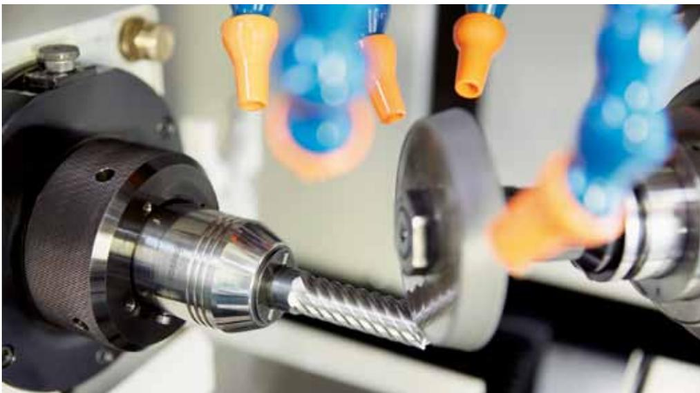
›Tendo WZS‹ des Spannmittelspezialisten Schunk gewährleistet beste Formgenauigkeit, überzeugende Oberflächenqualität und hohe Rundlaufgenauigkeit.
