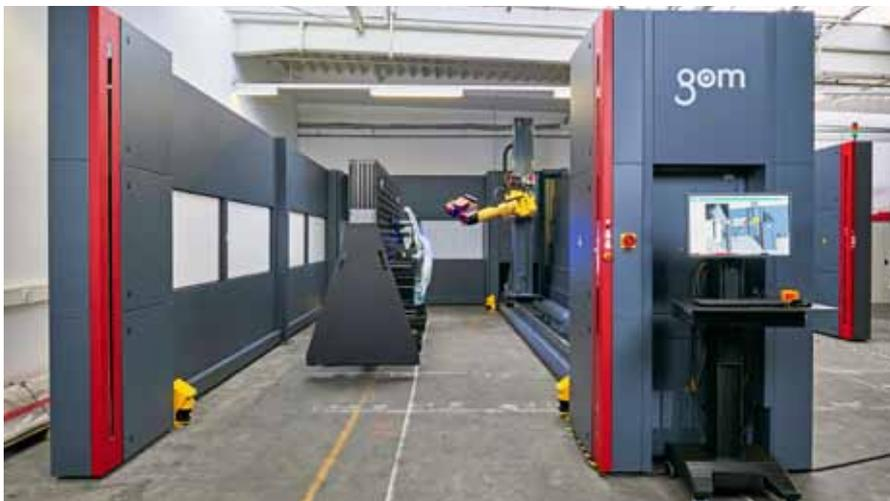
Mit der ›Atos Scanbox 7260‹ von Gom hat sich der Messablauf um mehr als 80 Prozent beschleunigt, außerdem der Programmieraufwand auf einen halben Tag reduziert.
