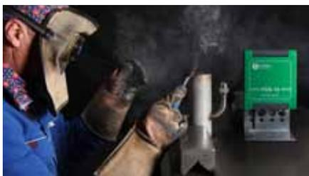
Wissen können Lüftungsanlagen effizienter gesteuert und Krankheitsfälle sowie Produktmängel vermieden werden. Das Gerät besitzt zwei optische Sensoren, die den Staubgehalt auf Basis der Streulichtmessung ermitteln. In der Standardausführung wird damit ein Staubgehalt von 3 bis zirka 200 µg/m<sup>3</sup> nachgewiesen. Die angesaugte Luft wird dabei auf 50 Grad Celsius vorkonditioniert und konstant auf diesem Niveau gehalten, um vergleichbare Messresultate zu erhalten.
