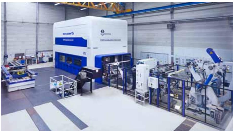
Mit Schulers 1600 Tonnen-Pressen mit Twinservo-Technik erhöht Fiuka die Teile-Qualität, Werkzeugstandzeiten, die Prozesssicherheit und die Produktivität.
