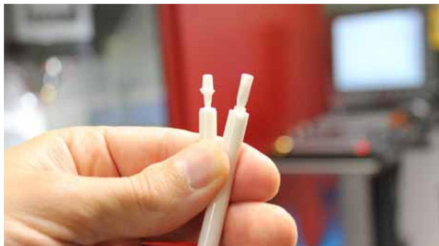
Die Kern Micro Keramik macht's möglich: Hartkeramik wird gefräst, geschliffen sowie mit Gewinden und Bohrungen versehen.
