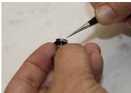
**Auch beim Überziehen eines dem Grip dienenden Kunststoffrings auf das Rad sind Handarbeit und ein gutes Auge angesagt. Hier zeigt sich, mit wie viel Liebe zum Detail von den Tillig-Experten Modelleisenbahnen produziert werden.**
