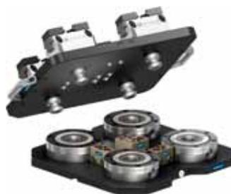
kann sie von oben oder von unten befestigt werden. Das Modul ist mit zwei unabhängig voneinander ansteuerbaren Fluid-Durchführungen ausgestattet und für einen Systemdruck bis 250 bar ausgelegt. Wie alle Komponenten aus dem Vero-S-Modulprogramm ist auch die rostfreie Medienübergabe langlebig ausgelegt. Wartungsarme, speziell abgedichtete Kuppelungen gewährleisten einen prozesssicheren Wechsel und Betrieb.
