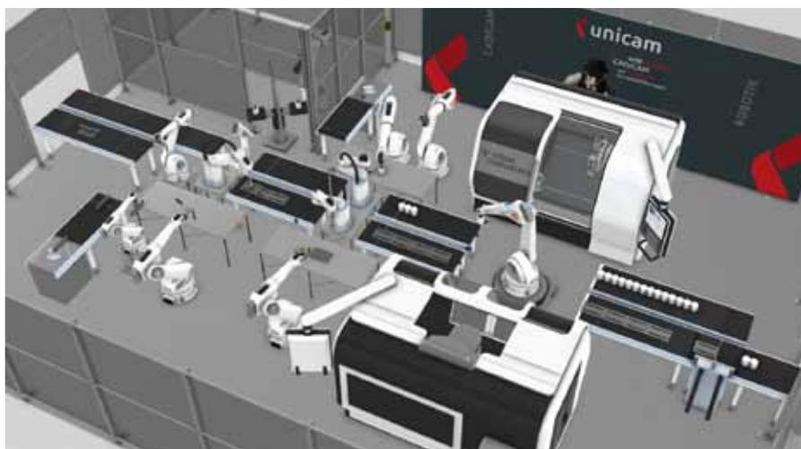
Mit ›Visual Components‹ können ganze Hallen geplant und Produktionsabläufe mit einem oder mehreren Robotern simuliert werden.
