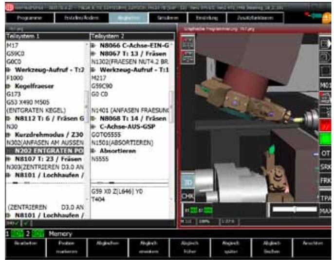
Die CNC-Steuerung TX8i-s V7 – i4.0 ready punktet mit Werkzeugbruchüberwachung, Simulation und Kollisionsschutz.
