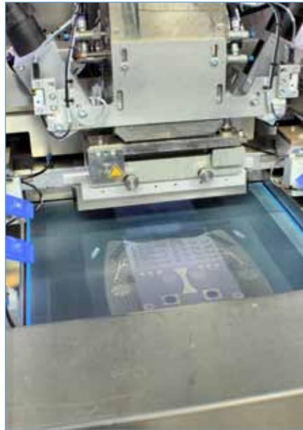
Für kleine 3D-Teile mit winzigen Geometriemerkmalen hat das Fraunhofer-Institut ›IFAM‹ eine echte Innovation erschaffen: das 3D-Metall-Drucken, bei dem die Siebdrucktechnik zum Einsatz kommt.
