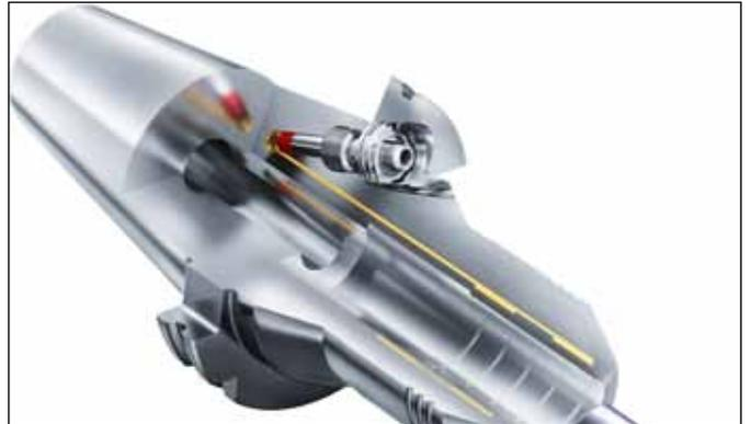
Beim Spannvorgang wölbt sich die dünnwandige Dehnbüchse des ›Tendo WZS‹ gleichmäßig aus. Dabei wird der Schaft zunächst zentriert und anschließend vollflächig gespannt.
