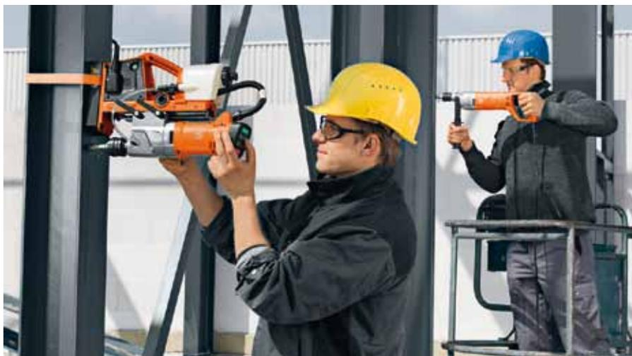
**Kernbohrmaschinen von Fein sind leistungsstark und dennoch kompakt. Sie eignen sich zum Kern- und Spiralbohren, Gewindebohren, Senken sowie zum Reiben.**
