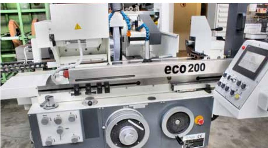
Die ›ECO 200‹ ist eine preislich attraktive Einstiegsmaschine. Aber auch diese besitzt die Präzision aller Weiss-Rundschleifmaschinen.
