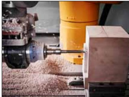
Je nach eingesetztem Roboter kann dieser Zerspanen, Schleifen, Bohren, Cuttern oder Entgraten, Polieren und Messen.
