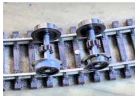
**Sinnvolles Detail: Kunststoffringe an jedem Rad, im Bild auf dem linken vorderen Rad sichtbar, sorgen für mehr Grip, um das Durchdrehen der Räder beim Ziehen schwerer Lasten oder beim Anfahren an Steigungen zu verhindern.**
