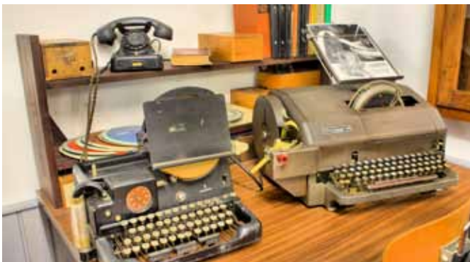
Lochstreifenstanzer und -leser waren lange Zeit die modernste Möglichkeit, Linotype-Maschinen automatisiert Lettern produzieren zu lassen.
