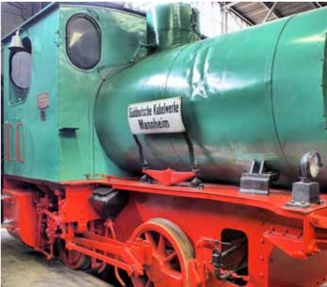
Die Dampfspeicherlokomotive wurde extern mit Dampf „betankt“. Sie war daher für Fabriken interessant, die Dampf als „Abfall“ zu Verfügung hatten.
