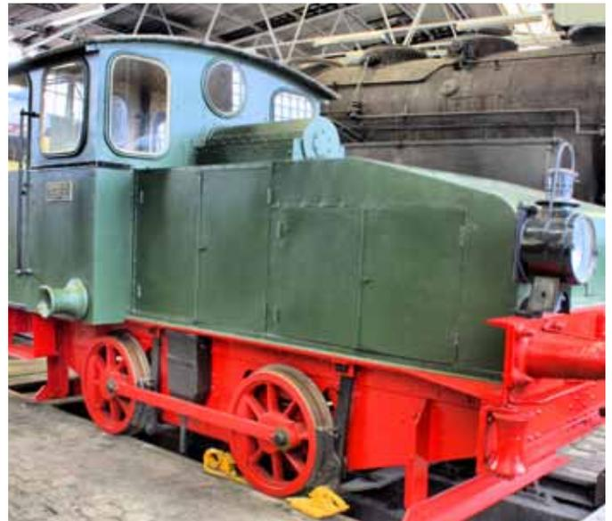
Die Petroleum-Lokomotive war für den Einmannbetrieb ausgelegt und konnte mit verschiedensten Brennstoffen, wie Benzol, Petroleum, Benzin oder Spiritus betrieben werden.
