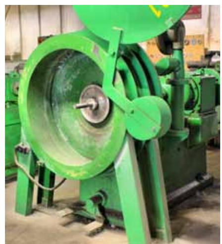
Prüfmaschinen in unterschiedlicher Größe sorgen dafür, dass Sebald-Schleifscheiben gefahrlos genutzt werden können.
