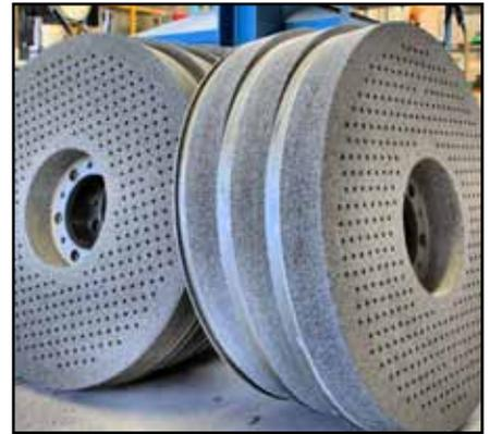
Besondere Schleifscheiben für die Stirnseitenbearbeitung von Druckfedern sind Spezialitäten von Sebold.
