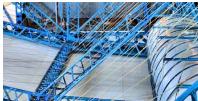
Nachbau des Zeppelin-Aluminiumgerippes.
