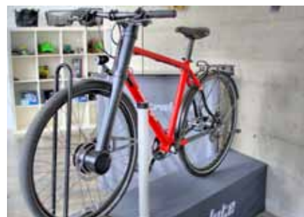
Das Vorderradrohr der Modelle »Brandstifter« und »Straßenfeger« dient als Motoraufhängung sowie als Akku-Fach.
