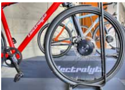
Dank besonderer Konstruktion kann bei zwei Modellen ein Reifen ohne Vorderrademontage geflickt werden.
