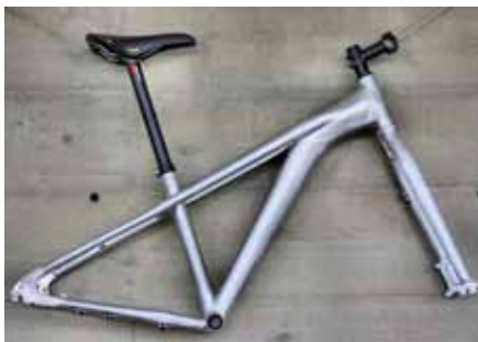
Jedes Exemplar des aus Aluminium bestehenden Rahmens wird an die Statur sowie das Gewicht des Nutzers angepasst.
