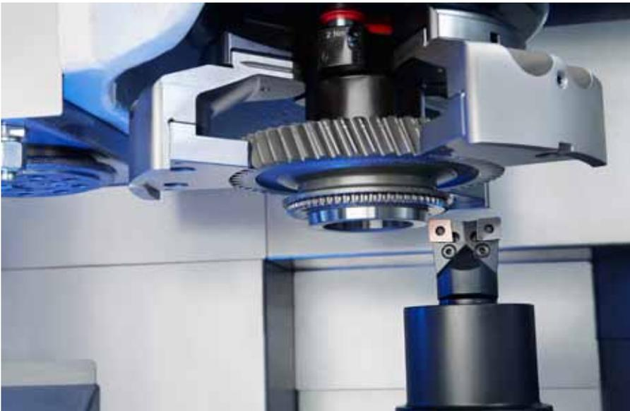
**Die kombinierte Dreh-Schleif-Bearbeitung mithilfe einer Pick-Up-Spindel sorgt für schnellere Produktionsprozesse. Die gesamte Getrieberad-Herstellung profitiert.**
