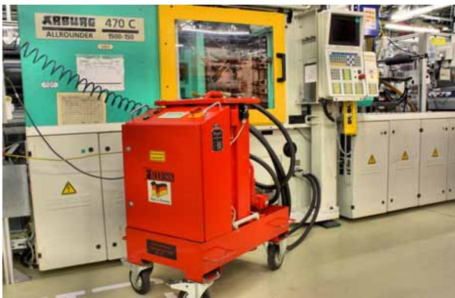
Das elektrostatische Ölreinigungsgerät ›D8‹ von Friess wird mittels Schnellkupplungen an die Hydraulikanlage der Spritzgussmaschine angeschlossen, wodurch Verschmutzungen der Umgebung beim Reinigen des Öls ausgeschlossen sind.
