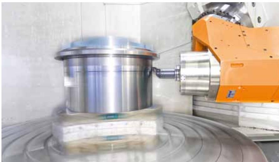
Auf Quadratpolplatten können im Wechsel unterschiedliche Teile bearbeitet werden. Zudem sind sie mit wenigen Handgriffen vom Maschinentisch entfernt.
