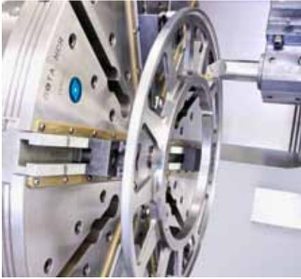
Bei labilen Teilen, wie diesem Flansch, gewährleisten 6-Backen-Pendelausgleichsfutter eine deformationsarme Aufspannung und einen sicheren Halt.
