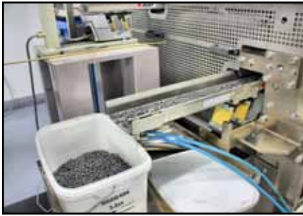
Das für das Spritzgießen nötige Granulat stellt Horn selbst her, was eine wesentlich Grundlage für die hohe Qualität der Wendeschneidplatten aus Tübingen ist.
