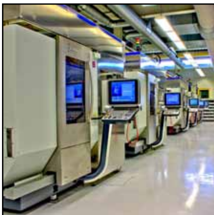
DMG-BAZs wurden von Horns Spezialisten zu leistungsstarken Wendepaltenschleifmaschinen umgebaut.
