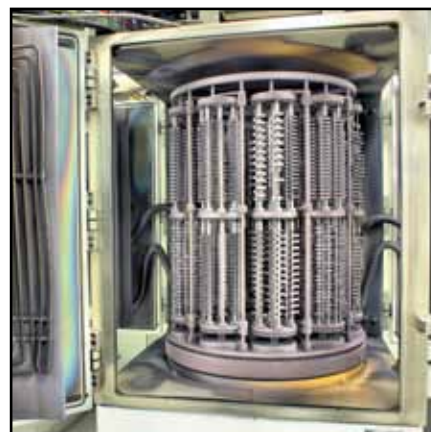
Mittels dem CVD-Verfahren bekommen die Hartmetallwerkzeuge eine harte Oberflächenbeschichtung.
