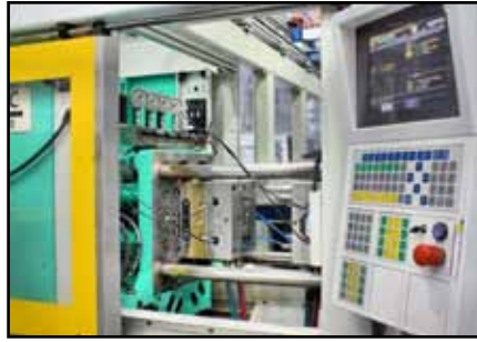
In modifizierten Spritzgießanlagen wird das HM-Granulat zu Grünlingen gespritzt, die durch nachfolgendes Sintern ihre Gebrauchsfestigkeit erhalten.
