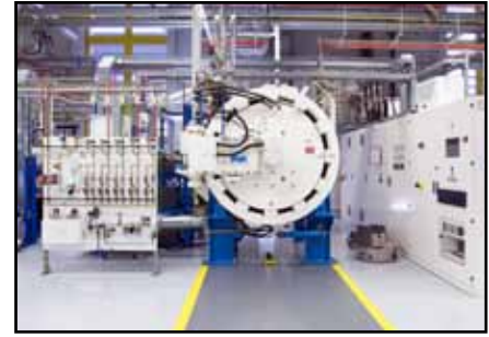
Beim Sintern bekommt der noch weiche Grünling bei hohen Temperaturen von über 1000 Grad Celsius seine Gebrauchsfestigkeit.
