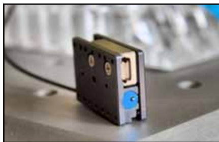
Der Piezo-Aktor »MS 15« besitzt kleinste Abmessungen. Dennoch ist ein Verfahrenweg von mehreren Millimetern gegeben.
