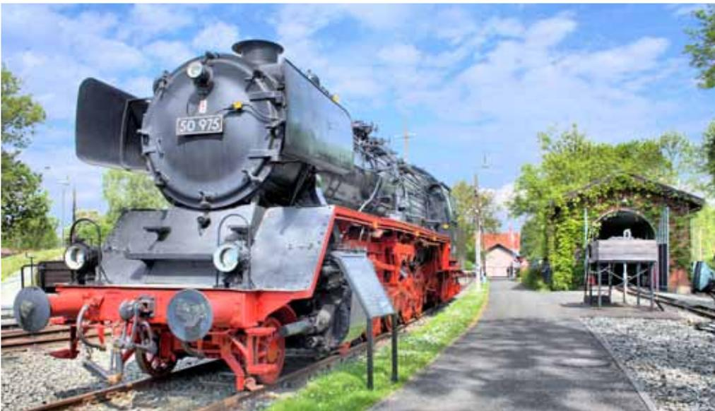
Das Modell »50 975« konnte sowohl vorwärts als auch rückwärts mit 80 km/h fahren. Dadurch musste sie nicht unbedingt auf einer Drehscheibe gewendet werden, die zudem vielfach für die lange Lok sowieso zu klein waren. Ihre Konstruktion prädestinierte diese Lok für alle Aufgaben.
