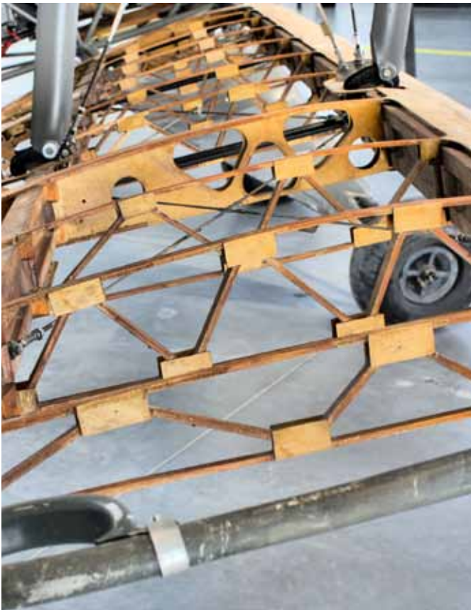
Den Aufbau einer Bucker Jungmann kann der Besucher genau ergründen. Es zeigt sich, dass Holz schon immer ein wichtiges Material für Flugzeugbauer war.
