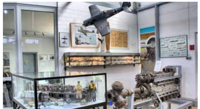
Der 1731 PS starke Motor einer abgestürzten Focke-Wulf 190D dokumentiert die hoch entwickelte Motorentechnik damaliger deutscher Jagdflugzeuge.
