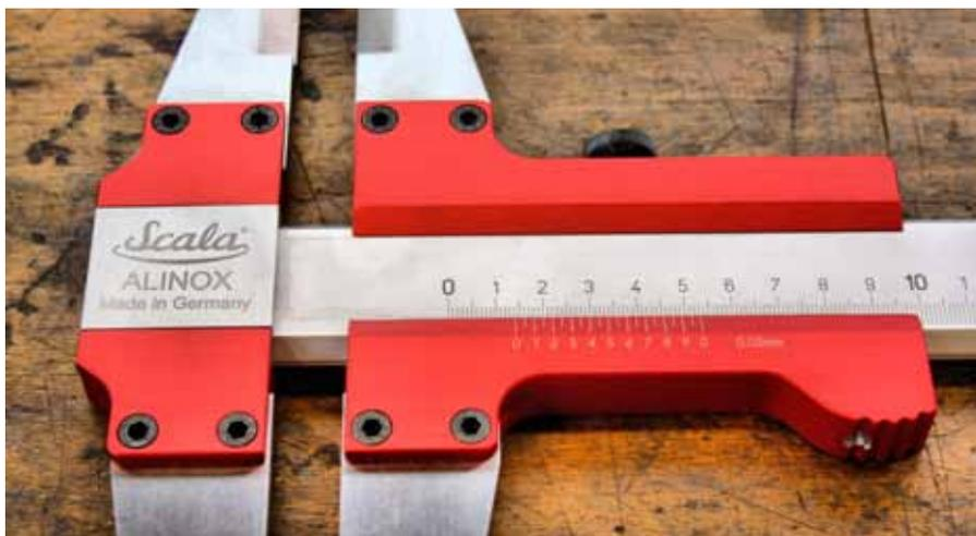
Ob feste oder bewegliche Messspitze, ob fester oder beweglicher Messschenkel – alle Komponenten sind am Messschieber verschraubt, sodass diese im Fall einer Beschädigung oder einer neuen Messaufgabe getauscht werden können.
