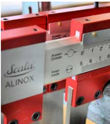
Dank der Modulbauweise sind im Alinox-Programm sogar Nonius-Varianten problemlos möglich.
