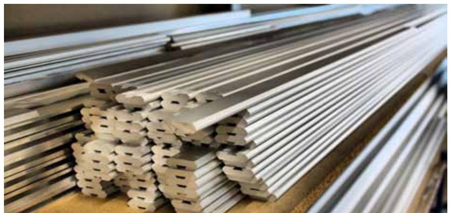
Die Messschiene der Alinox-Messschieber bestehen aus präzise gezogenem, eloxiertem Aluminiumprofilen. Diese ermöglichen den Bau von Messschiebern mit bis zu vier Metern Länge.
