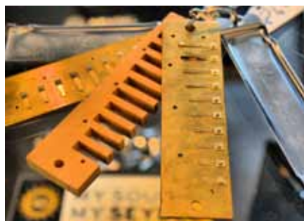
Mundharmonikas bestehen aus nur wenigen Komponenten, die jedoch mit hoher Präzision gefertigt werden müssen.
