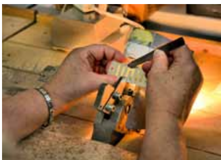
Mit dem Lichtspaltverfahren ist es möglich, Stimmzungen auf den Stimmplatten präzise auszurichten.
