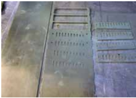
Präzise hergestellte Stanzteile sind eine wichtige Voraussetzung, damit Mundharmonikas perfekt klingen.
