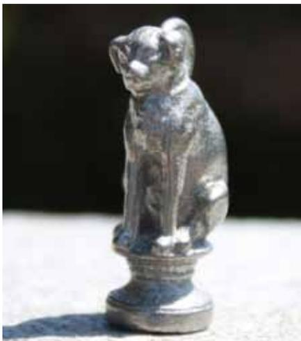
Das ›Brettener Hundle‹ wurde als digitales Abbild per Laserscanner erfasst und anschließend auf der M2 ausgedruckt.
