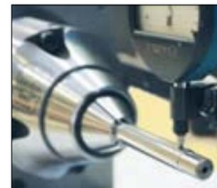
es in verschiedenen Größen. So etwa der Typ SRS W 20, dessen Einsatzspektrum im Miniaturbereich von 0,3 mm bis 10 mm Stangendurchmesser liegt. Ein Vergleichstest mit 300 HM-Werkstücken, Ø 6 mm, Prüflänge 50 mm, zeigt das Potenzial: So lag der Rundlauf mit SRS und Schaublin-Spannzange im Schnitt bei 0,0021 mm, ohne SRS bei 0,0083 mm. Die Standardabweichung betrug mit SRS 0,0018 mm gegenüber 0,0028 mm.
