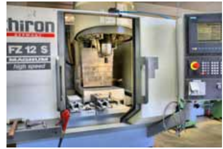
Chirons Fräsmaschine »FZ12S« mit Korbwechsler sorgt dafür, dass präzise Teile für die Brailletec-Produkte termingerecht zur Montage kommen.
