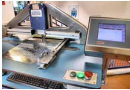
Die Punziersmaschine »Puma VII« ist ein Highlight von Brailletec. Damit werden Zinkplatten für Massendruckmaschinen in Brailleschrift hergestellt.
