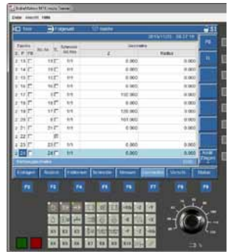
Der Werkzeugspeicher fasst in der Demo-Version beim Drehen 12 und beim Fräsen 24 Werkzeuge.
