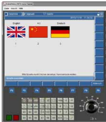
Die Tastenkombination »CTRL+Y« erlaubt es, den Simulator auf die bevorzugte Sprache des Bedieners umzuschalten.
