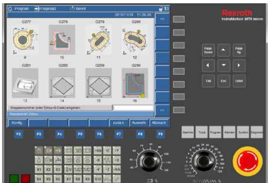
Durch die Möglichkeit des Mischens von Fräs- und Drehzyklen, lassen sich Maschinen simulieren, die kombinierte Dreh-Fräs-Operationen erlauben. Der Simulator ist daher optimal für einen besonders tiefen Einstieg in die CNC-Technik geeignet.
