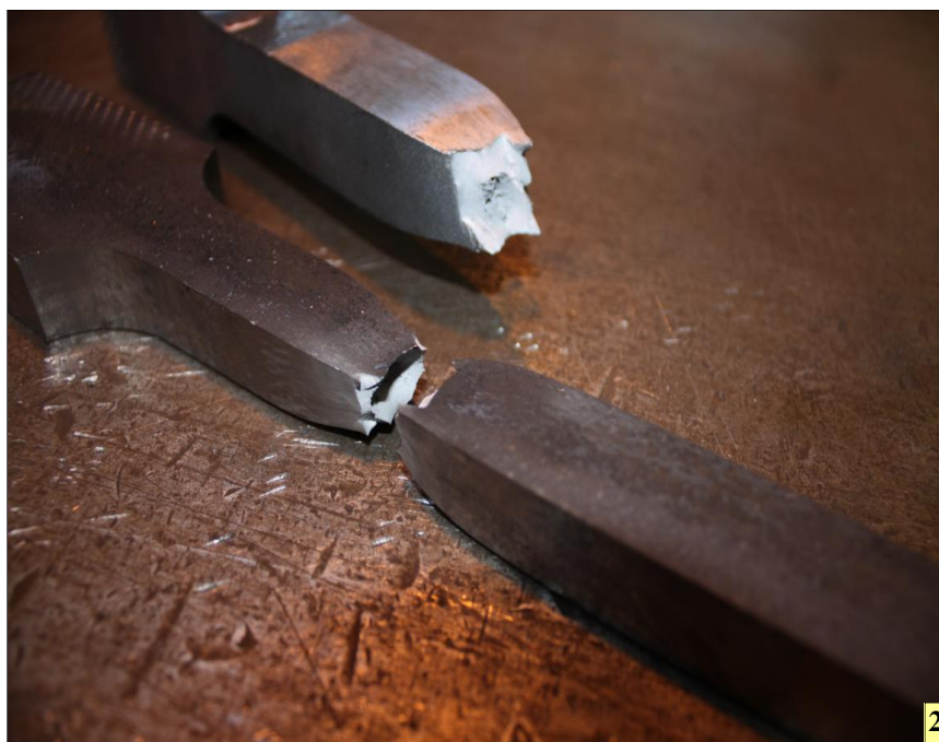
2 Die Prüfung des Stahls vor dessen Verwendung ist eine Selbstverständlichkeit, die für deutsche und europäische Hersteller selbstverständlich ist und streng überwacht wird. Stähle dubioser Herkunft können hingegen so manch negative Überraschung bezüglich ihrer Eigenschaften bieten.
