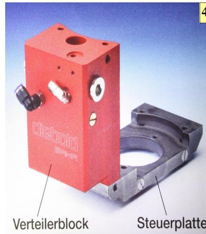
3 Der Mediumverteiler kann an Maschinen mit Pick-up-Wechsler angebaut werden. In der Steuerung werden lediglich Parameter geändert und neue Befehle eingefügt.
