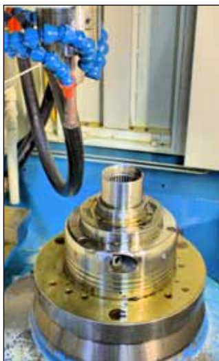
Einbringen einer Innenverzahnungen per CNC-Maschine
