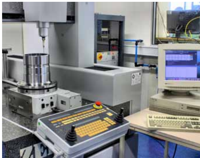
Die Messwerte der CNC-gesteuerten 3D-Messmaschine ›UMC 550‹ von Zeiss dokumentieren, ob eine Verzahnung gelungen ist
