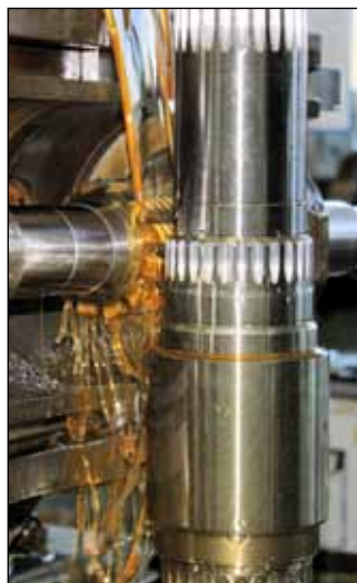
Abwälzfräsen ist die Alternative für lange Teile.
