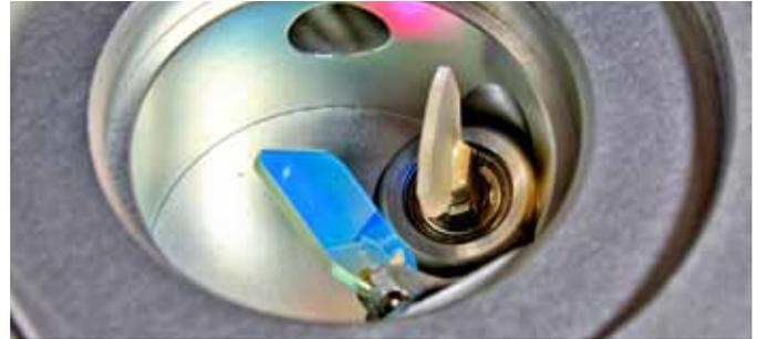
**Der Galvo-Kopf besitzt zwei Spiegel, die sich in einem engen Bereich sehr schnell bewegen und den Laserstrahl sehr rasch an die gewünschte Position ablenken.**
