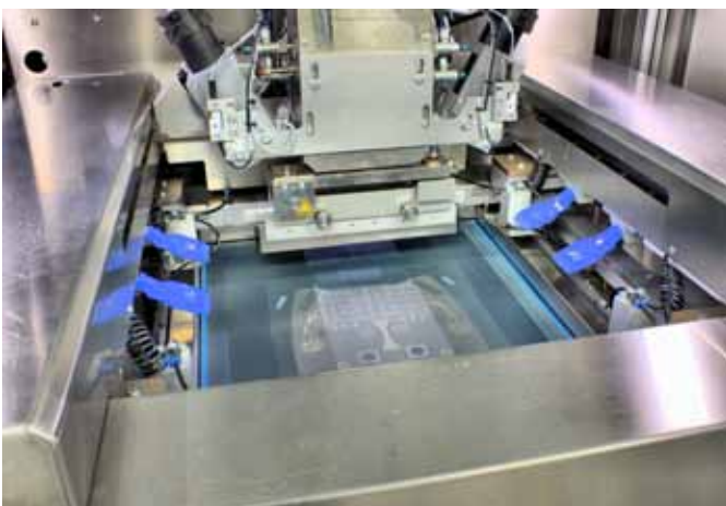
Ohne Laserstrahl entstehen aus einer Paste Schicht für Schicht winzige Teile, die nach dem Sintern gebrauchsfertig sind.
