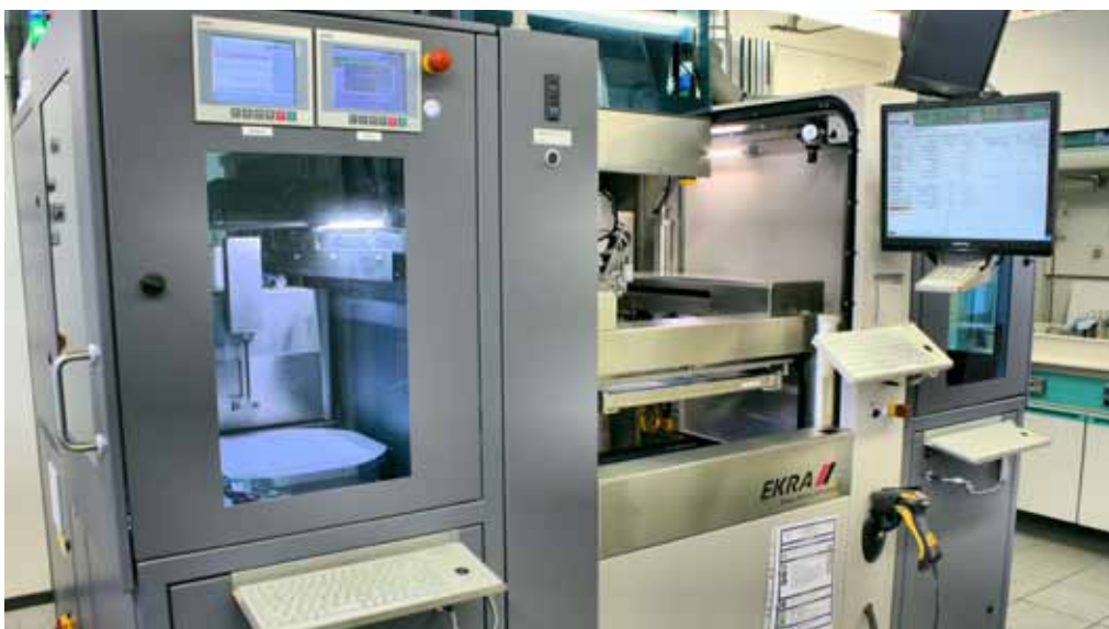
Die Ekra Automatisierungssysteme GmbH hat für das Fraunhofer-Institut IFAM eine Maschine entwickelt, die auf der Basis des Siebdrucks 3D-Teile aus Metallpulver additiv fertigt.
