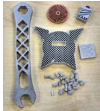
Das Verfahren erlaubt es, Teile mit kleinsten geometrischen Merkmalen zu erzeugen.
