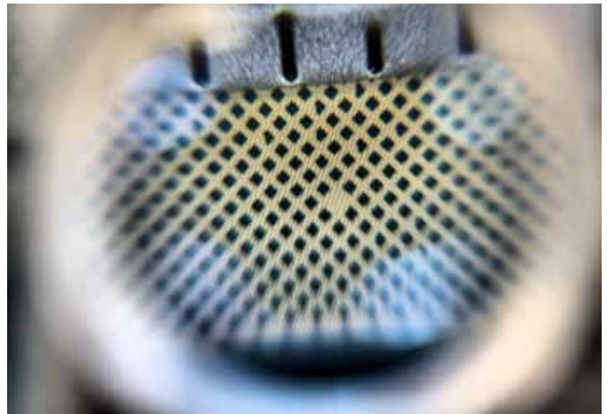
Der Durchlass im Siebdruckgewebe beträgt nur 1 bis 4 Mikrometer. Daher sind 3D-Teile mit filigransten Konturen realisierbar.
