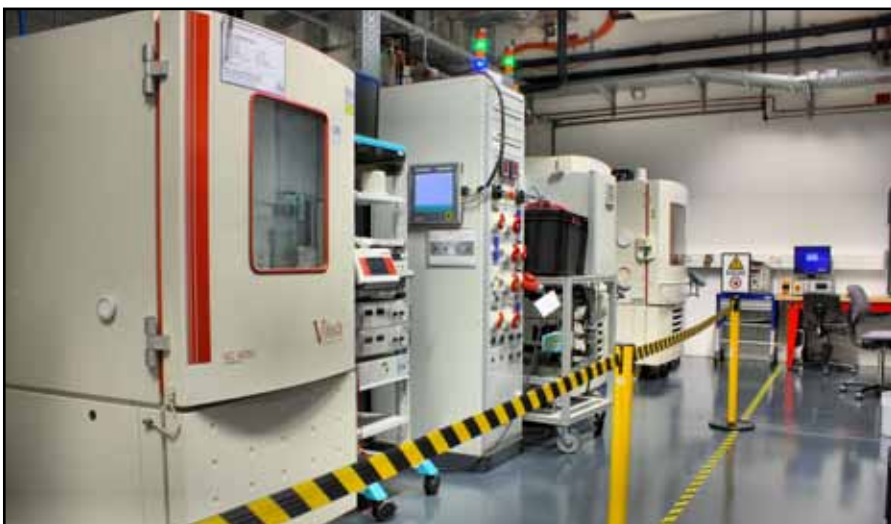
In Klimakammern müssen Prototypen und Zukaufteile ihre Tauglichkeit unter Beweis stellen, besonders hohe Vorgaben zu erfüllen.
