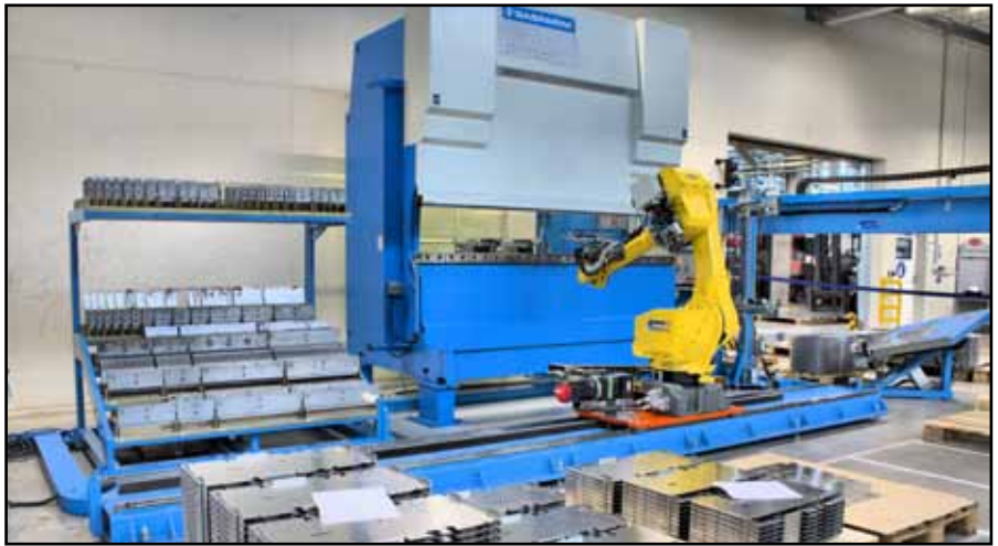
Die hohe Fertigungstiefe von Fronius ist auch bei der Blechteilefertigung sichtbar. Wo es die Stückzahlen beziehungsweise die Geometrien erlauben, werden Roboter zur Blechteilefertigung eingesetzt.
