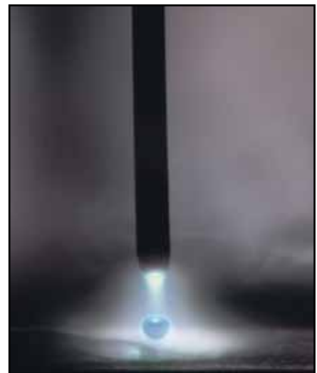
Eine Innovation von Fronius ist das CMT-Verfahren, in dem der Schweißdraht mit 130 Hertz vor- und zurückbewegt wird. Dabei wird jedes Mal ein Tropfen abgelöst, der sich mit dem zu verschweißenden Material verbindet.
