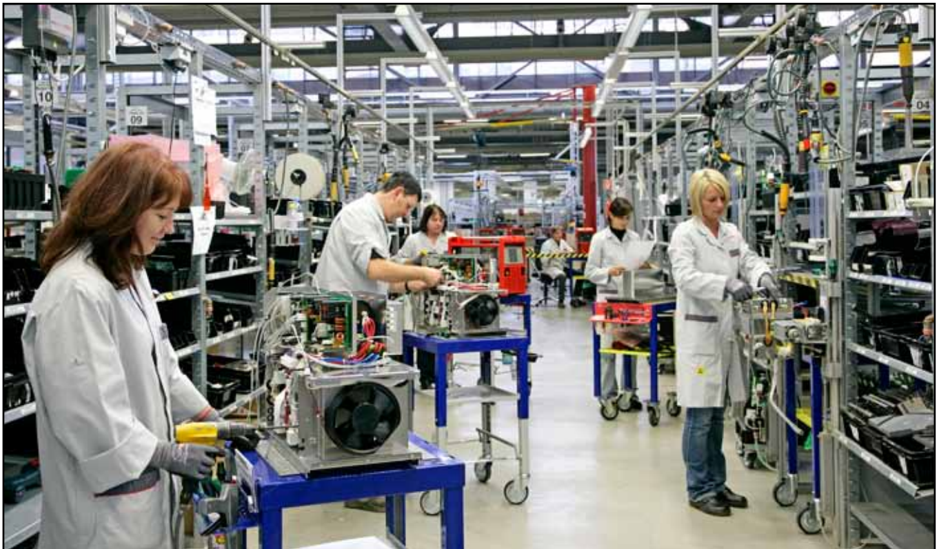
Saubere und umfangreich ausgestattete Montageplätze erlauben eine akkurate Montage der Schweißgeräte. Eine umfassende Ausgangskontrolle garantiert, dass ausschließlich funktionsfähige Schweißgeräte ausgeliefert werden.
