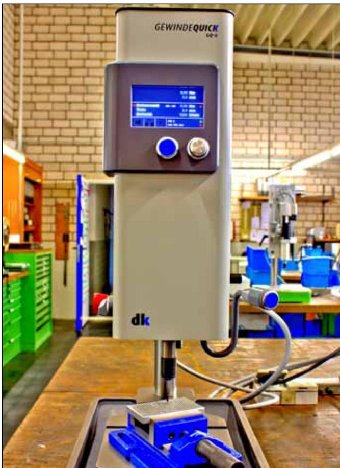
Die mit Servomotoren ausgerüsteten Gewindebohrmaschinen von dk machen Schluss mit abgerissenen Gewindebohrern. Die moderne Gewindequick-Reihe gibt es für Gewindegrößen von M 0,8 bis M 10.
