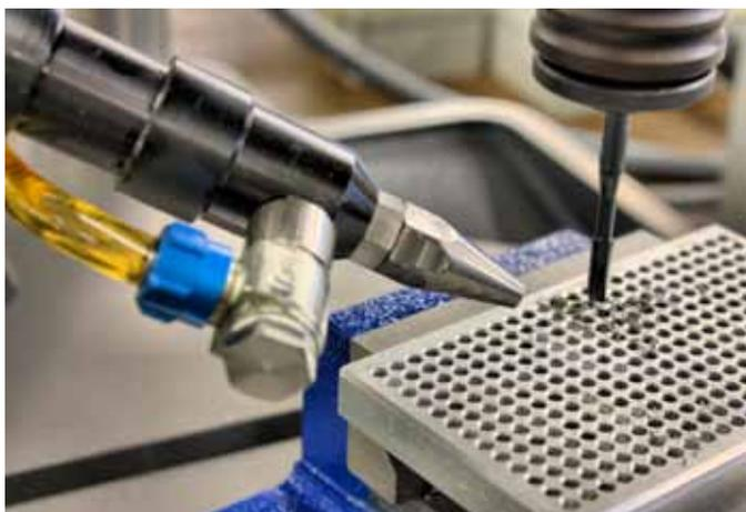
Eine optional erhältliche MMS-Einrichtung ist ideal für die Serienfertigung geeignet.
