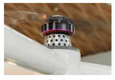
Mit seinen Propellern kann der Volocopter senkrecht starten und landen wie ein Hubschrauber. Ein wesentlicher Vorteil neben der bestechend einfachen Bauweise ist die Redundanz der Antriebe.
