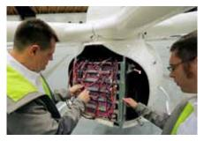
Die Flugsteuerung des Volocopters basiert auf 20 unabhängigen Computern, von denen im Prinzip jeder einzelne dieser Rechner das komplette Fluggerät alleine steuern kann.
