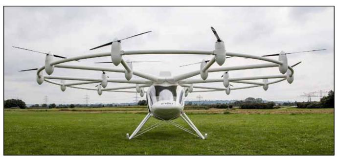
Der Volocopter von e-volo ist ein neuartiges, senkrecht startendes Fluggerät, das in keiner bekannten Kategorie einzuordnen ist. Im Gegensatz zu herkömmlichen Luftfahrzeugen ist der Volocopter von Anfang an als Fluggerät mit Elektroantrieb konzipiert.
