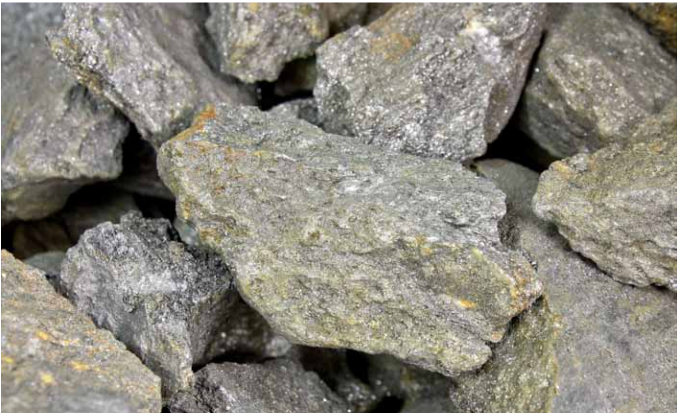
Das in Kropfmühl geförderte Graphiterz besitzt einen Graphitanteil von circa 20-25 Prozent. Dieses Gestein wird aufgearbeitet und das Graphit auf einen Reinheitsgrad von bis zu 99,99 Prozent angereichert.
