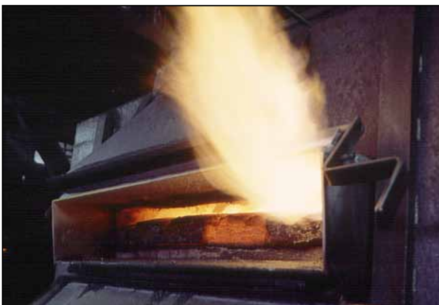
Trocknungsöfen: Hier erfolgt die thermische Reinigung des bereits zerkleinerten Graphits. Graphit ist ein unglaublich vielseitiges Mineral, das sich besonders dank seiner hohen Temperaturbeständigkeit in der Industrie großer Nachfrage erfreut.
