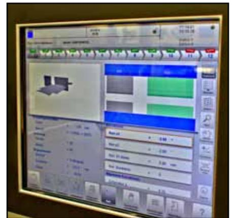
Eine leistungsstarke Steuerung sorgt für einfachstes Programmieren und Simulieren von Blechbiegearbeiten.
