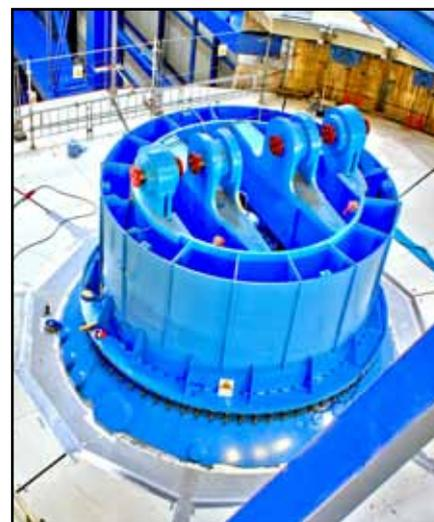
**Eine imposante Hebeeinrichtung wird den Reaktorbehälter anheben.**
