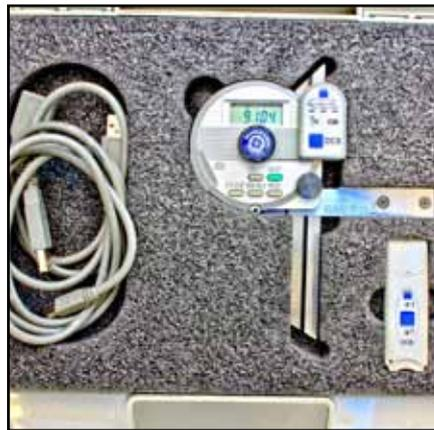
Der optional erhältliche Winkelmesser ›OCB‹ sendet via Bluetooth die Messwerte an die Maschinensteuerung.
