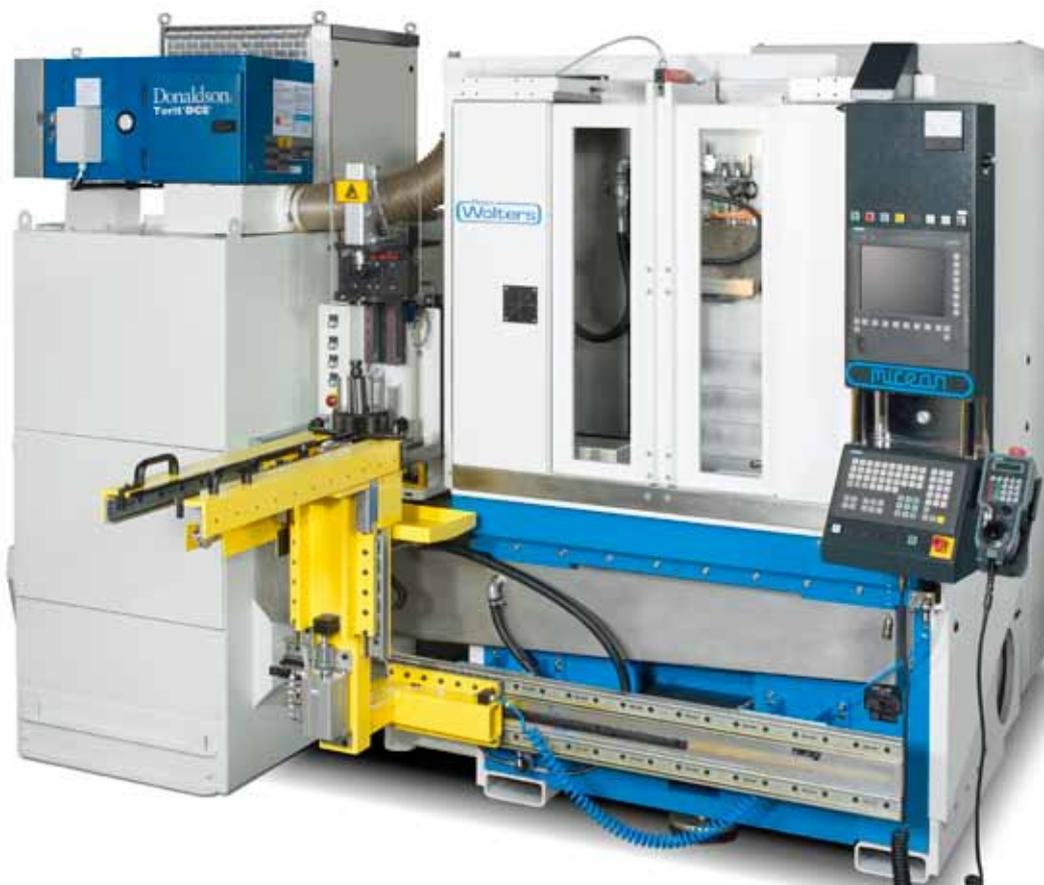
Mit der Macro-SK hat die Peter Wolters GmbH eine spezielle Maschine im Angebot, die Statoren präzise und wirtschaftlich schleift. Alle linearen Bewegungen werden vom Schleifkopf ausgeführt, ohne dass ein ausladender Tisch bewegt werden muss.
