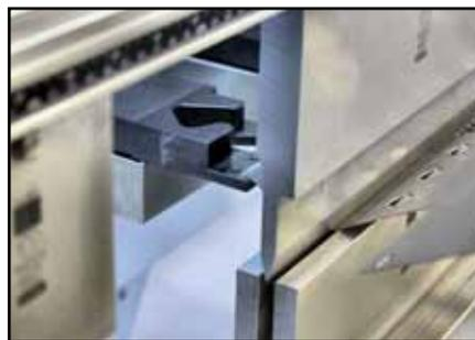
Damit hochschwingende Blechteile nicht beschädigt werden, fährt der Anschlag automatisch zurück. Selbst komplizierte Biegungen gelingen so auf Anhieb.
