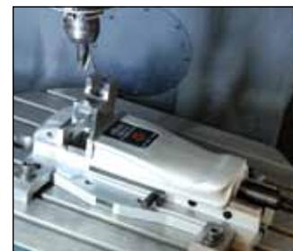
Spannpratzen oder per Direktverschraubung. Optional besteht die Möglichkeit, die Schraubstöcke auf Drehplatten einzusetzen. Beide Maschinenschraubstöcke verfügen über die gleiche Plattform und ermöglichen daher eine außergewöhnliche Flexibilität: Durch Austausch der Spindel kann vom RB-M (mechanisch betätigte Variante) auf den RB-K (manuelle Variante mit Kraftverstärkung) aufgerüstet werden.
