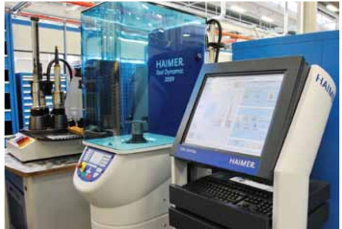
AGCO/Fendt setzt Schrumpffutter und Schrumpfanlagen sowie eine Wuchtanlage von Haimer ein.
