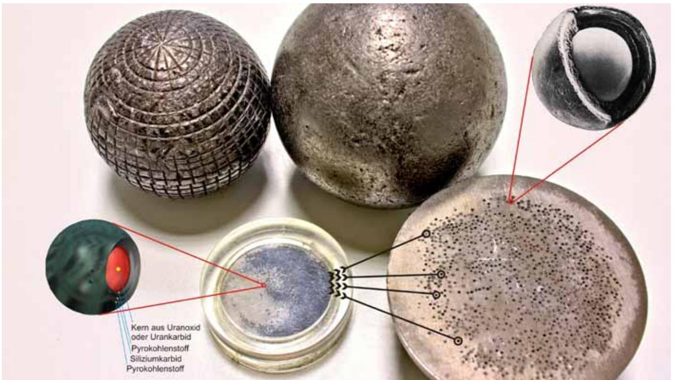
**Die kugelförmigen Brennelemente eines Kugelhaufenreaktors bestehen aus beschichteten Brennstoffkörnern von 0,5 bis 1,0 Millimeter Durchmesser, den sogenannten ›Coated Particles‹, die in Graphit eingebettet werden. Die Kugelform gestattet die Beschickung des Reaktors über Rohrleitungen, ähnlich einer Rohrpost.**
