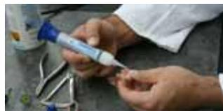
in Sekunden fast alle Materialien, wie Metall, Kunststoff, Natur- und Synthetikgummi, Glas, Keramik, Holz sowie Leder. Cyanacrylatklebstoffe von Weicon härten hochfest aus, sind temperaturbelastbar von -50 bis +135 und gegen viele chemische Einflüsse beständig.
