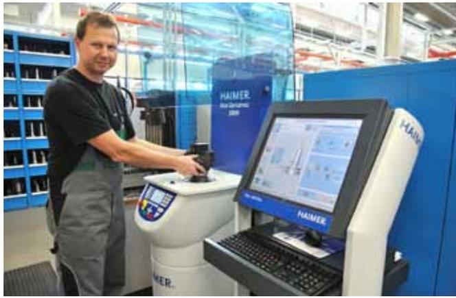
**Leichte Bedienung der Wuchtanlage von Haimer: Das Programm führt den Anwender durch den Wuchtvorgang.**
