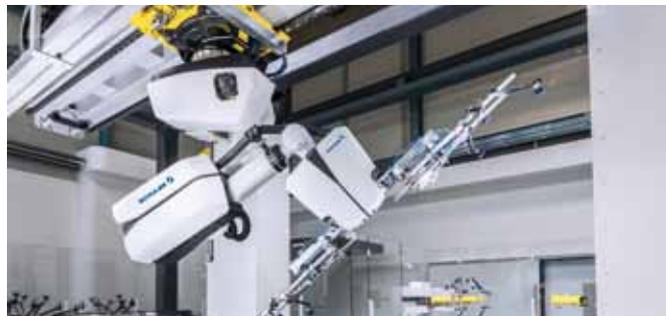
**Bis zu 15 Teile pro Minute kann der Crossbar-Roboter 4.0 von Schuler transportieren. Dank seiner Vernetzung wird er zum Analysetool, das den Prozess überwacht und Fehler rückmeldet.**
