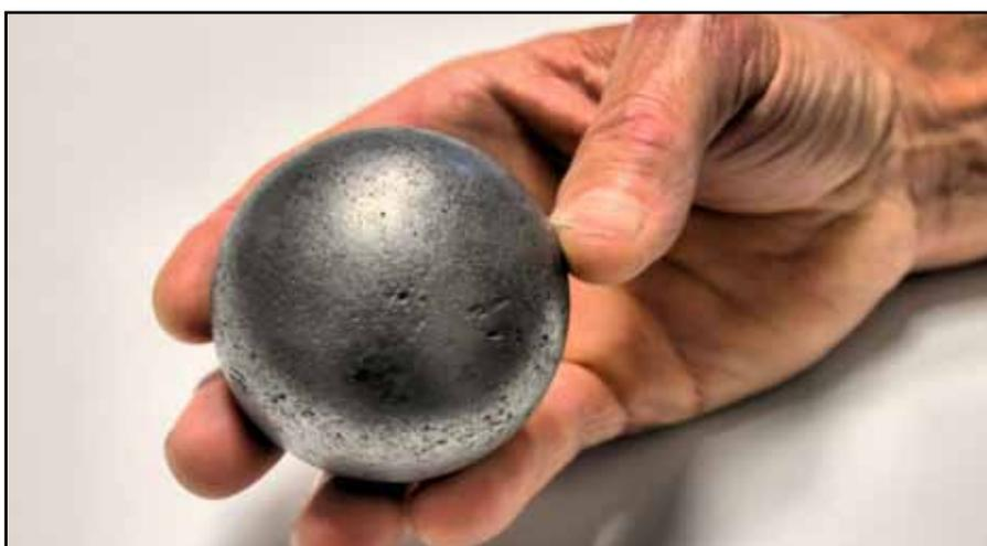
Im noch unbenutzten Zustand können die sechs Zentimeter im Durchmesser messenden Brennelementkugeln, wie hier ein Demomodell, gefahrlos mit der Hand berührt werden.
