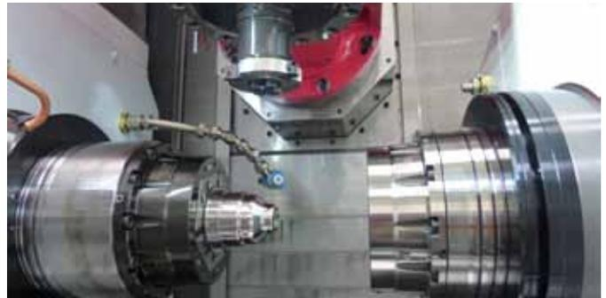
Das Spannfutter ›Toplus mini‹, jeweils angebracht auf der Haupt- und Gegenspindel der Mori Seiki-Maschine, ist in der Produktion von Werkzeug-Prototypen ein echter Gewinn für MAS.
