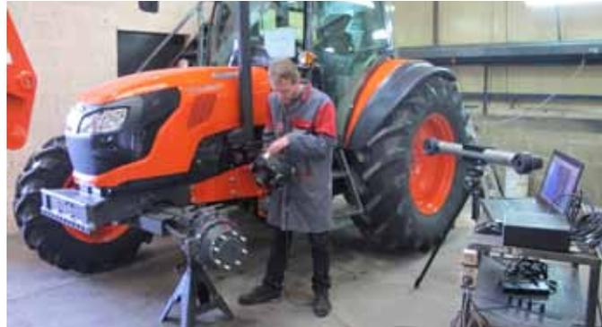
Technik von Creaform erlaubt rasches Vermessen von Traktoren.
