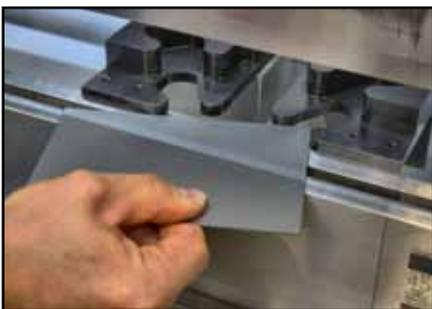
Die Ausformung der Anschläge erlaubt es, auch Schrägen problemlos abzukannten. Die Anschläge lassen sich einzeln ansteuern und positionieren.
