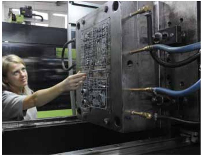
Die fertig gespritzte Karosserie des Mercedes SLS wird aus der Form entnommen und anschließend entgratet. Danach folgt eine erste Sichtkontrolle.
