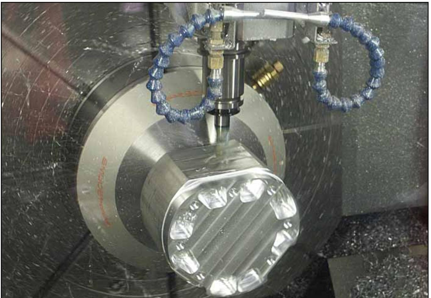
Bei ATS von Rother entsteht auch bei extremen Geschwindigkeiten kein Wandöl. In der Praxis bewähren sich die konstruktiven Feinheiten des Systems und die speziellen Mischungsverhältnisse.
