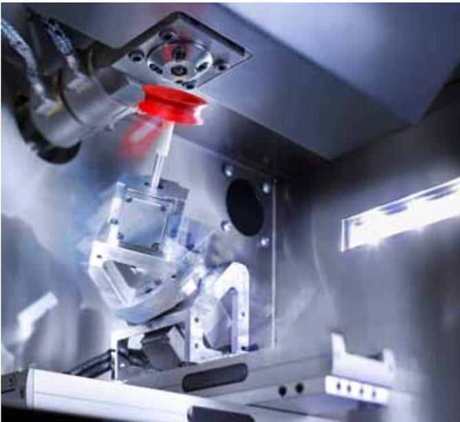
Beim Arburg-Kunststoff-Freiformen wird Standardgranulat aufgeschmolzen. Über eine Düse und einen beweglichen Bauteilträger entsteht das Teil schichtweise aus Kunststofftröpfchen.
