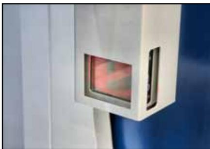
Das Sicherheitssystem ›BendGuard‹ stoppt den Biegevorgang, wenn sich Hindernisse, wie etwa die Finger des Bedieners, in der Gefahrenzone befinden.
