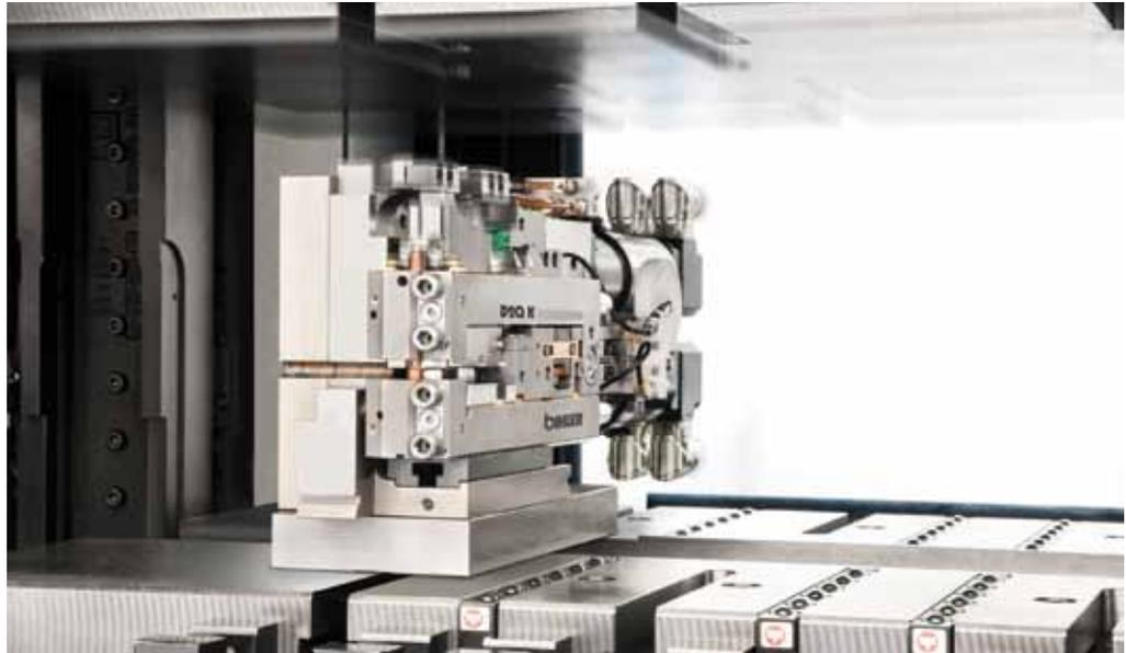
Das Kontaktschweißgerät ›Quickchange‹ mit NC-Ansteuerung ist in der Lage, Bewegungen unabhängig vom Pressenhub auszuführen und arbeitet mit der ›B 5000 NC‹ zusammen.
