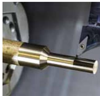
Erzeugung von hochpräzisen Spiegelglanzoberflächen. Je nach Cu-Werkstoff oder Bearbeitungsart erweisen sich PKD oder CVD-Diamant als Schneidstoffe der Wahl. Die unterschiedlichen PKD-Sorten mit individuell zu schleifenden Schneidengeometrien erfüllen dabei maßgeschneidert die jeweiligen Anforderungsprofile. Horn hat längst auf die Anforderungen der Bearbeiter von bleifreien Kupferlegierungen reagiert und bietet ihnen mit seinem Schneidstoffprogramm wirtschaftliche Lösungen.
