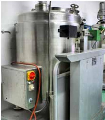
**Die Zutaten für die Produkte von Klever werden in großen Behältern zusammengemischt, die auf einer Waage stehen.**
