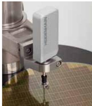
werden. Das Zusammenspiel von Kugelführung und photoelektrischer Abtastung ermöglicht eine Wiederholgenauigkeit, die kleiner als 0,03 µm ist. Im Gerät kommt eine Zerodur-Präzisionsteilung zum Einsatz. Zerodur hat im Bereich von 0 bis 50 Grad Celsius einen Ausdehnungskoeffizienten von annähernd 0 ppm/K. Der Metro 1281 MW misst also stets korrekt.
