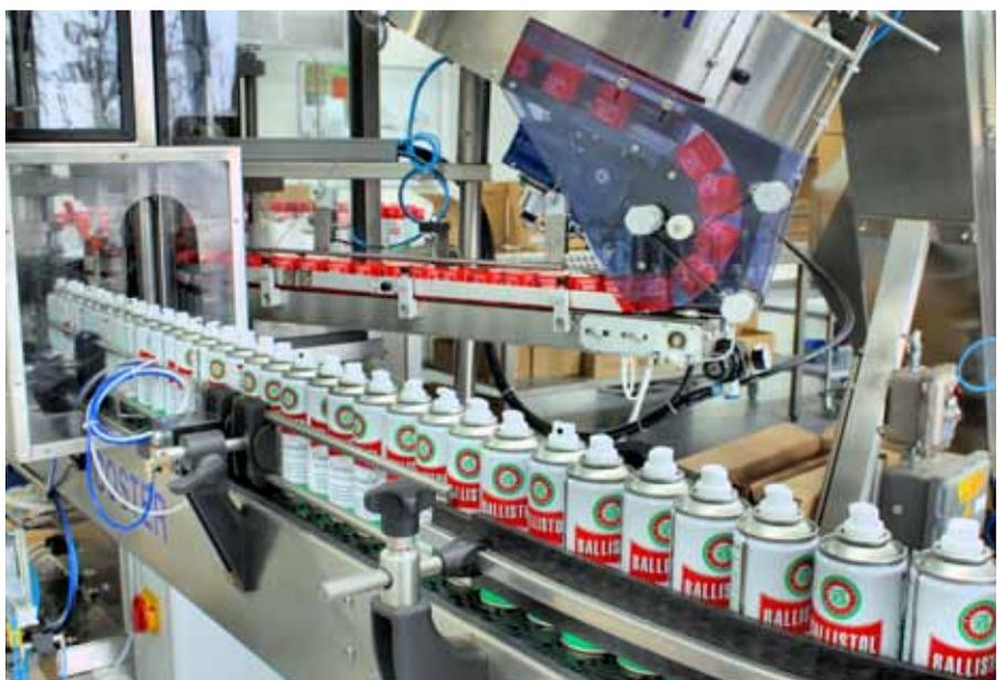
**Auf modernsten Abfüllanlagen wird jede Dose Ballistol exakt mit der nötigen Menge an Ballistol sowie Treibgas gefüllt und geprüft. Pro Jahr verlassen etwa 500 000 Liter Ballistol die Produktionsanlagen von Klever im bayerischen Aham.**
