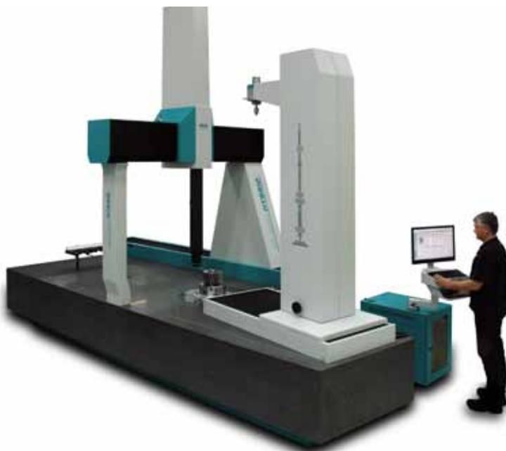
Die ›LH Hybrid‹ von Wenzel ermöglicht die Messung von Verzahnungen, Wellen, prismatischen Bauteilen und Oberflächenkenngrößen – ohne Umspannen der großen Bauteile.
