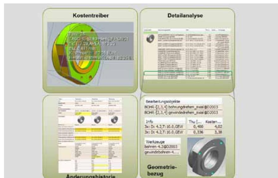
Mit ›Classmate Plan‹ von Simus werden Kosten transparent. Das Programm erzeugt übersichtliche Darstellungen der Kalkulation und Arbeitsschritte des Bauteiles.
