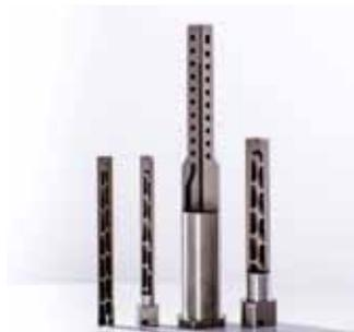
**Das Metall-Laserschmelzen sorgt in Kombination mit dem Drehen und Fräsen schwer zerspanbarer Materialien für entscheidende Mehrwerte durch einbaufertige Teile.**
