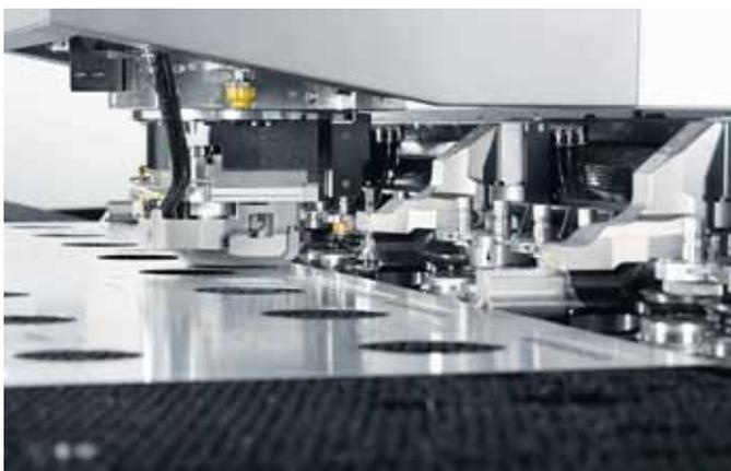
Dank rückziehbarer Pratzen lassen sich auch Teile im Pratzentotbereich ohne Nachsetzen bearbeiten.
