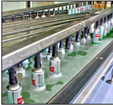
Die Dosen, in die Ballistol abgefüllt wird, sind bis 50 Grad Celsius zugelassen. Die Einhaltung dieser Eigenschaft wird in einem ebenso heißen Wasserbad geprüft.
