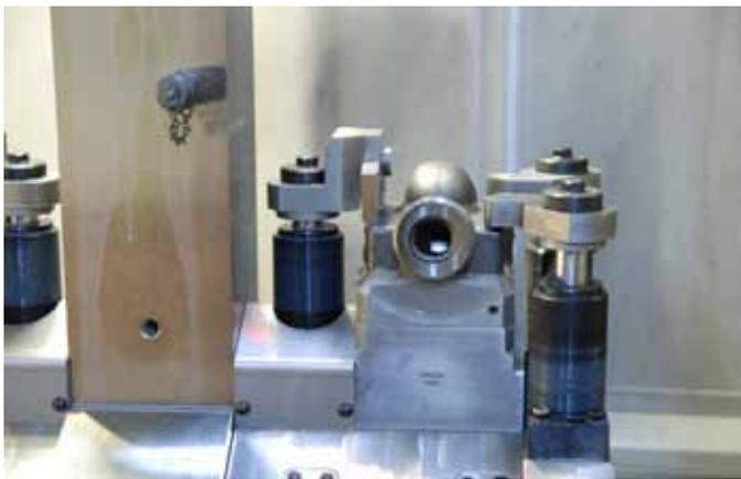
Hydraulisch betätigte Schwenkspanner spannen die Pumpengehäuse so, dass für Werkzeuge der benötigte Freiraum bleibt.
