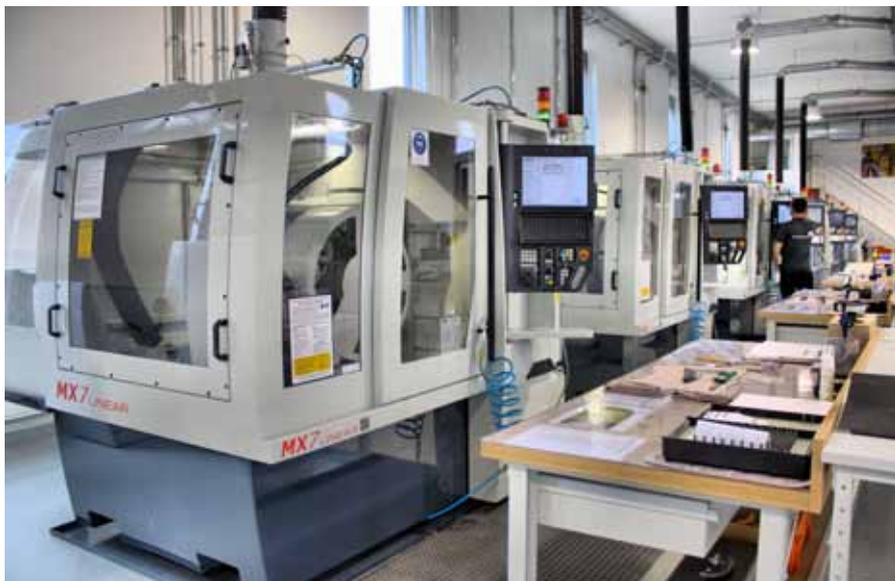
**Mehrere Werkzeugschleifmaschinen des Typs ›MX7 Linear‹ von Anca hat das Unternehmen Nachreiner in seiner Werkzeugschleiferei stehen.**
