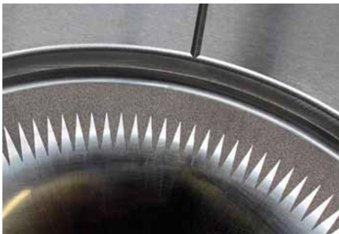
**Reichles digitaler Prozess des Lasertexturierens mit einem AgieCharmilles ›Laser 1000 5Ax‹ von GF Machining Solutions ist hochpräzise, prozesssicher und wiederholgenau.**
