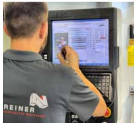
Für seine Schleifmaschinen hat Anca eine eigene Steuerung entwickelt, die in kurzer Zeit zum CNC-Schleifprogramm führt.
