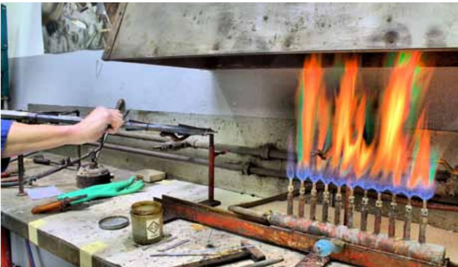
Das Weichlöten über der offenen Flamme wird dazu genutzt, mehrere Läufe fest zu verlöten. So entstehen Bockwaffen, also zweiläufige Waffen, aber auch „Drillinge“. Dieser Arbeitsgang erfordert Könner, damit die Läufe exakt zueinander fluchten.
