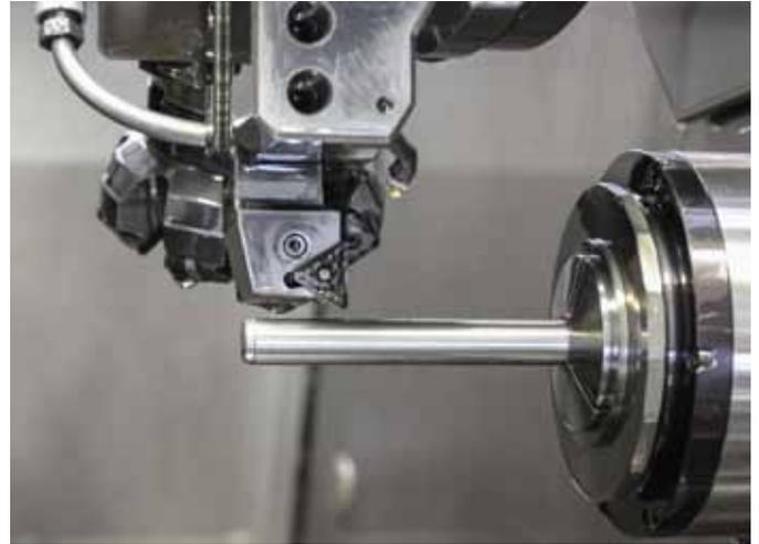
Beste Werkzeugmaschinen sorgen in der zerspanenden Produktion der Gewindebohrerrohlinge für eine gleichmäßige Qualität.
