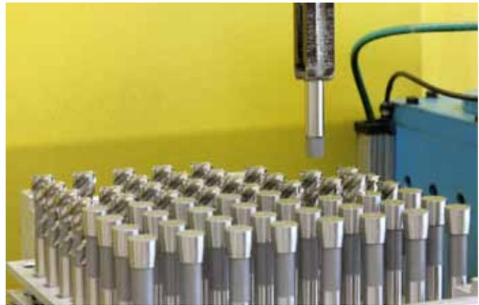
**Vollautomatisch per Roboter werden nach dem Härten die Schleifmaschinen mit den Rohlingen bestückt. Das Ergebnis sind präzise Gewindewerkzeuge höchster Qualität.**
