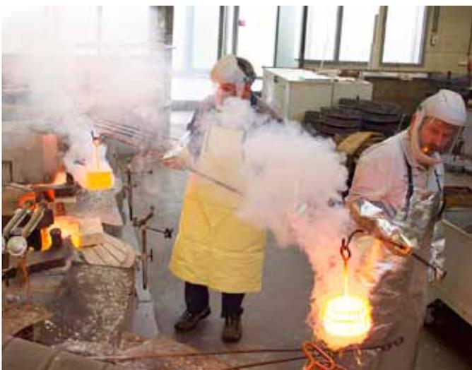
**Das Härten ist eine Spezialität von Bass. Hier sind mehrere Salzbadanlagen im Einsatz, die die Rohlinge stufenweise auf die Härtetemperatur von bis zu 1200 Grad Celsius erhitzen.**
