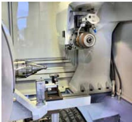
Ancas Spannsystem garantiert, dass Werkzeuge mit einer Toleranz von unter zwei Mikrometer schleifbar sind.
