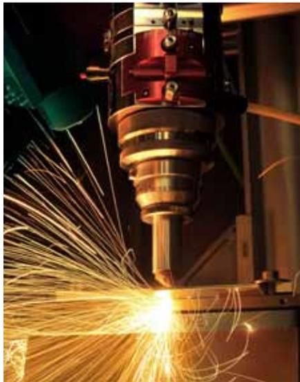
liegt unter anderem daran, dass die Laserstrahlung oft nicht die geeignete Form aufweist, die für die betreffende Anwendung das beste Bearbeitungsergebnis ermöglicht. Ein typischer Laserstrahl besitzt in seinem Zentrum eine sehr große Intensität, die zu den Seiten glockenförmig abfällt. Ein Laserstrahl mit einer solchen Gaußschen Intensitätsverteilung stellt nicht für jede Anwendung das optimale Werkzeug dar. Beispielsweise lässt sich ein Blech von 1 mm Dicke schnell und
