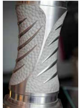
**Texturen können auch direkt in ein Prototypenteil eingebracht werden.**
