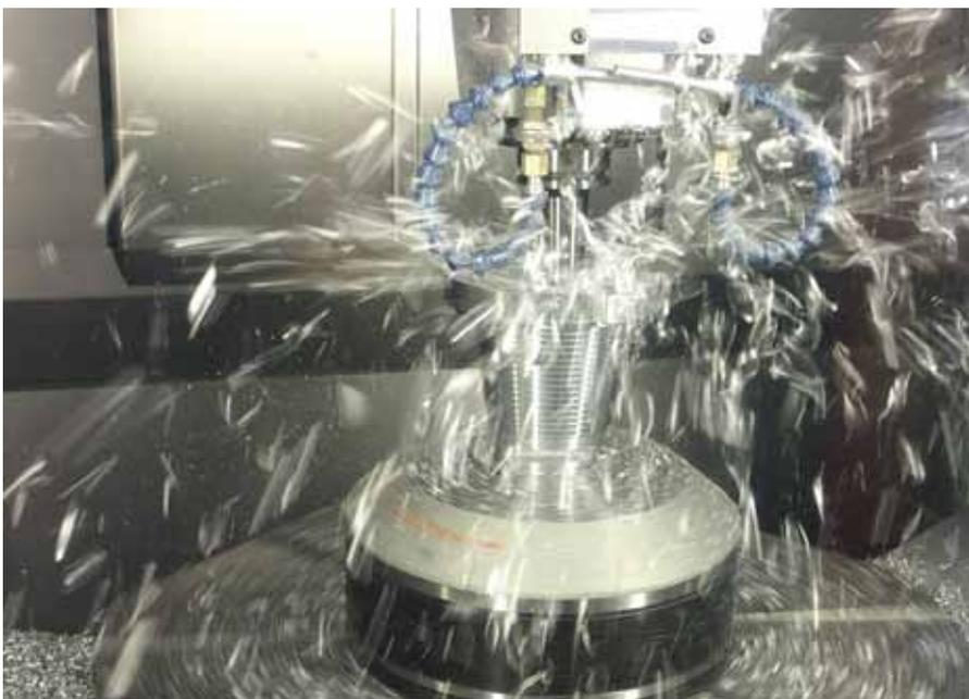
Rother's ATS-System erzeugt besonders feine Öltröpfchen. Durch deren große Oberfläche wird Hitze effektiv abgeleitet und die Arbeitsstelle perfekt geschmiert.
