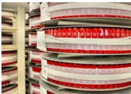
Zur automatisierten Weiterbearbeitung werden Griffschalen aus dem eigenen Kunststoffwerk auf einer Rolle geliefert.
