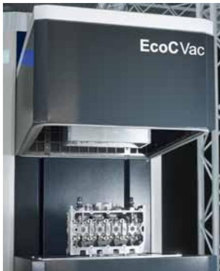
Verfahren wurde für die energiesparende Zwischenreinigung von Powertrain-Bauteilen wie beispielsweise Zylinderköpfen
