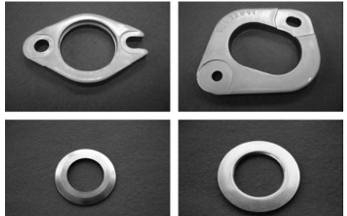
Die Kombination von Präzisionsschneiden und Blechmassivumformung erlaubt die Produktion hochkomplexer Teile.
