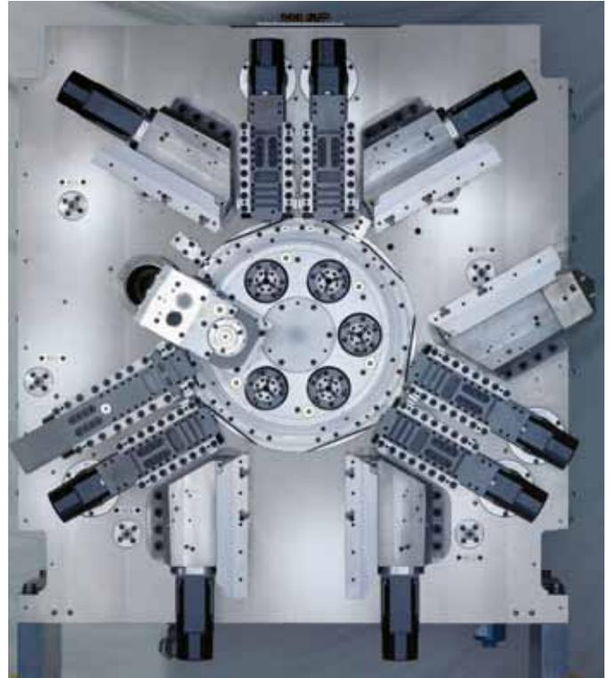
In der Anzahl der Stech-/Bohrschlitten und Kreuzschlitten ist die Maschine individuell konfigurierbar.
