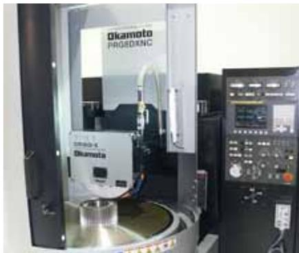
Ein neigbarer Rundtisch sowie spezielle Steuerungsfunktionen sind Goodies der PRG-DXNC-Rundtischschleifmaschine.
