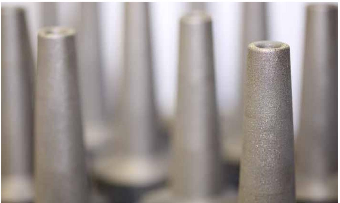
Loses Metallpulver wird beim SLM-Verfahren mittels eines Laserstrahls Schicht für Schicht an den Stellen aufgeschmolzen, an denen Material gewünscht ist. So entsteht der Funktionsbereich des HTCs mit schlanker Kontur.
