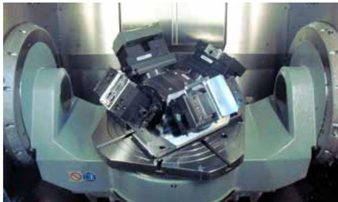
Ideal für die Mehrfachspannung auf Fünffachsmaschinen: Die ›Pyramide‹ von Gressel, die nun auch selbst gestaltbar ist.
