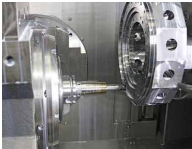
Der Index-Werkzeugrevolver muss hohe Ansprüche erfüllen. Er enthält unter anderem viele O-Ring-Sitze, die mit dem Duo-Lock-System von Haimer in höchster Qualität erzeugt werden.
