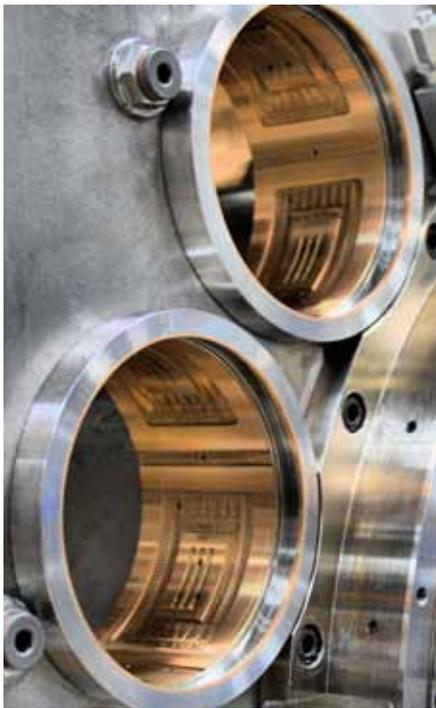
Die Pinolen der Mehrspindeldrehmaschinen sind hydrostatisch gelagert, was lebenslange Präzision verspricht.
