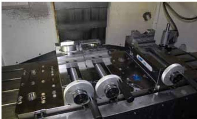
**Auf drei gredoc Wechsel-Grundplatten mit jeweils vier gredoc Nullpunkt-Spannstationen sind drei Einfach-Spanner vom Typ gripos montiert.**
