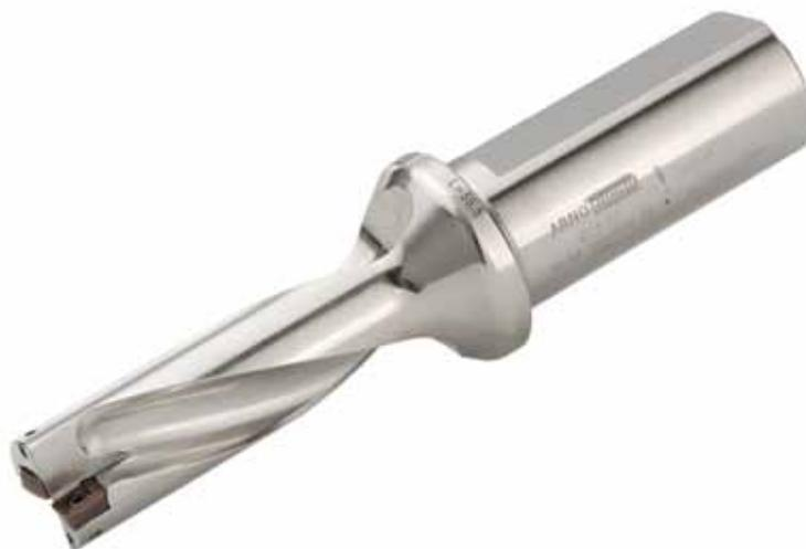
Der Kurzlochbohrer AKB von Arno überzeugt mit 14 bis 55 mm Durchmesser für Bohrungen bis 5 x D mit großem und optimiertem Auslauf der Spankammer bis zum Bund.
