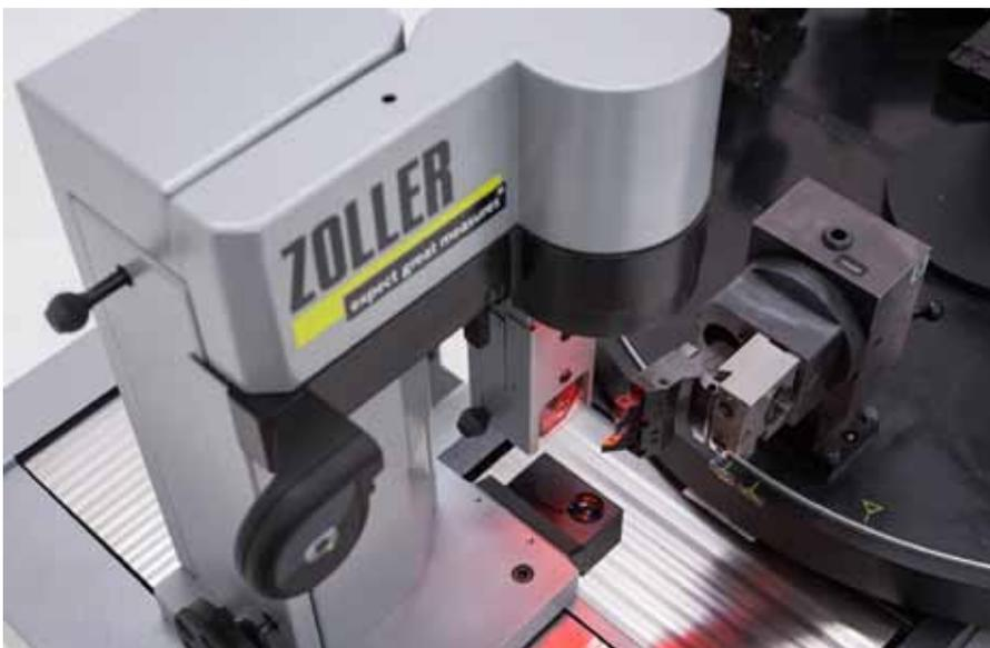
**Nur exakt eingestellte Drehwerkzeuge können exakte Bauteile fertigen. Mit dem Messgerät ›hyperion‹ von Zoller gelingt dies mühelos.**
