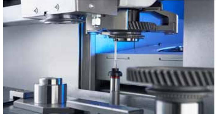
Ein integrierter Messtaster garantiert eine gleichbleibend hohe Bearbeitungsqualität.
