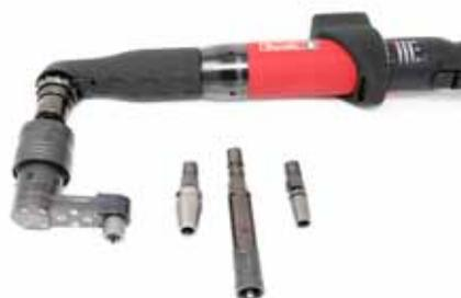
denen enge Winkel im Flugzeuginneren erreicht werden können. Im Flugzeugbau herrschen traditionell Druckluftwerkzeuge vor, unter anderem, weil von Elektrowerkzeugen Gefahren für Mitarbeiter ausgehen, wenn etwa die Elektrokabel an scharfen Kanten aufgeschlitzt werden.
