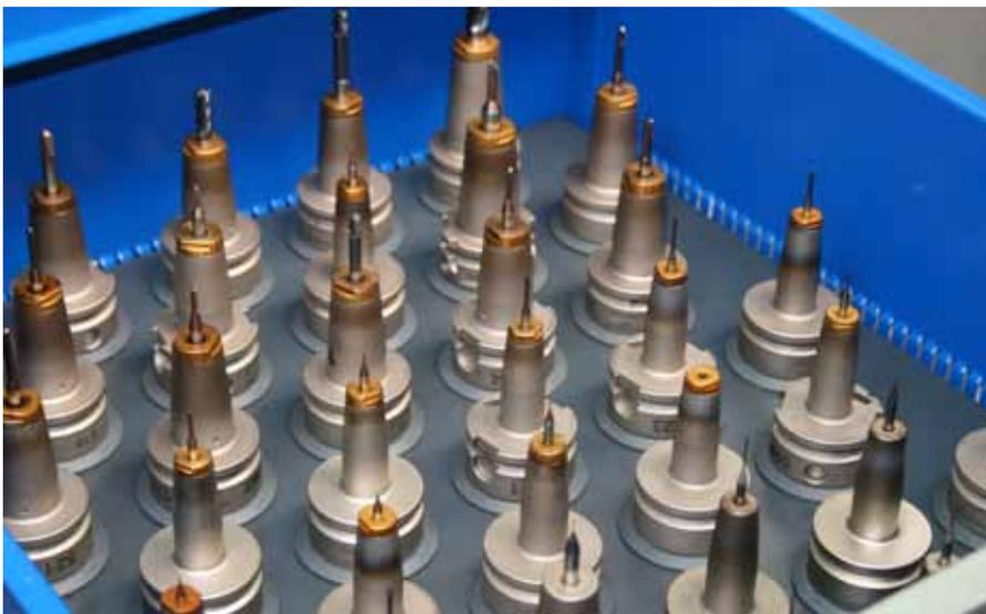
Auf mit Gewinde versehen Schrumpffutter lassen sich stirnseitig mit Bohrungen versehene, beschichtete Stahlkappen aufschrauben. Diese Kombination wurde von Diebold ›Jetsleeve 2.0‹ getauft.
