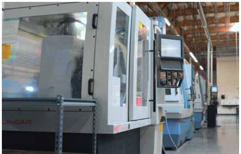
AB Tools setzt zur der Herstellung der Zerspanwerkzeuge sechs CNC-Schleifmaschinen von Anca ein. Mit der »MX7 Linear« werden beste Oberflächengüten erreicht.
