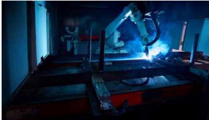
**Robotergestützte Prozesse sorgen bei der mobilen Kassettenfertigung für eine konstant hohe und zertifizierte Qualität.**
