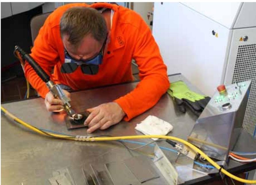
Durch die sehr geringe Wärmeeinbringung in das Werkstück ist es problemlos möglich, die zu verschweißenden Teile ohne Einsatz besonderer Schweißerhandschuhe sicher von Hand zu fixieren.
