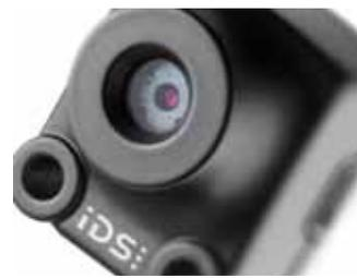
sen hervorragende Bilder.« Im JPEG-Modus generiert das Modell 15 Bilder pro Sekunde; in reduzierter Auflösung sind bis zu 30 fps realisierbar. Zusätzlich stehen acht frei wähl- und einfach umschaltbare Bildformate von VGA bis 5 MP zur Verfügung. In Verbindung mit der JPEG-Kompression bietet sich die Mini-Kamera außerdem für Videostreaming mit 720p (HD-ready) oder 1080p (Full HD) an. Damit ist sie vielseitig nutzbar, etwa in der Medizin- oder Sicherheitstechnik.
