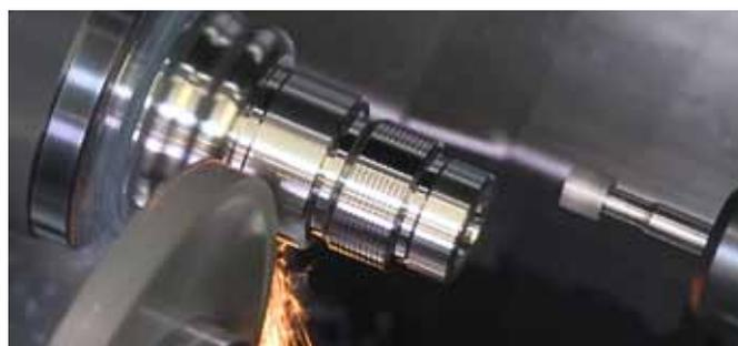
**Die ›202 TG‹ von Schaublin bietet Drehen und Schleifen auf einer Maschine, ohne das Bauteil umzuspannen.**
