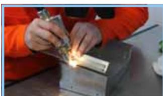
Der ›Penwelder‹ nutzt Laserstrahlen zum Verschweißen von Blech. 90
