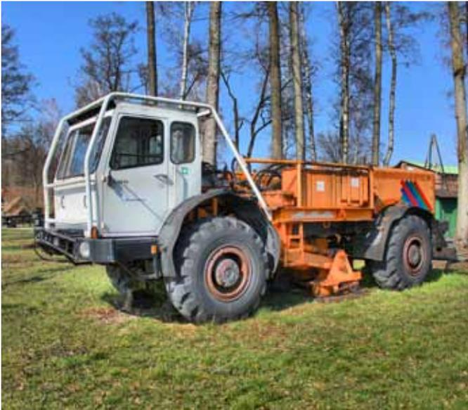
Zur Erdölsuche werden Vibrator-Fahrzeug verwendet, die Schallwellen erzeugen und diese in den Untergrund einleiten.
