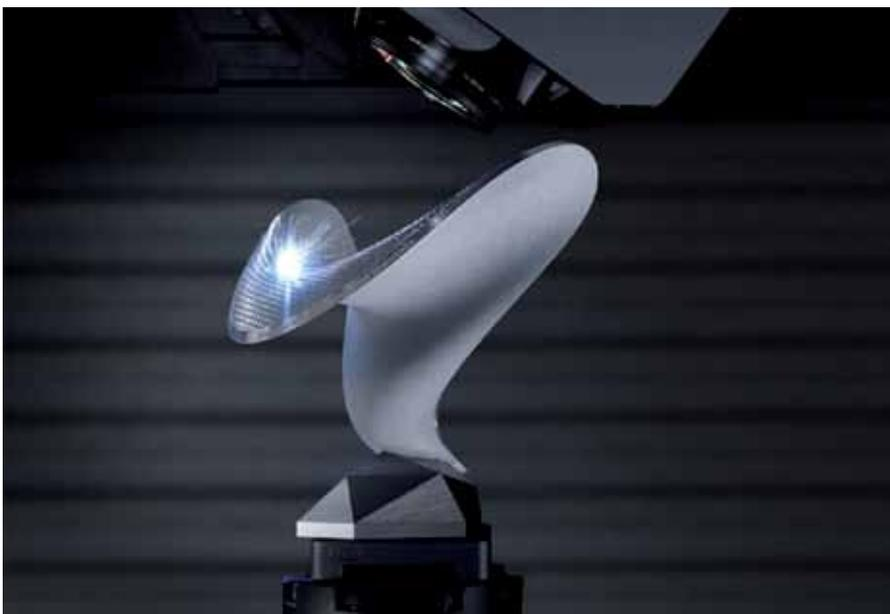
Die Präzision und das Hochgeschwindigkeits-3D-Scansystem der ›Laser S 1000 U‹ ermöglichten es, der Oberfläche des Teils exakt mit dem Laserfokus zu folgen.
