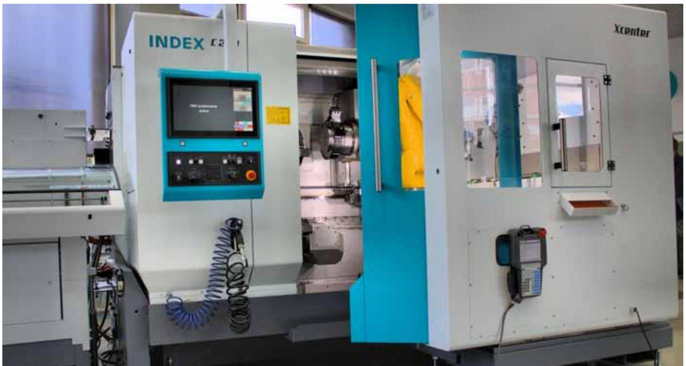
Die Baureihen ›C100‹ beziehungsweise ›C200‹ sind von Index ursprünglich für die Produktion von Stangendrehteilen entwickelt worden. Die optional adaptierbare Roboterzelle ›iXcenter‹ erlaubt deren vollautomatische Fertigung sowie Kontrolle, aber auch die Zuführung von Rohlingen für Werkstücke, die nicht ab Stange gefertigt werden.
