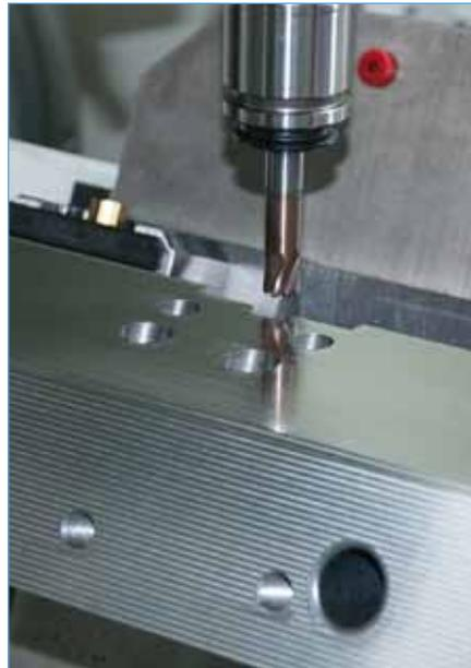
Im Werkzeugbau von Harting wurde das Schleifen durch Hartfräsen abgelöst. Um die Prozesssicherheit zu erhöhen, wurden gemeinsam mit MMC Hitachi Tool die Fräsprozesse analysiert und optimiert.
