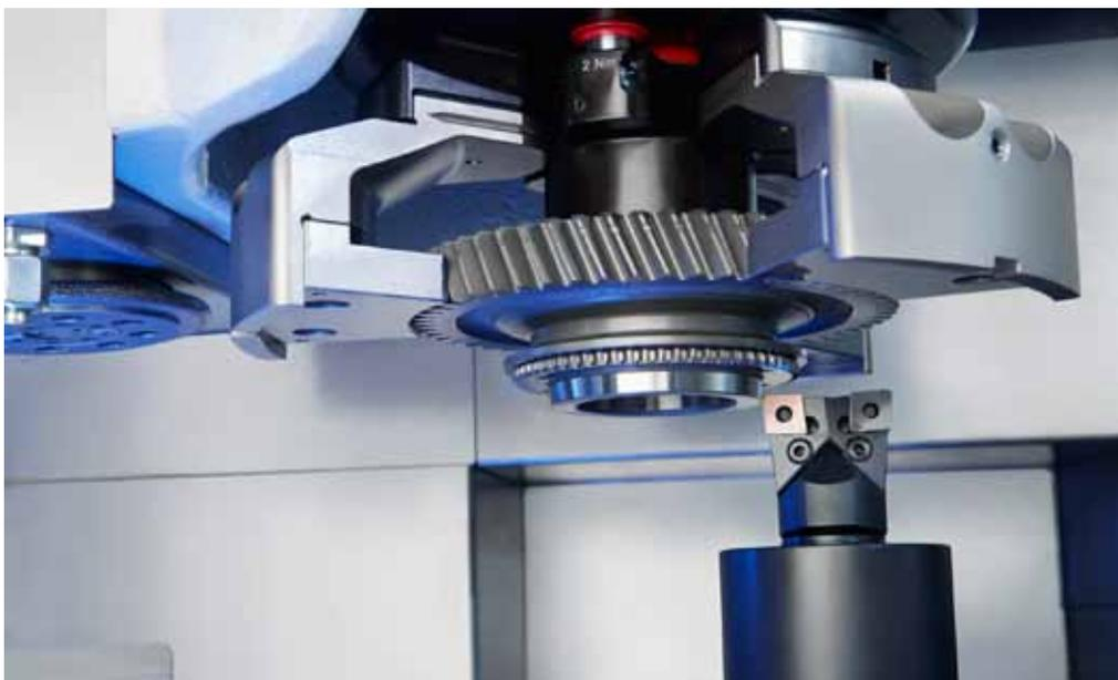
Die leistungsstarke Arbeitsspindel der ›VLC 200 GT‹ von Emag besitzt eine Leistung von 22 kW, was rasante Hartdrehoperationen ermöglicht.
