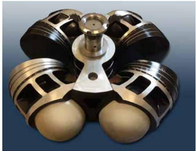
Tennisballgroße Kugeln, die in einer gewundenen Kugelbahn geführt werden, übertragen die Atmungsbewegungen der beiden Twinkolben.
