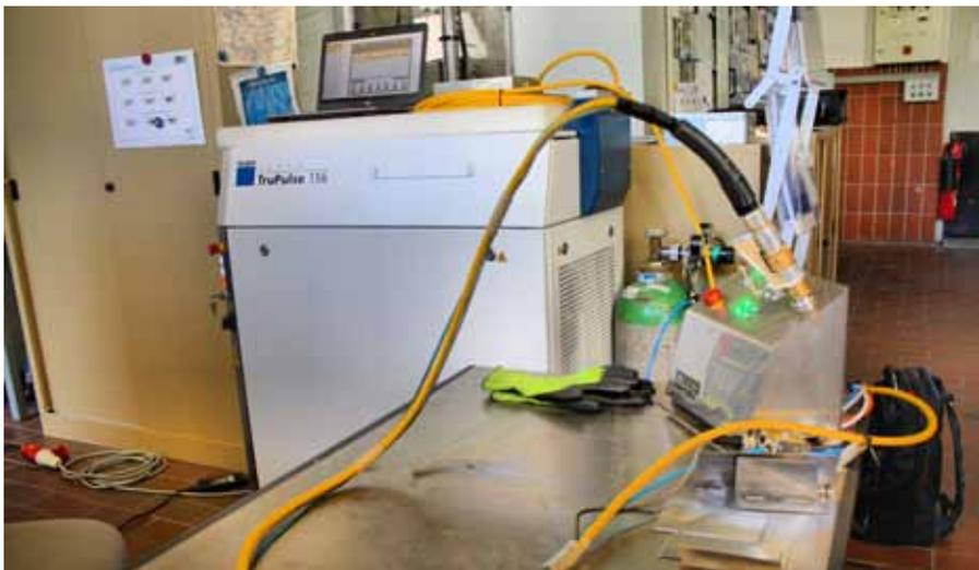
Lediglich eine externe Laserquelle ist nötig, um den Penwelder in Betrieb zu nehmen. Das Lichtleiterkabel ist sehr flexibel und stört beim Schweißen nicht.
