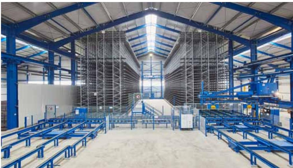
Ein Unicompact-Lager kurz vor der Fertigstellung: Kasto bietet beim Bau der Lagersysteme eine mobile Kassettenfertigung vor Ort an.
