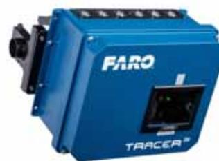
beachten. Es müssen keine Reflektoren, die das Licht zur ursprünglichen Quelle zurück reflektieren, mehr am oder um das Objekt oder die Baugruppe herum platziert werden. Dadurch wird die für die Einrichtung benötigte Zeit erheblich verringert.
