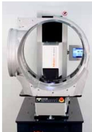
den Einsatz von Beladesystemen wie etwa Robotern oder Palettierung mit hohem Prüfdurchsatz. Für den Fall, dass später Serienmessungen oder Jominy-Tests durchgeführt werden sollen, lässt sich das manuelle Modell nachträglich mit einem Kreuztisch ausrüsten.
