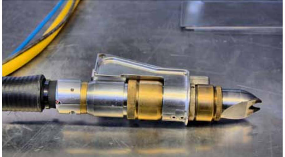
Der ›Penwelder‹ der Blue Lasertools GmbH ist ein kompaktes Schweißwerkzeug, das den Laser zum Schmelzen des Materials nutzt.
