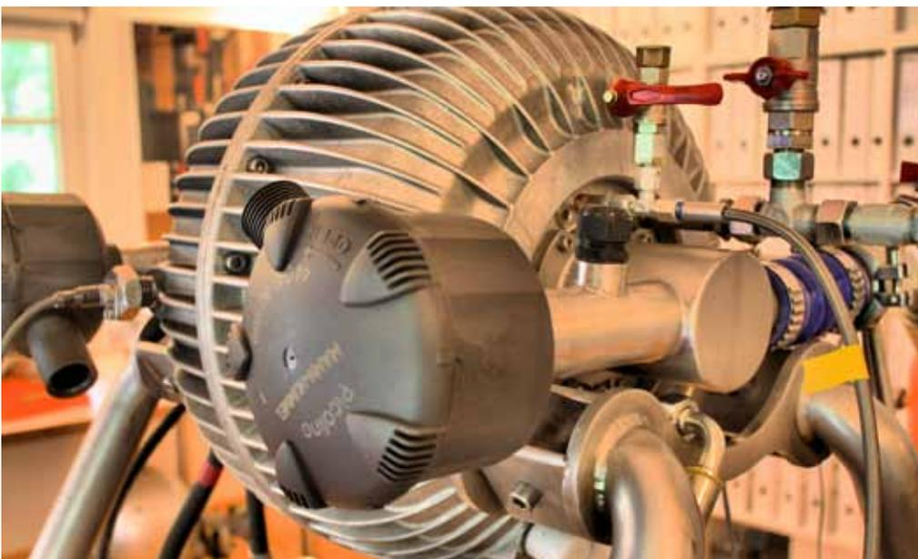
Da wenige Bauteile zu montieren sind, ist ein Fachmann weniger als eine Stunde damit beschäftigt, einen Kugelkompressor mit 1,2 Liter Hubraum betriebsfertig zu montieren.
