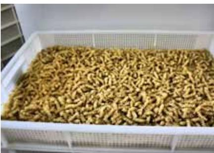
Nach der Formung muss aus den Nudeln das Wasser entfernt werden. Das geschieht im Trockenraum mit einem speziellen Entfeuchter und Ventilatoren.
