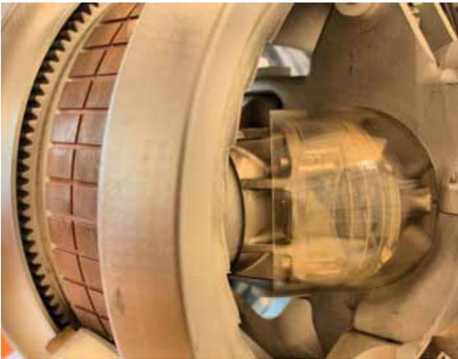
Ein ringförmig angeordneter Magnetrotor ermöglicht über das sinusförmig gestaltete Kurvenglied und über Kolbenführungskugeln die Atmungsbewegung der beiden Twinkolben.
