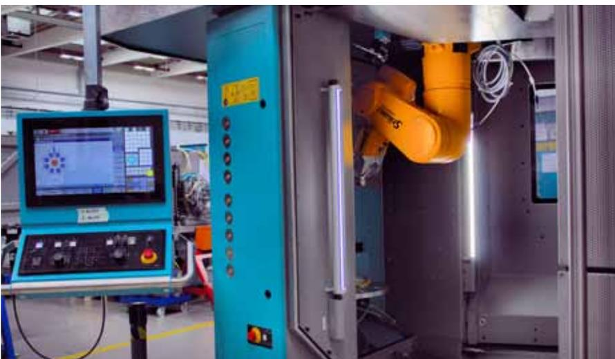
**Die Zu- und Abführung der Teile hat Index bei seinen Mehrspindelmaschinen über einen im Maschinenraum platzierten Sechssachs-Roboter sowie einen Schwenkteller gelöst.**
