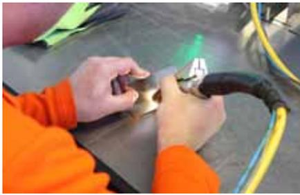
Der Schweißvorgang startet, wenn die Spitze das Werkstück berührt sowie Hand- und Fußschalter betätigt sind.
