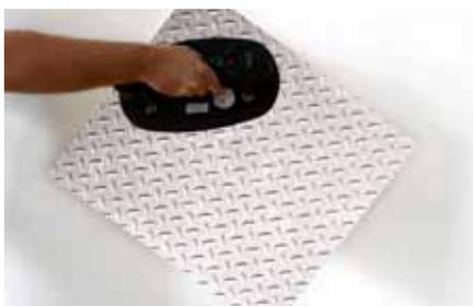
zu transportieren. Hierbei spielt es keine Rolle, ob es sich um glatte oder strukturierte Oberflächen handelt, der Handsauger kommt mit nahezu allen Oberflächen klar. In allen Branchen, bei denen schweres Heben an der Tagesordnung steht, minimiert dieses Tool das Risiko der Beschädigung teurer Materialien und maximiert die Produktivität.
