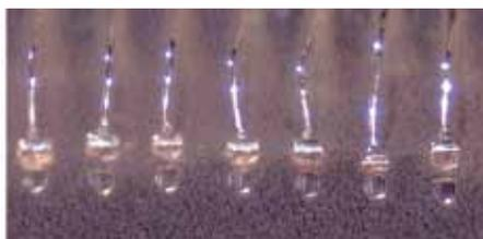
**Ballscherfestigkeit auf unbehandelter (links) und plasmavorbehandelter (rechts) Enepig-Oberfläche.**
