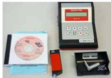
Dieses zum Retrofitting eingereichte ältere DH-6-Gerät soll durch Austausch der Elektronik auf den aktuellen Stand der Technik gebracht werden.
