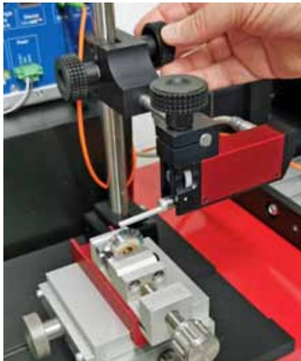
Im Messlabor: Fest eingespannte Vorschubeinheit mit Freitaster für Konturmessung an einer Schneide.
