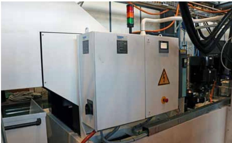
Die von Knoll gelieferte Kühlschmierstoffanlage wurde bedarfsgerecht an das Fünfachs-Schleifzenter »MFP 30« von Mägerle angepasst.
