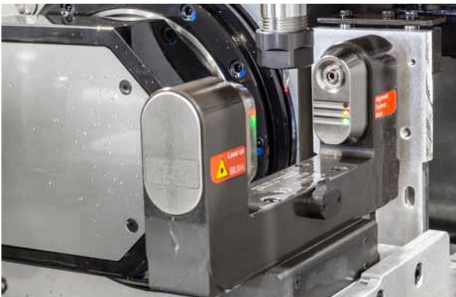
Selbst kleinste Werkzeuge mit einem Durchmesser von 15 hundertstel Millimeter vermisst das Lasermesssystem ›LC50-Digilog‹ von Blum Novotest zuverlässig.
