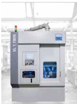
Werkstücke bis 75 mm Durchmesser können mit der VL 1 Twin bearbeitet werden.
