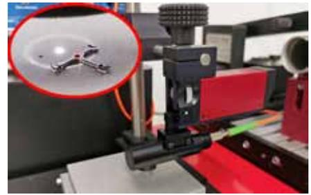
Die optische Messeinheit am Vorschubgerät kann selbst sehr kleine Teile ohne Fixierung berührungslos abtasten.
