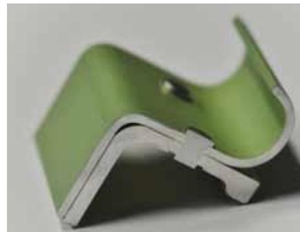
Der Schnitt durch den Niet zeigt die fertige Vollstanzniet-Verbindung einer Stringer-Kupplung.
