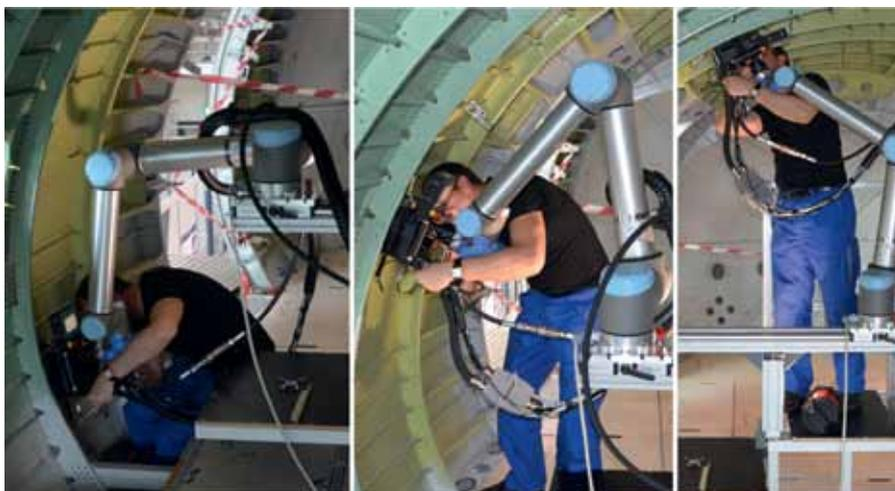
Montage einer Stringer-Kupplung mithilfe eines kollaborativen Roboters im Flugzeugrumpf.
