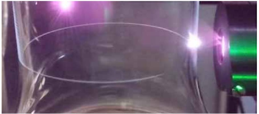
Coherent HyperRapid NX beim Filamentschneiden eines Weinglases.
