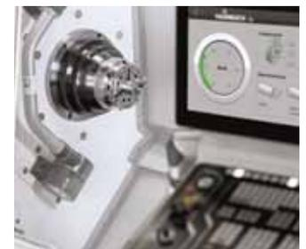
Dank der integrierten Sensorik sind viele verschiedene Messungen und Überwachungen möglich. Über berührungslose Daten- und Energieübertragung werden die Messdaten direkt an die Maschinensteuerung geleitet und ausgewertet. Die Steuerung führt einen Sollwert-Abgleich durch. Wenn es zu unzulässigen Abweichungen kommt, wird eine Meldung ausgegeben oder eine Korrektur in die Wege geleitet.
