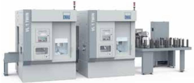
Es ist möglich, zwei VL 1 TWIN mit einer Roboterzelle oder alternativ mit dem TrackMotion-Automationsystem zu beladen.
