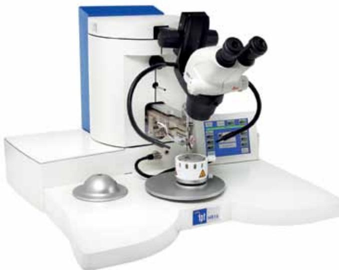
Zur Untersuchung, ob durch eine Plasmabehandlung eine stärkere Verbindung zwischen Bondpads und Kontaktpunkten des Drahts entsteht, wurden 60 Bondverbindungen auf eine unbehandelte sowie auf eine plasmabehandelte Testleiterplatte mit dem TPT HB16 Wedge & Ball Bonder aufgebracht.
