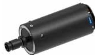
matisierten Betrieb möglich. Das flexible Roboterwerkzeug ahmt den manuellen Entgratprozess nach, allerdings immer in gleichbleibend hoher Qualität. Lageungenauigkeiten, Werkstücktoleranzen und Toleranzen des Roboters werden axial um bis zu acht Millimeter und radial um bis zu  $\pm 5,5$  Grad ausgeglichen. Die Ausgleichskraft lässt sich individuell regeln (axial 13-66 N, radial 13-62 N). Damit gewährleistet das Werkzeug prozesssichere Entgratergebnisse bei nur minimalem Programmieraufwand.
