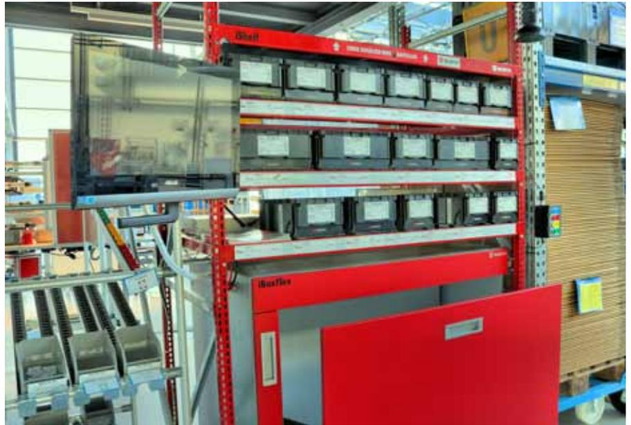
Sind Kästen mit einem RFID-Chip versehen, so können Lösungen verwendet werden, die automatisch erkennen, ob ein Behälter im Schubladen oder einem anderen Lagerplatz abgelegt wurde.
