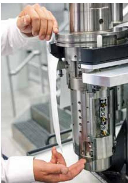
Die Rundlaufabweichung des Werkzeugs darf bei einer Länge von 380 mm nicht mehr als 3  $\mu$ m betragen.
