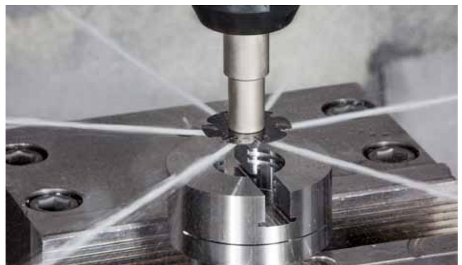
Den Schlitzfräser Slim Slit gibt es mit Schneidenbreiten von 0,8 bis 1,2 Millimeter. Die innere Kühlmittelzufuhr wirkt direkt in der Schnittzone.
