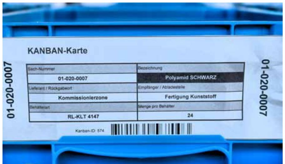
Die Kanban-Karte ist der Dreh- und Angelpunkt eines ohne EDV-Einsatz funktionierenden Beschaffungssystems. Kanban ersetzt eine terminorientierte Auftragsbearbeitung durch eine bedarfsorientierte Auftragsbearbeitung.
