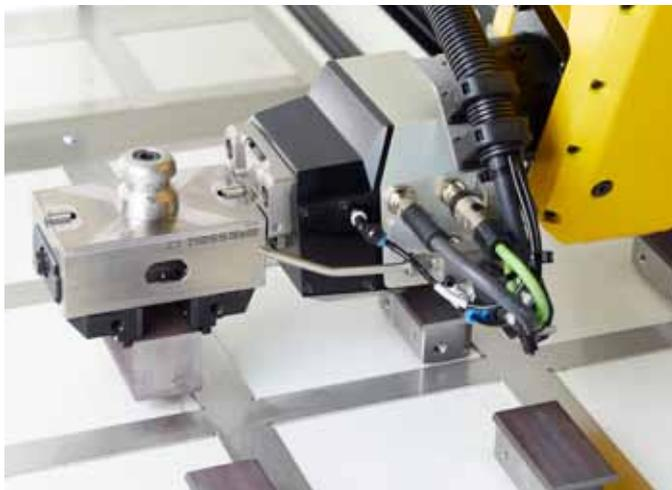
Das Roboter-Spannmodul ›R-C2‹ von Gressel kann Werkstücke greifen, spannen, transportieren und bearbeiten.
