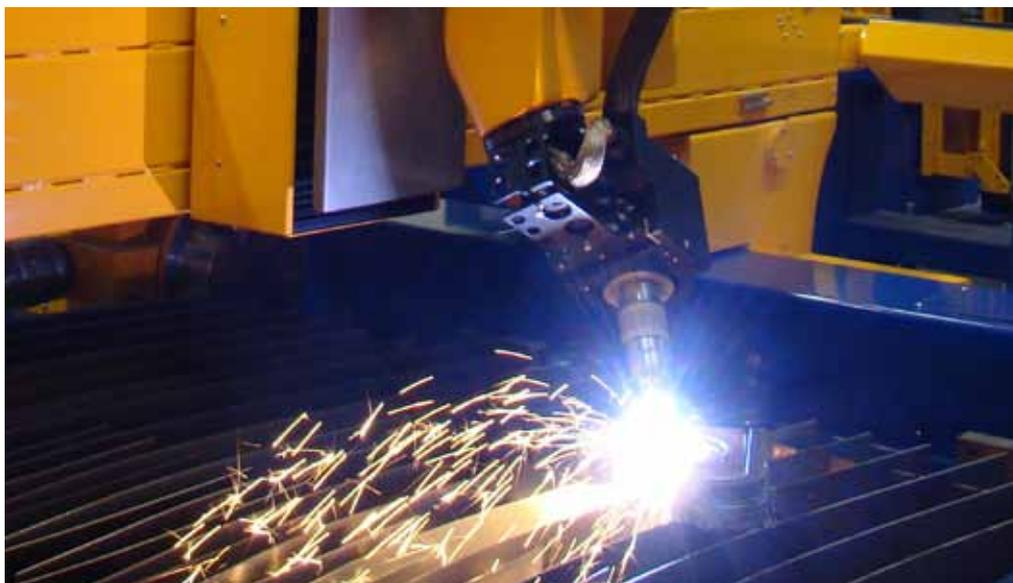
Mit dem endlosdrehenden Rotator können V-, Y-, und unter bestimmten Bedingungen sogar X- und K-Fasen nachträglich angearbeitet werden.
