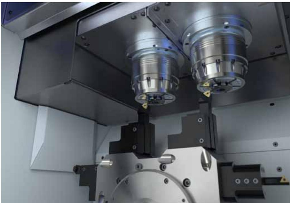
Bei den VL 1 Twin-Maschinen von Emag werden die Arbeitsspindeln für die Bearbeitung der Werkstücke sowie für deren Be- und Entladung verwendet. Dies spart Platz und unnötige Peripherie.
