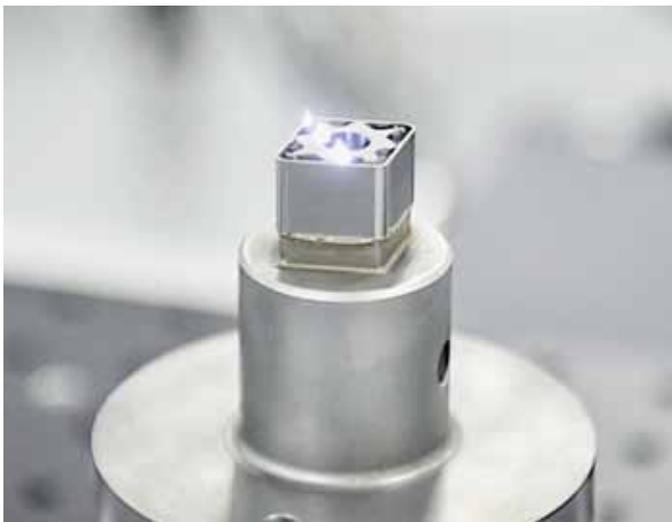
Der Femtosekundenlaser sendet Lichtpulse aus, deren Dauer im Femtosekunden-Bereich liegt. Seine Leistung beträgt 20 W. Beim Laser-Abtragen wird kaum Wärme in das Werkstück eingebracht.
