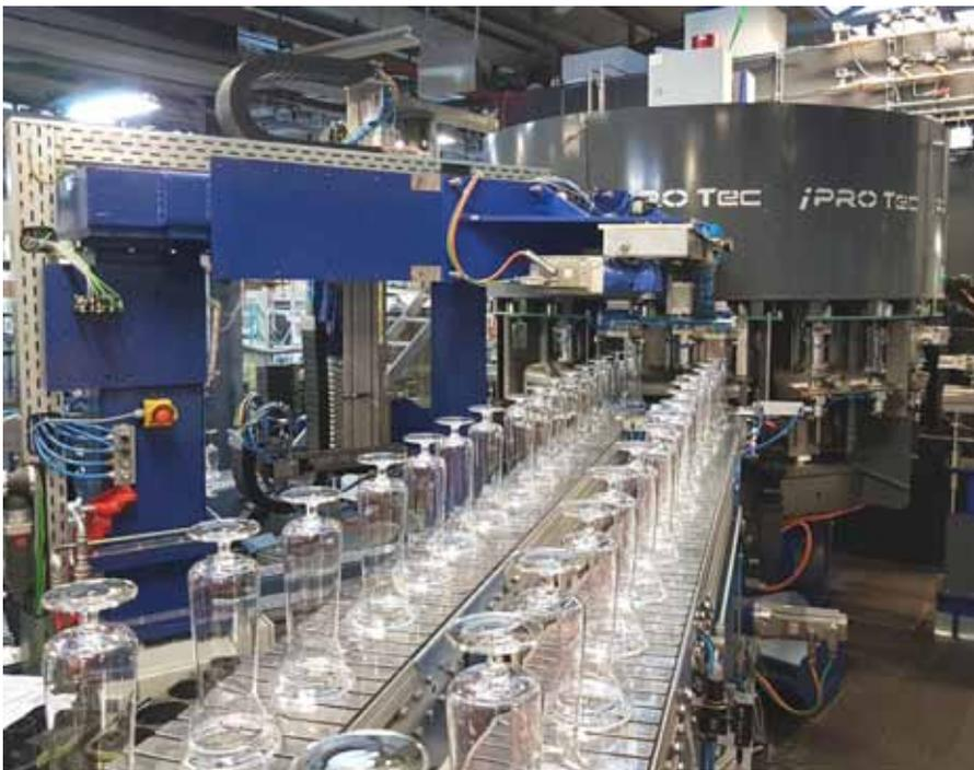
Das iPROTEC-System ist eine vollautomatische Anlage zum Entfernen von Weinglaskappen mit SmartCleave bei einem Ausstoß von bis zu 80 Stück/Minute.
