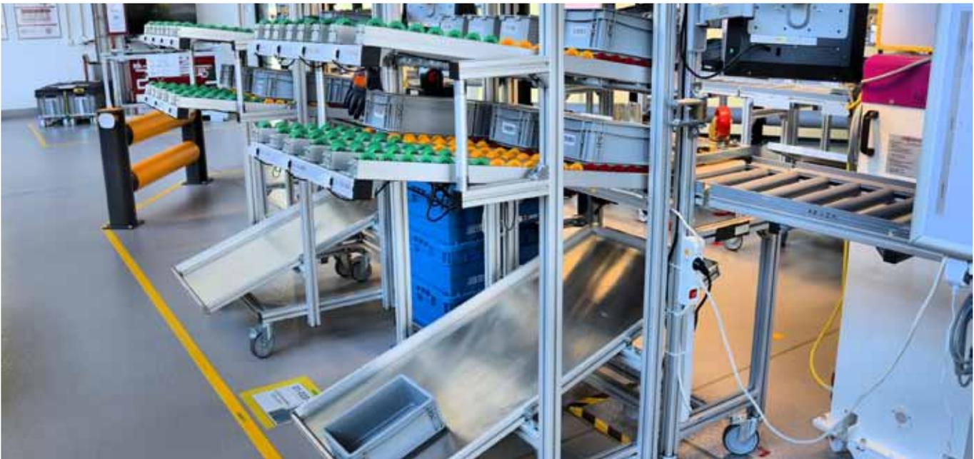
Die Idee von Kanban ist, die Produktion von Teilen solange aus Behältnissen durchzuführen, bis diese leer sind. Anschließend werden sie in eine Ablage gelegt, von wo diese zur Wiederbefüllung entnommen werden.
