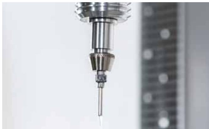
**Die Maschine trägt bei der Fertigung von unterschiedlichen Klimafiltern für Lkw dosiert Dichtungsmasse auf.**
