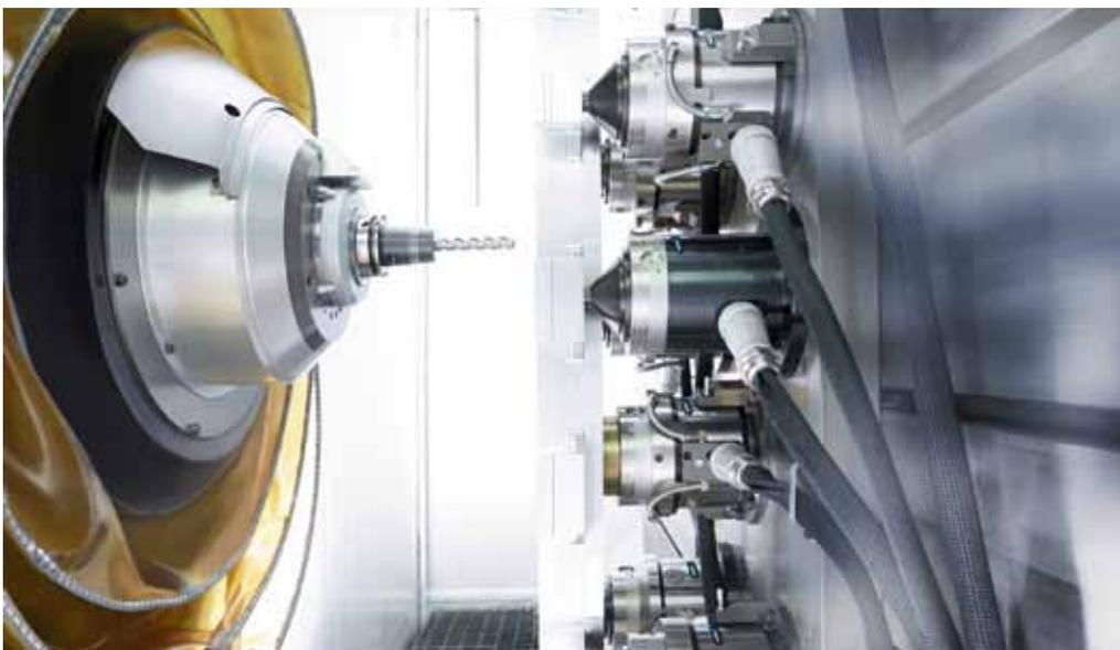
**Schunk Vero-S Aviation ermöglicht eine deformationsfreie Direktspannung von Strukturbauteilen in der Luftfahrtindustrie.**
