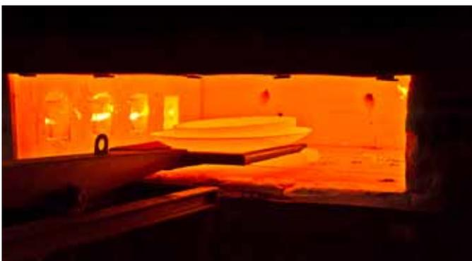
AM-Lock-Paletten sind bis 650 Grad Celsius wärmebeständig. So können gedruckte Teile direkt in den Glühofen.
