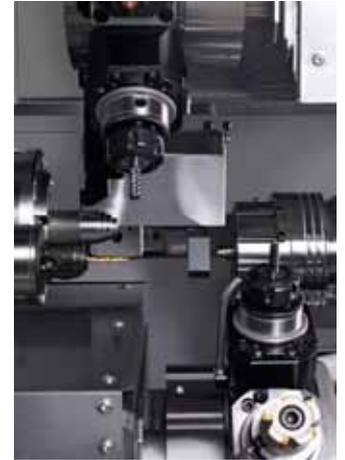
CNC-programmiert lassen sich die Fertigteile hauptzeitparallel aus der Maschine abführen.
