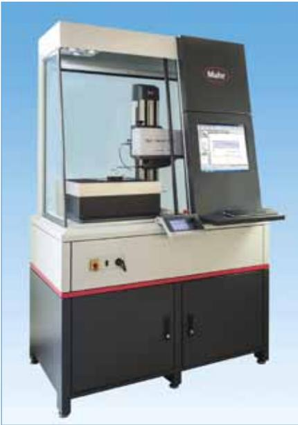
Mit dem »MarSurf CNC modular« bietet Mahr durch die Kombination eines Standard-Messplatzes mit standardisierten Komponenten einen Messplatz zur Kontur- und Rauheitsmessung.
