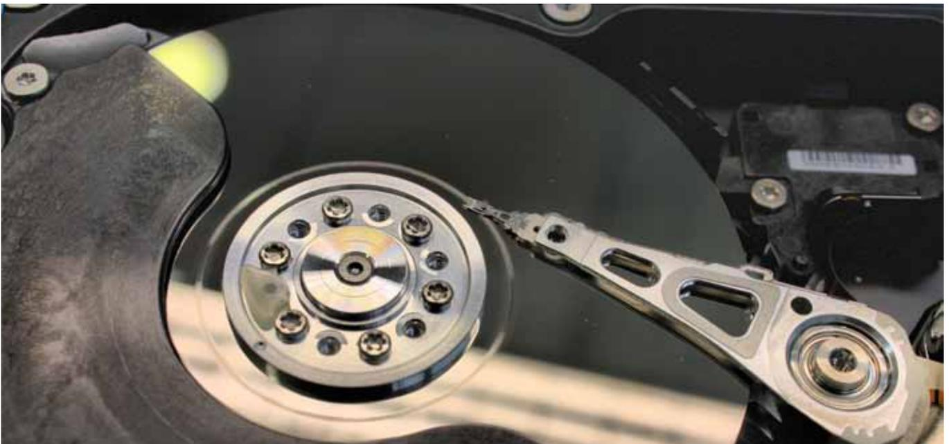
Bei einem Head-Crash entscheidet die Art der Zerstörung, wie viele Daten noch gerettet werden können. Die hier gezeigte ringförmige Zerstörung begrenzt den nicht mehr rettbarer Bereich auf ein Minimum. Der größte Teil der Platte ist unzerstört. Dort abgelegte Daten können problemlos ausgelesen werden, was für die Experten von Ontrack tägliche Routine ist.
