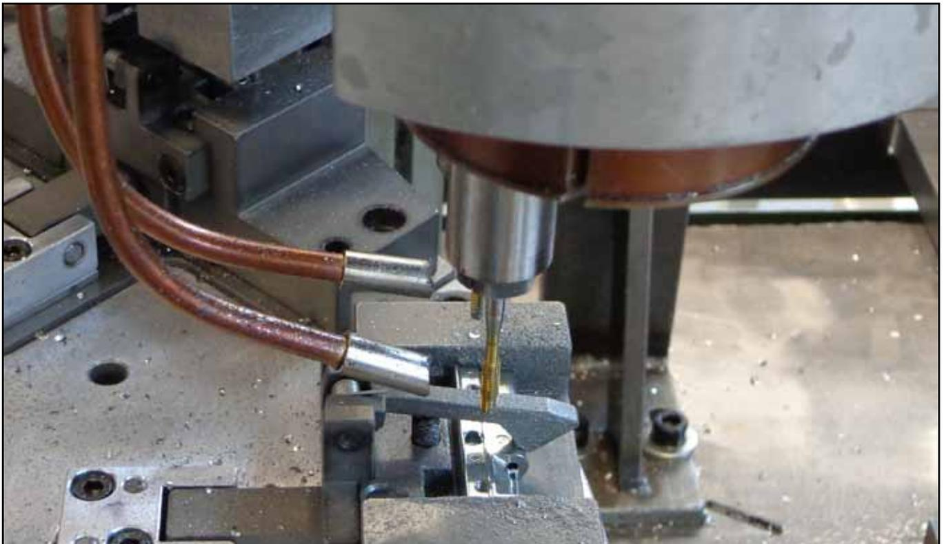
Ein Doppelspindler beim Gewindeformen von M3- und M4-Gewinden. Durch die optimale Kombination von Gewindeformer und Schmiermittel konnte mittels der Minimalmengenschmierung die Standzeit von 20 000 auf 180 000 Gewinde gesteigert werden.
