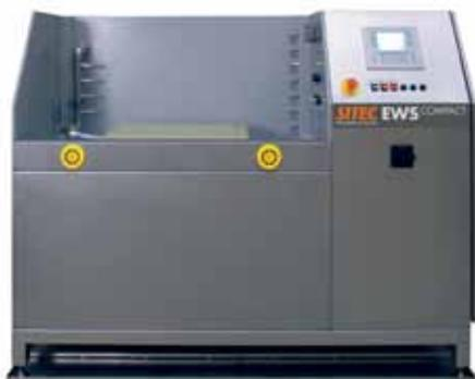
**»EWScompact« ist ein Einstiegsmodell zum Entgraten und Bohren mittels elektrochemischer Metallbearbeitung (ECM).**
