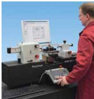
terlegt und nicht mehr im PC. Zum produktiven Arbeiten sind häufig genutzte Funktionen von Maus und Tastatur auf das Handbedienfeld gelegt worden. Die Innengewindemessung wird unterstützt durch eine automatische Z-Positionierung für die jeweilige Gewindesteigung. Somit werden Messfehler durch den Bediener minimiert, Kalibrierzeiten reduziert und die Prozesskosten optimiert.
