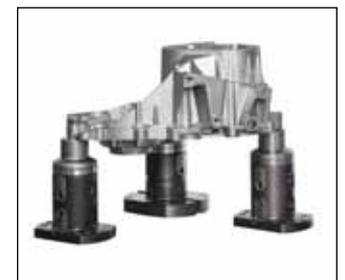
Werkstücke sind montierbar. Das Spannsystem wird manuell, ohne Medienzufuhr betätigt und kann sehr schnell auf andere Werkstücke oder Vorrichtungen umgerüstet werden. Die Montage erfolgt denkbar einfach: Basismodul platzieren, Aufbauspannmodule aufstecken, Reduktionsadapter mit angeschraubtem Werkstück aufsetzen und dann mit einem Drehmoment-Schlüssel manuell festschrauben.
