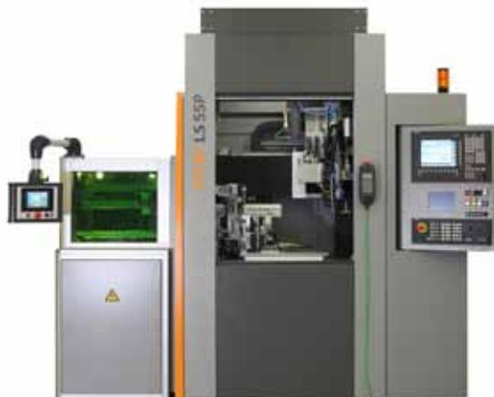
**Die Laserbearbeitungsmaschine »LS55P« von Sitec eignet sich zum Laserschweißen komplexer Bauteilgeometrien.**
