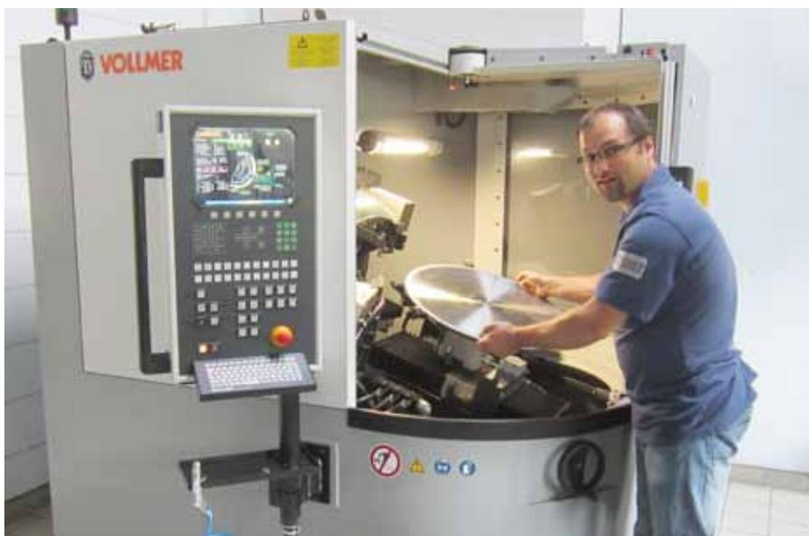
Schleifmaschinen von Vollmer laufen mit Sintogrand von Oelheld zur Hochform auf. Das Schleiföl sorgt dafür, dass die Schleifscheiben griffig bleiben.
