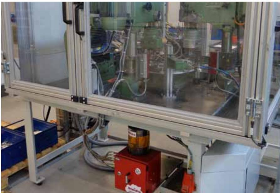
Eine der umgerüsteten Rundtaktanlagen. Unten ist das MMS-System ›Lubrimat L60‹ von Steidle zu sehen.
