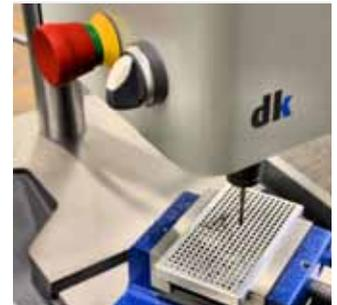
Ein Not-Aus-Knopf und ein Drehschalter zur Spindelabschaltung sorgen für Sicherheit im Betrieb.
