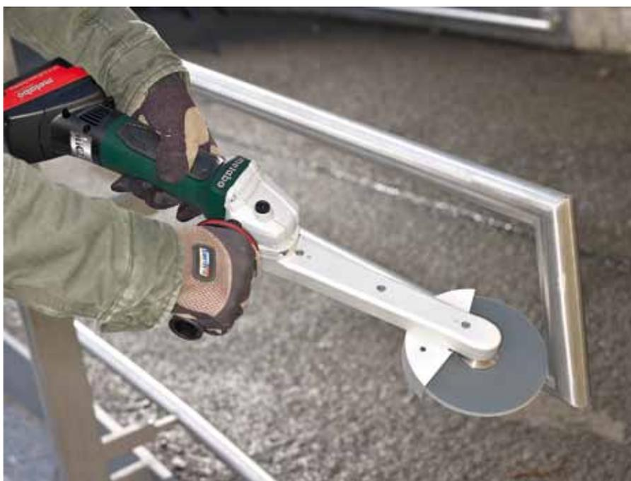
Mit dem Akku-Kehlnahtschleifer ›KNS 18 LTX 150‹ von Metabo lassen sich Edelmetall-Kehl-nähte verschleifen, ohne angrenzende Oberflächen zu beschädigen.
