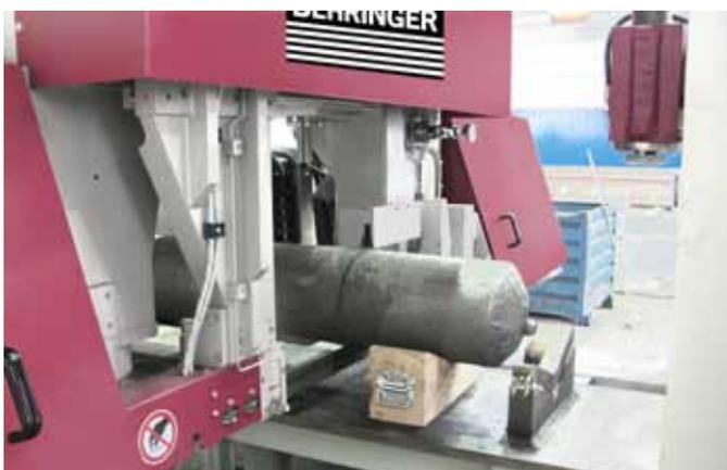
Zum Sägen schwer zerspanbarer Materialien stehen bis zu 11 kW Antriebsleistung zur Verfügung.
