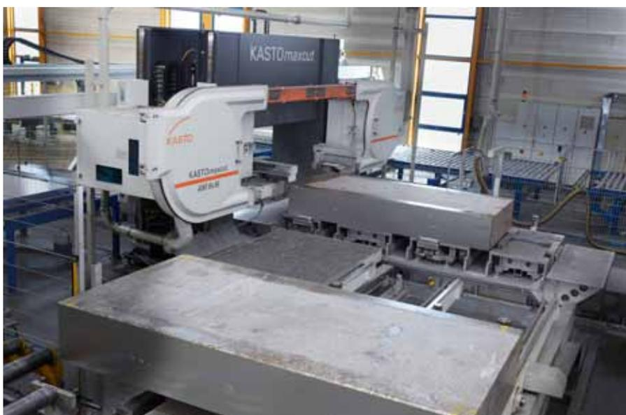
Die »Kastomaxcut« sägt aus Aluminium-Gussblöcken mit einem Gewicht von rund 15 Tonnen Platten in unterschiedlichen Dicken.
