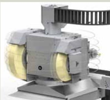
KEL-VARIA und KEL-VERA wurden mit der neuen hydrostatischen B-Achse erweitert. Die Positioniergenauigkeit ist mit einer linearen Achse vergleichbar und somit können Korrekturen über kleinste Inkremente vorgenommen werden. Das Schwenken von der Aussen- auf die Innenschleifscheibe dauert gerade mal eine Sekunde. Die Geschwindigkeit der Schwenkung im Bereich von 240° garantiert eine hohe Produktivität.
