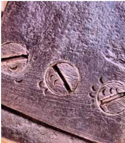
**Jede Schraube war ein Unikat und passte nur in eine ganz bestimmte Bohrung. Schraube und zugehörige Bohrung wurden daher vor 200 Jahren markiert.**
