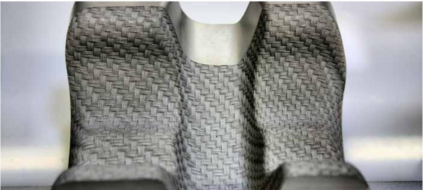
Die Software ›3D Map‹ erlaubt das automatische Erzeugen einer Textur an der korrekten Position. Dadurch wird die mühselige Festlegung der korrekten Position auf einem dreidimensionalen Objekt überflüssig.
