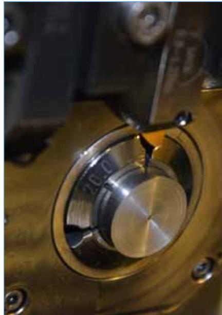
Rund 100 000 Abdeckstopfen aus Edelstahl fertigt Stängle Drehtechnik pro Jahr. Eine Herausforderung stellten bis dato lange Späne dar. Eine Lösung sind die Schneiden aus Iscars Swiss Cut-Reihe.
