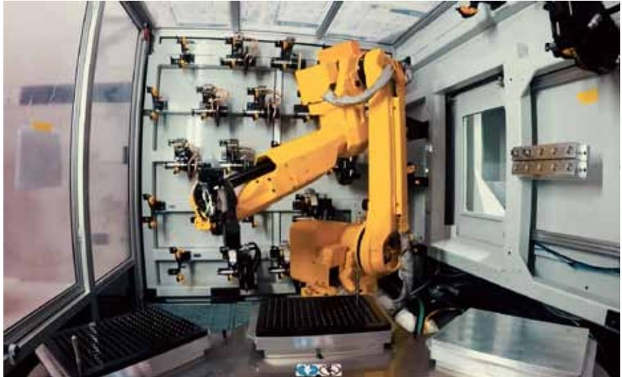
Durch die »Tapxcell« von Anca hat Fraisa eine maßgeschneiderte Lösung für 50 Stunden personallosen Betrieb sowie das Schleifen mehrerer Gewindebohrertypen erhalten.
