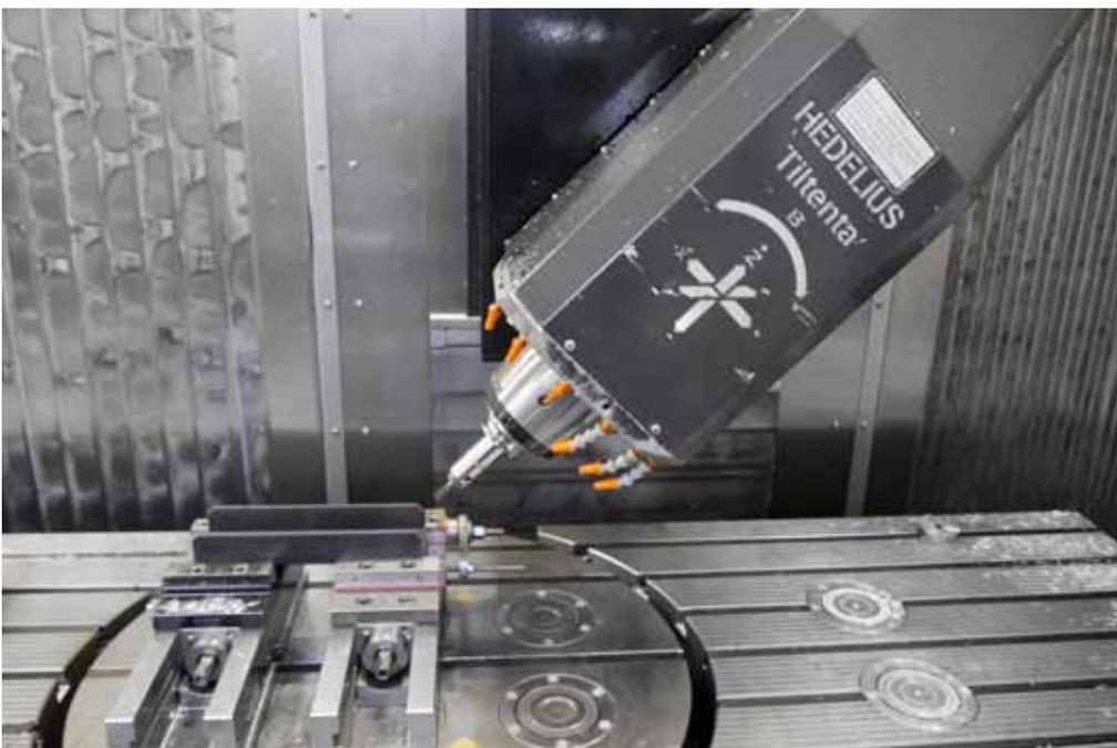
Auf dem integrierten NC-Rundtisch können kleine Teile fünfachsig bearbeitet werden. Für Langteile kann der Tisch überspannt werden.
