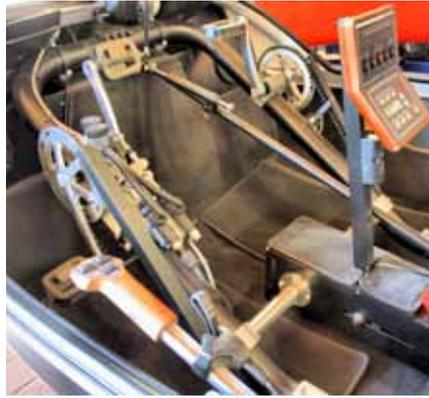
Twikes kommen ohne Lenkrad aus. Per Kurbel kann zusätzliche Reichweite erzeugt werden. Alternativ kann auch rein elektrisch gefahren werden.
