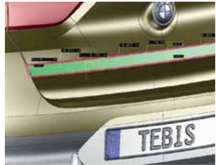
Bei der Flächenrückführung und der Flächenmodellierung bleiben in Tebis die theoretischen Kanten automatisch erhalten. In der Software stehen spezielle Funktionen zur Verfügung, um theoretische Kanten schnell zu erzeugen.
