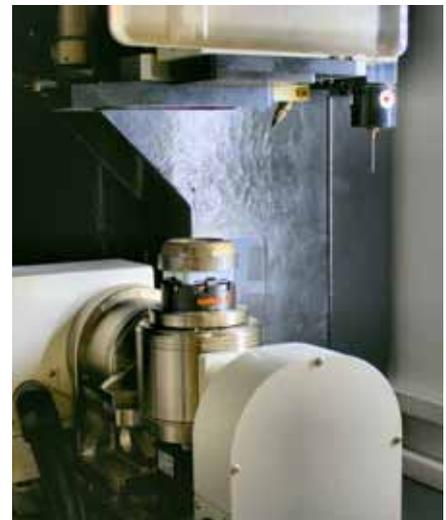
Der patentierte Rundum-Laserkopf kann zwei Laserquellen kombinieren.
