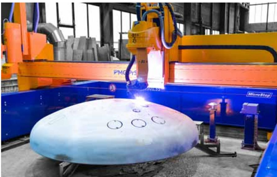
Die mscan-Technologie von Microstep ermöglicht höchste Präzision bei der Behälterbodenbearbeitung. Ein auf dem Portal integrierter Laserscanner ermittelt dabei vorab die tatsächliche 3D-Oberflächengeometrie des Werkstücks.
