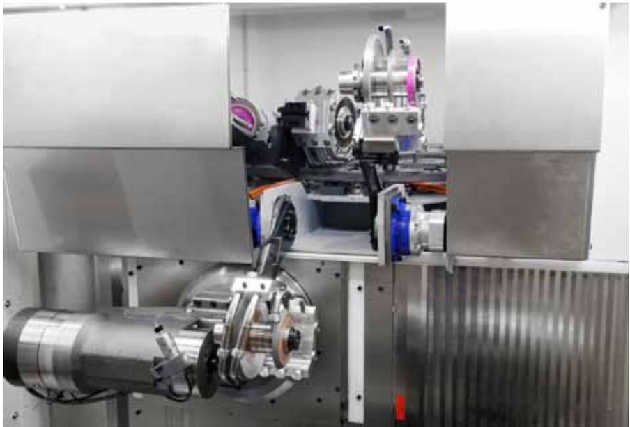
**In weniger als 12 Sekunden wechselt die GrindSmart 830XW das Scheibenpaket inklusive Kühlmitteldüsen. Dazu benötigt sie keinen zusätzlichen Platz in der Maschine.**
