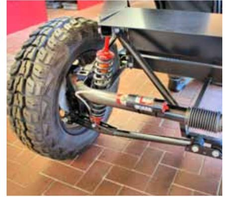
Eine hochwertige Starrachse mit einem innovativen Dreh-Schiebegelenk sorgt im kommenden ›Twike 5‹ für besten Fahrkomfort.
