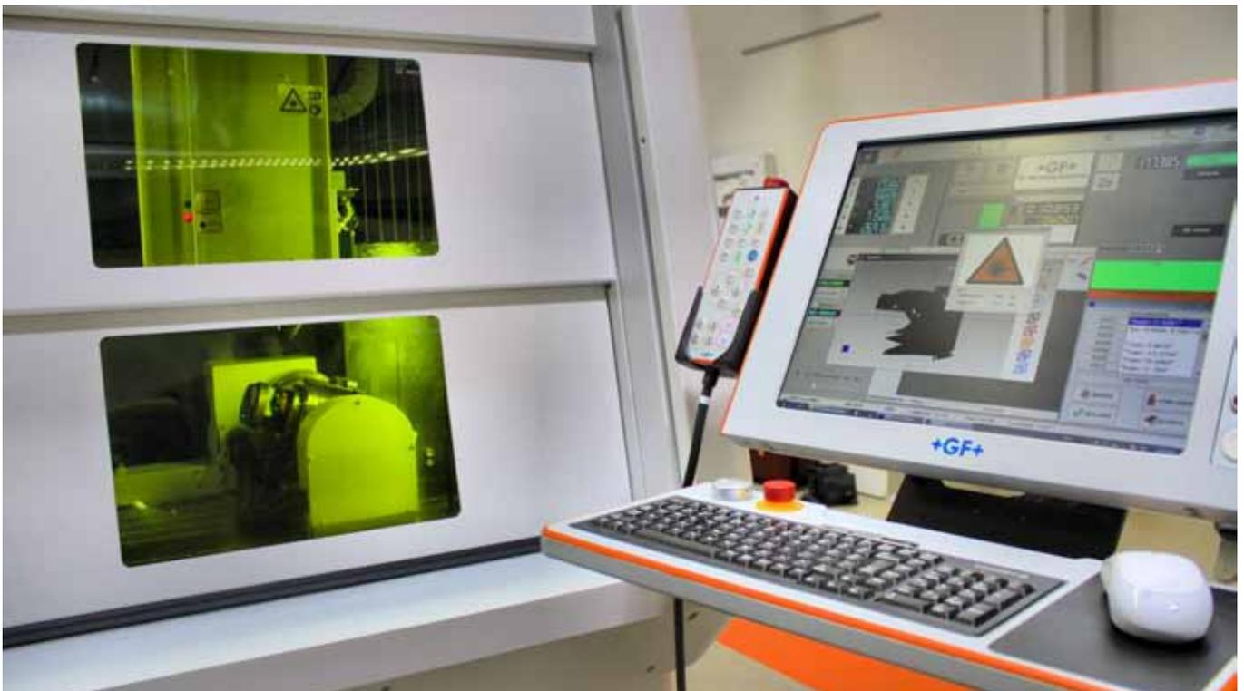
Die Beckhoff-Steuerung der ›AgieCharmilles Laser P 400‹ wurde von GF an die speziellen Aufgaben beim Lasertexturieren angepasst. Das Smartpatch-Modul sorgt für die optimale Patching-Strategie, ohne die Qualität der Textur zu beeinflussen.
