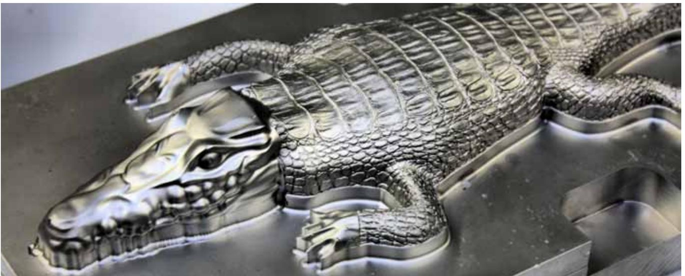
Graustufen sind das Geheimnis, Texturen mit hoher Plastizität zu erzeugen. Das abzutragende Material wird dabei verdampft und muss abgesaugt werden.
