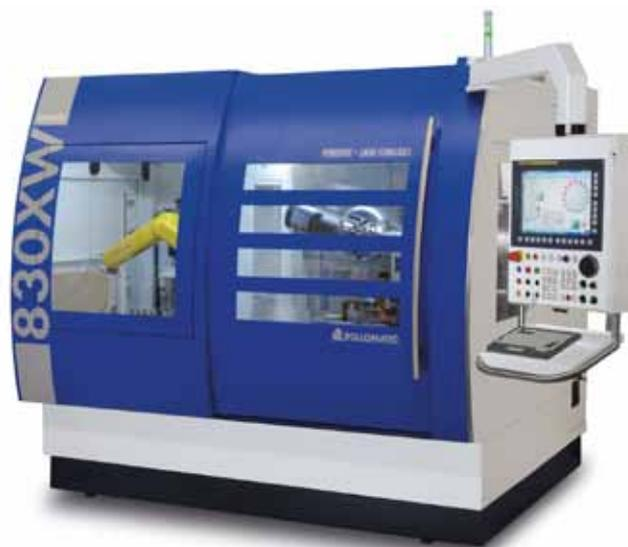
Die GrindSmart 830XW von Rollomatic kombiniert Hydrostatik und Lineartechnologie. Zusammen mit der sechsten Achse ist die Schleifmaschine bestens gerüstet zum Schleifen von Zerspanwerkzeugen.
