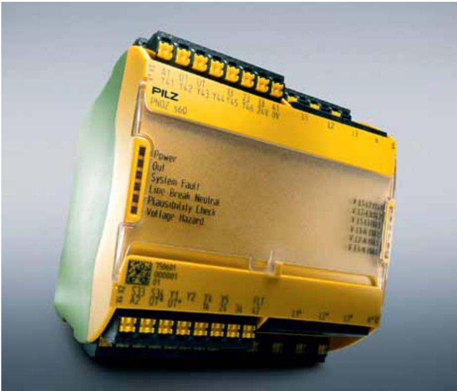
wächter ergänzt die Produktgruppe der Sicherheitsschaltgeräte »PNOZsigma« und erfüllt die Anforderungen zur Umsetzung von SLS-Anwendungen, die in den USA vorgeschrieben sind. PNOZ s60 überwacht spannungsfrei geschaltete 1- beziehungsweise 3-Phasen-Netze mit Neutralleiter. Zwei Schaltschwellen können eingestellt werden: 12 Volt oder die im Food-and-Beverage-Bereich üblichen
