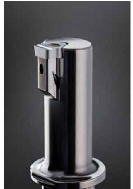
metrien sind durch das Fertigungsverfahren des Nutstoßens herstellbar. Es bietet im Gegensatz zum konventionellen Räumen eine kostengünstige Alternative, da es auf nahezu jeder CNC-Drehmaschine zum Einsatz kommen kann.
