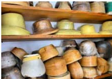
Alte Hutformen aus Holz sorgen dafür, dass das nasse Filzmaterial in eine endgültige Form gebracht werden kann.
