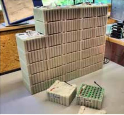
Jeweils sieben Module werden zu einem Akkublock zusammengefasst, der eine Gesamtleitung von 353 Volt beziehungsweise 3,5 kWh besitzt.
