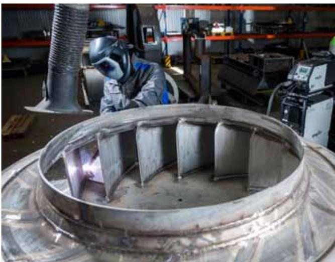
Ein geschweißtes Lüfterrad mit 3,5 Meter Durchmesser. In dem Bauteil befinden sich über 60 Meter Schweißnähte.
