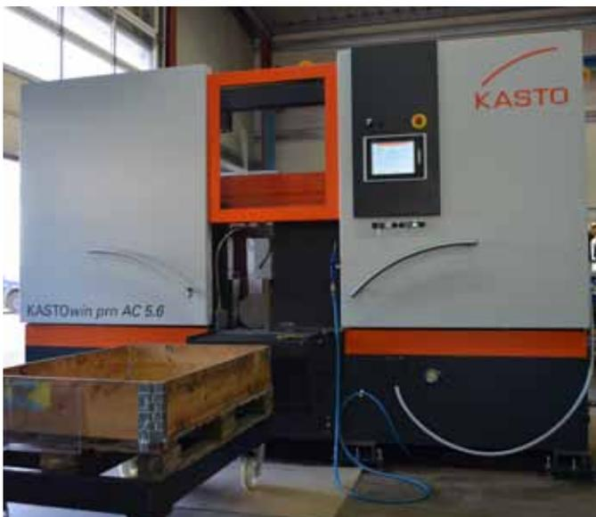
Werner Weitner setzt beim Sägen schwer zerspanbarer Werkstoffe auf die Hochleistungs-Bandsäge ›Kastowin pro AC 5.6‹.
