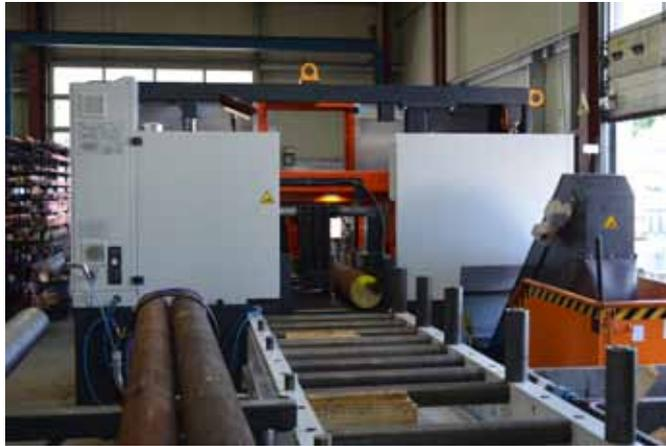
Das zu sägende Material wird manuell oder mit einem Hallenkran auf einer Rollenbahn abgelegt, die es der Maschine zuführt.
