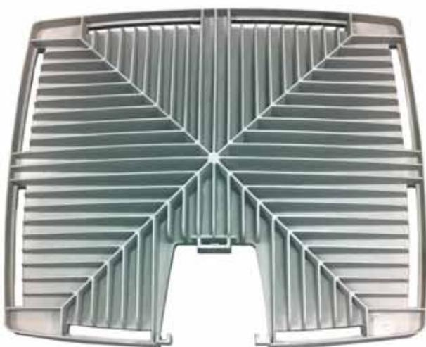
Fertig gegossene Kühlplatte. Wandstärken von 2,5 Millimetern konnten problemlos abgebildet werden.
