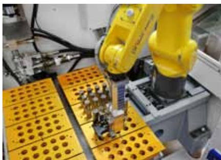
**Das Be- und Entladesystem durch einen Fanuc-Roboter ist für den mannlosen Betrieb essentiell.**
