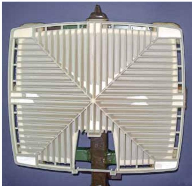
In Anlehnung an die CAD-Daten druckt die VX1000 Modelle aus PMMA-Pulver.
