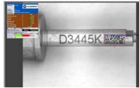
**UDI-Markierung nach 50 Autoklavierzyklen ohne signifikanten Einfluss auf die Lesbarkeit und ohne sichtbare Korrosion.**
