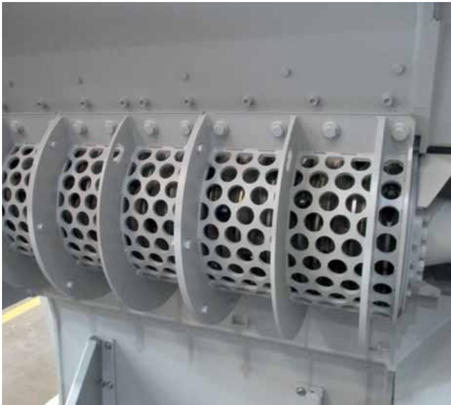
Das robuste Sieb kann für unterschiedliche Output-Korngrößen einfach gewechselt werden.
