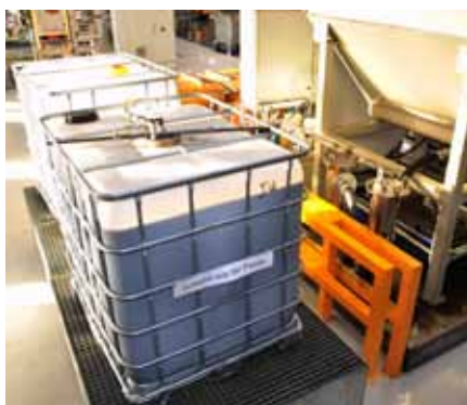
Das ausgepresste Schleiföl wird direkt an der Brikettieranlage gefiltert und in IBC-Containern gesammelt.
