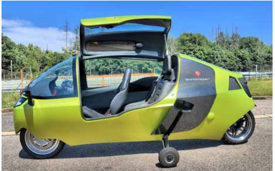
Der ›MonoRacer‹ der ›Peraves‹ ist ein zweisitziges, elektrisch angetriebenes Kabinenmotorrad mit sehr viel Hingucker-Potenzial.
