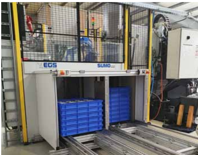
Das Palettiersystem ›Sumo Ecoplex2‹ von EGS bietet in der Variante mit Bändern eine Autonomie von bis zu 12 Stunden.
