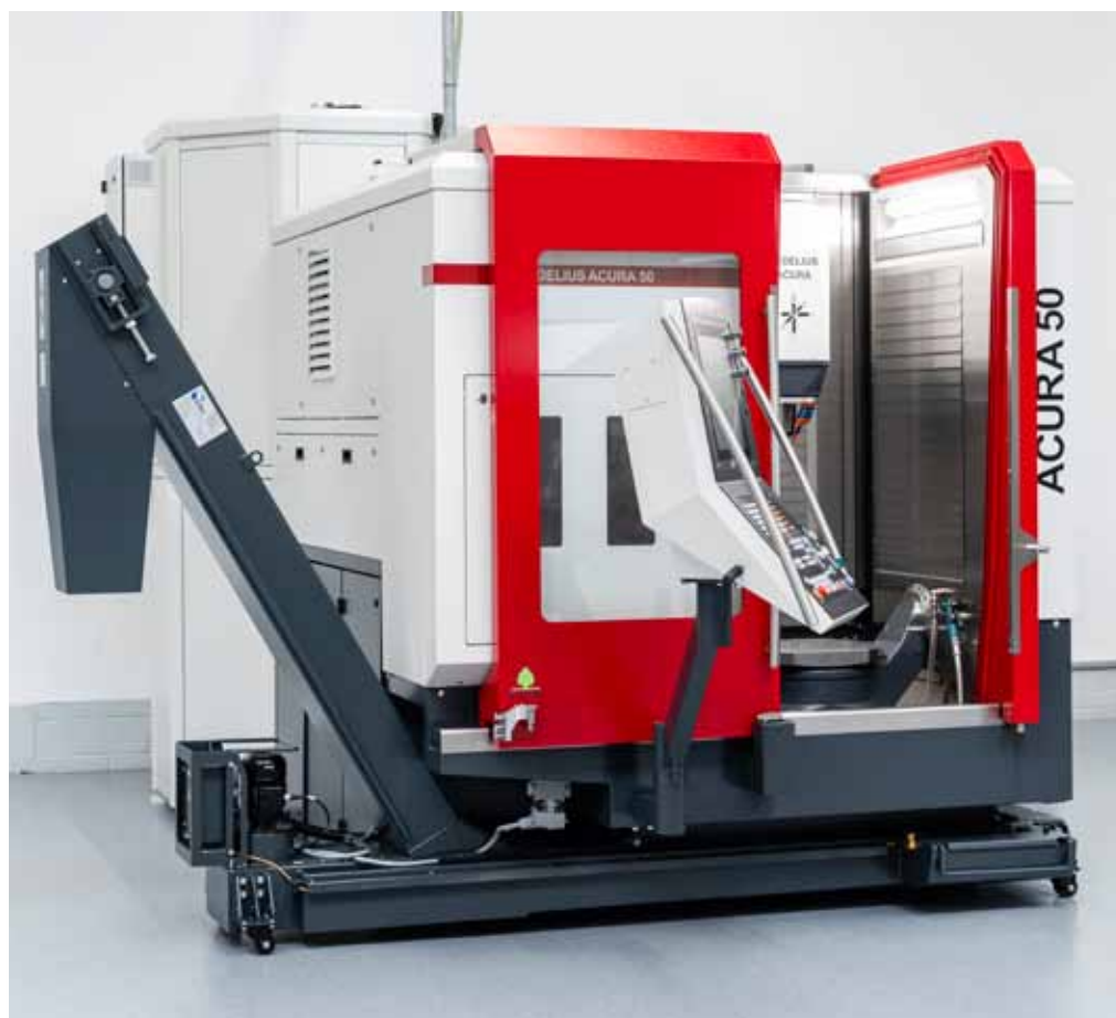
Die Acura 50 EL setzt Maßstäbe in der Kompaktheit und verfügt dennoch über große Verfahrswege von 500 x 550 x 550 Millimeter.
