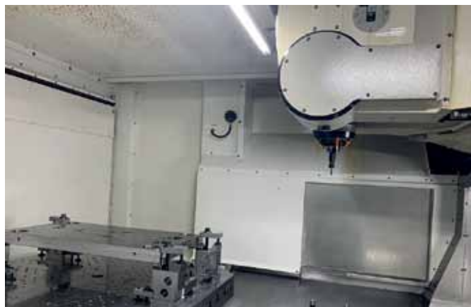
Die fünf Simultanachsen bieten einen Verfahrbereich von 1850 mm x 1400 mm x 905 mm, 360 Grad im Rundtisch und einen Schwenkbereich von –20 bis +120 Grad. Trotzdem bleibt die Positioniergenauigkeit teilweise sogar deutlich unter 10 µm.
