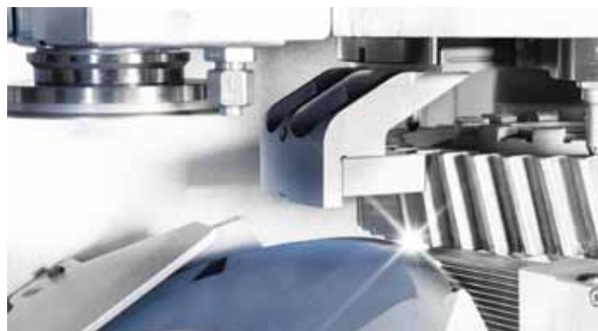
Die Kombinationsbearbeitung aus Hartdrehen und Schleifen sorgt auf der VLC 350 GT für schnelle Prozesse.
