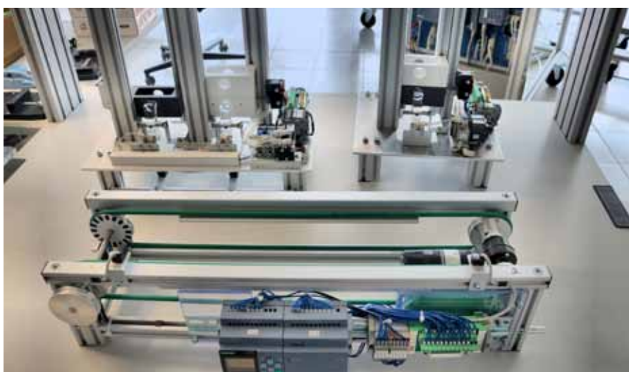
Unterschiedliche, für sich lauffähige Module bilden die Basis des Topik Didaktik-Lernsystems. Diese können problemlos zu größeren Einheiten kombiniert werden.
