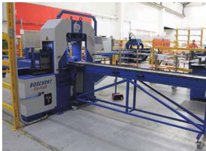
Mit der CU-Flex von Boschert ist die CNC-gesteuerte Komplettbearbeitung von CU- und AL-Stromschienen möglich.
