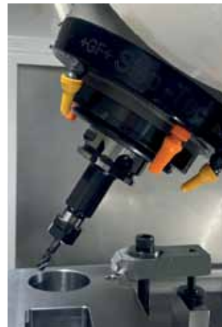
Die Schwenkachse der Mikron HPM 1850U ermöglicht auch seitlich optimalen Zugang zum Werkstück.
