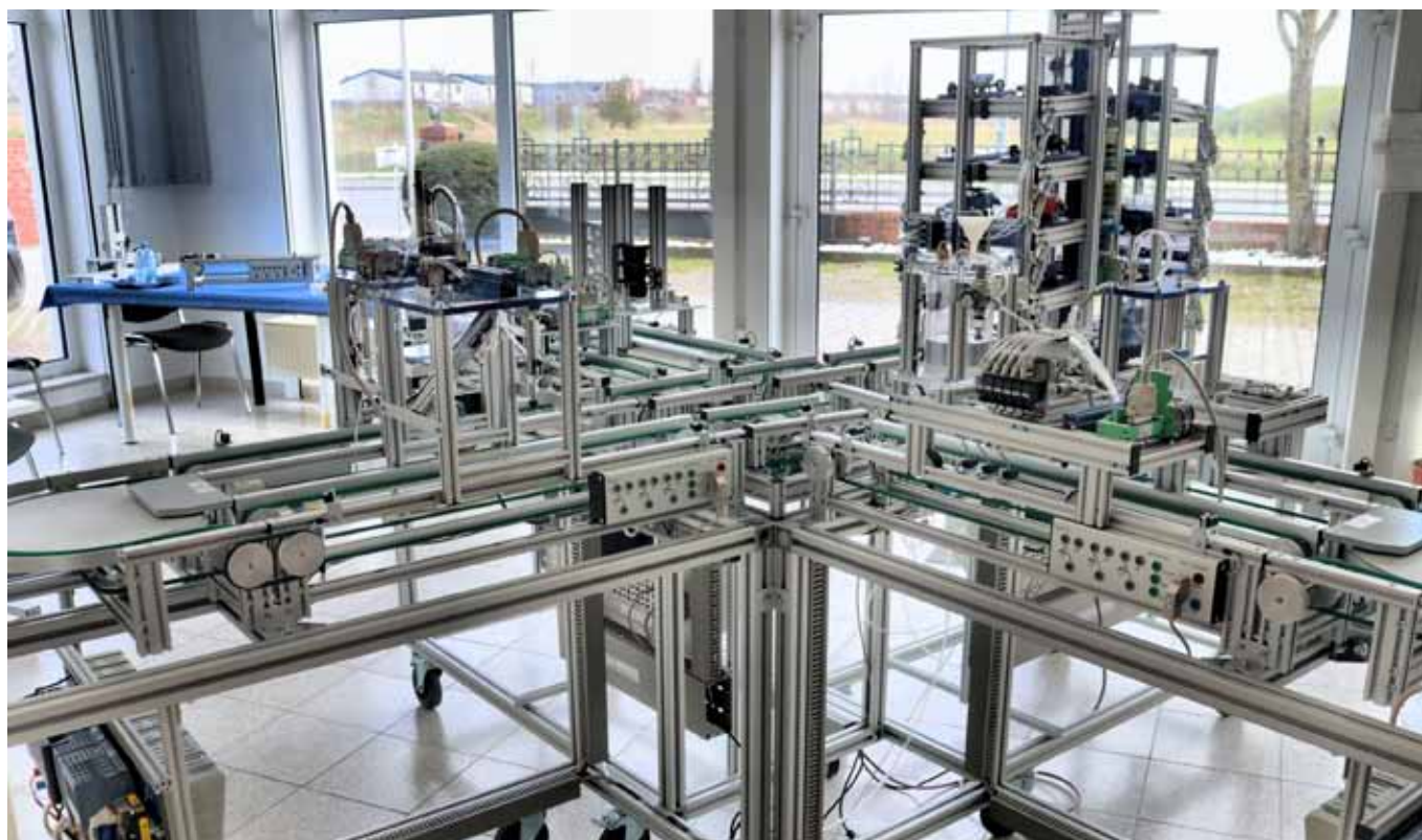
Die ›Lernfabrik Industrie 4.0‹ von Topik Didaktik ist bestens für die Aus- und Weiterbildung in Sachen ›Automatisierungstechnik‹ geeignet, da hier Industriekomponenten und weit verbreitete SPS-Steuerungen zum Einsatz kommen.
