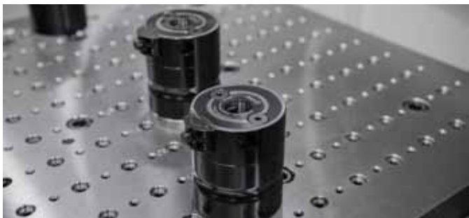
Die Werkstücke werden auf den Paletten direkt gespannt. Die Fangschrauben in den gehärteten Buchsen der Aufspannpaletten nehmen die Spannbolzen von Aufbau- und Zwischenelementen auf. Die gibt es von 20 bis 100 Millimeter.
