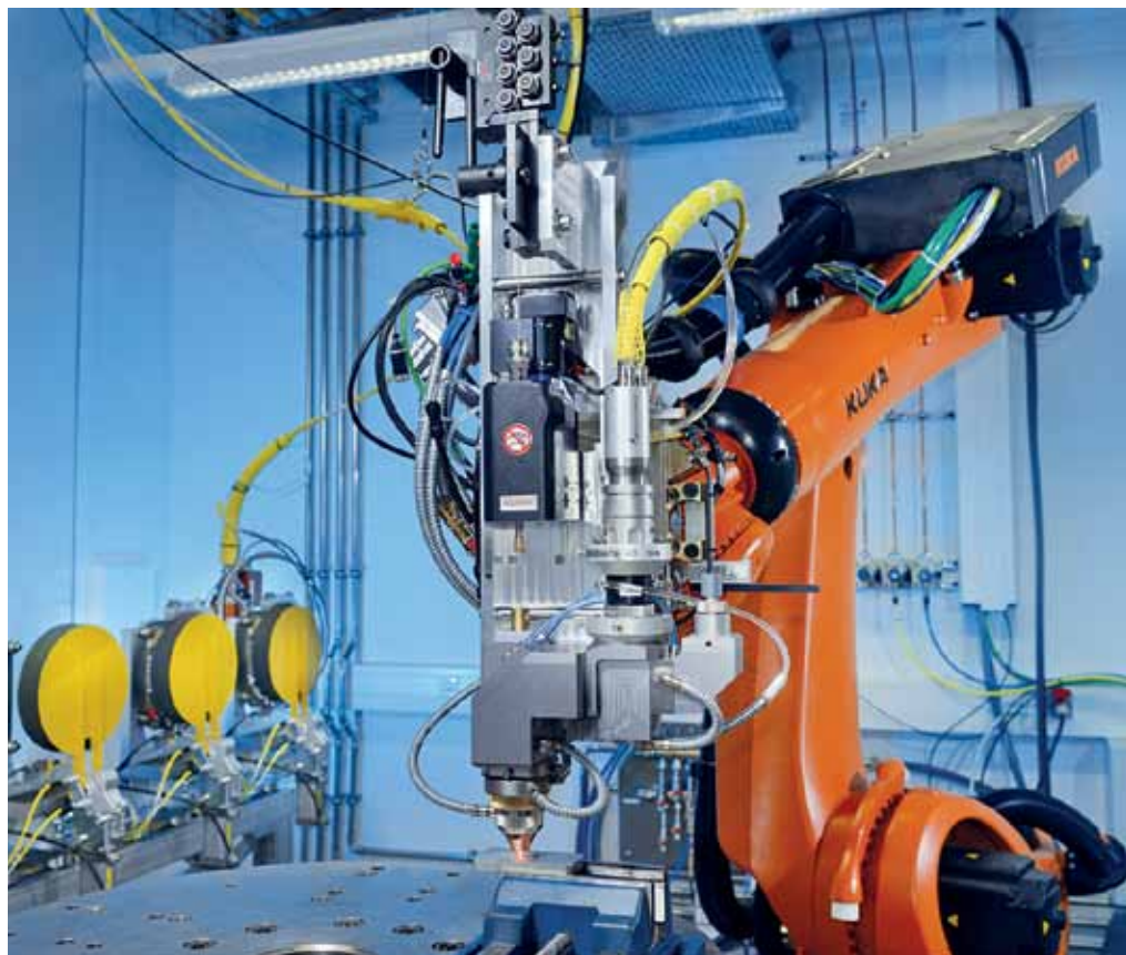
Roboterforschungszelle mit Optikwechselsystem beim Draht-Laserauftragschweißen am Fraunhofer ILT.
