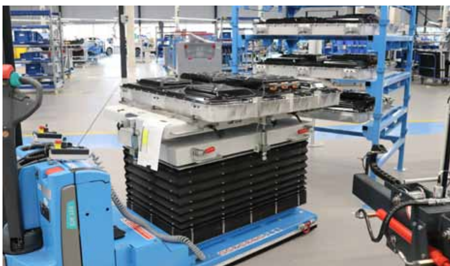
Bis zu 150 Kilometer Reichweite leistet die im Life verbaute Batterie, die über eine Spannung von 380 V Gleichstrom verfügt.
