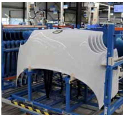
Die thermoplastischen Kunststoffe >ABS< und >PMMA< werden zum Bau des Life verwendet, was diesen nicht nur leicht, sondern auch sehr langzeitstabil macht.
