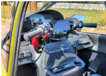
Das moderne Cockpit des MonoRacers wartet mit elektronischen Instrumenten, Navi und Radio auf.
