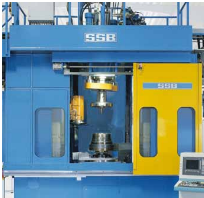
Die 1-Rollen-Drückmaschine ›1VDZ‹ von SSB-Maschinenbau ist eine attraktive Lösung für Einsteiger im Premium-Felgenreisbereich.
