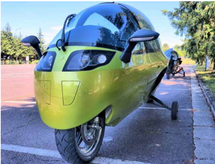
Die aerodynamische Karosserie des MonoRacers hilft, Energie beim Fahren durch einen Cw-Wert von nur 0,18 zu sparen und erlaubt es, mit wenig Stellplatz auszukommen.
