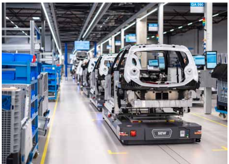
Ausgesprochen sauber ist die Aachener Montagehalle, in der e.GO seine Fahrzeuge produziert. Sie ist für eine Kapazität von 30 000 Fahrzeugen pro Jahr ausgelegt.
