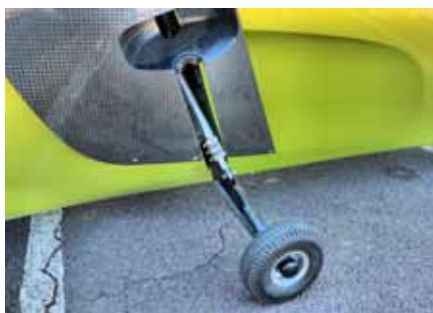
Zwei links und rechts angebrachte, elektrisch ausfahrbare Stützrollen verhindern ein Umfallen des MonoRacers.
