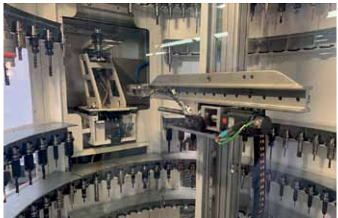
Die Mikron HPM 1850U verfügt über ein Werkzeugmagazin mit 238 Plätzen. So können genügend Werkzeuge und manchmal nötigen Schwesterwerkzeuge gelagert werden, auch bei unterschiedlichen Anforderungen an die einzelnen Paletten.
