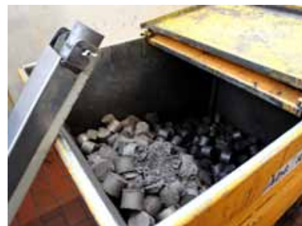
Über eine Auslaufschiene schiebt die RUF-Anlage den zu Briketts komprimierten und weitgehend ölfreien Schleifschlamm direkt in Sammelbehälter.
