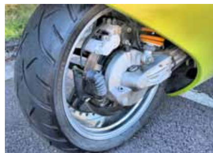
Das Drehmoment des Synchromotors (205 Nm) wird über eine Kardanwelle auf den Hinterreifen übertragen.
