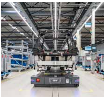
Induktionsschleifen führen die autonomen Transporteinheiten durch die Hallen, wo an verschiedenen Stationen die Montage erfolgt.
