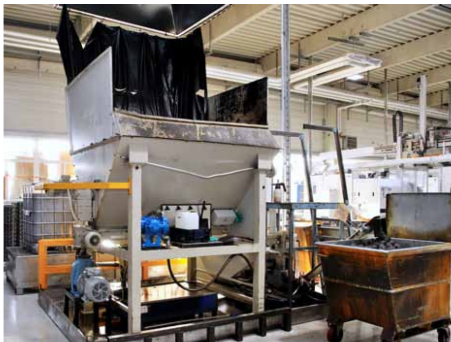
Im Dauereinsatz: Die RUF-Brikettieranlage im Werk Thyrnau hat seit 2007 rund 1,5 Millionen Liter Schleiföl aus Schleifschlämmen zurückgewonnen.
