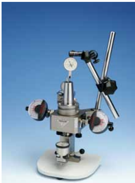
Mit Kegelmessgeräten von Diebold können Präzisionswerkzeugaufnahmen mühelos geprüft werden.
