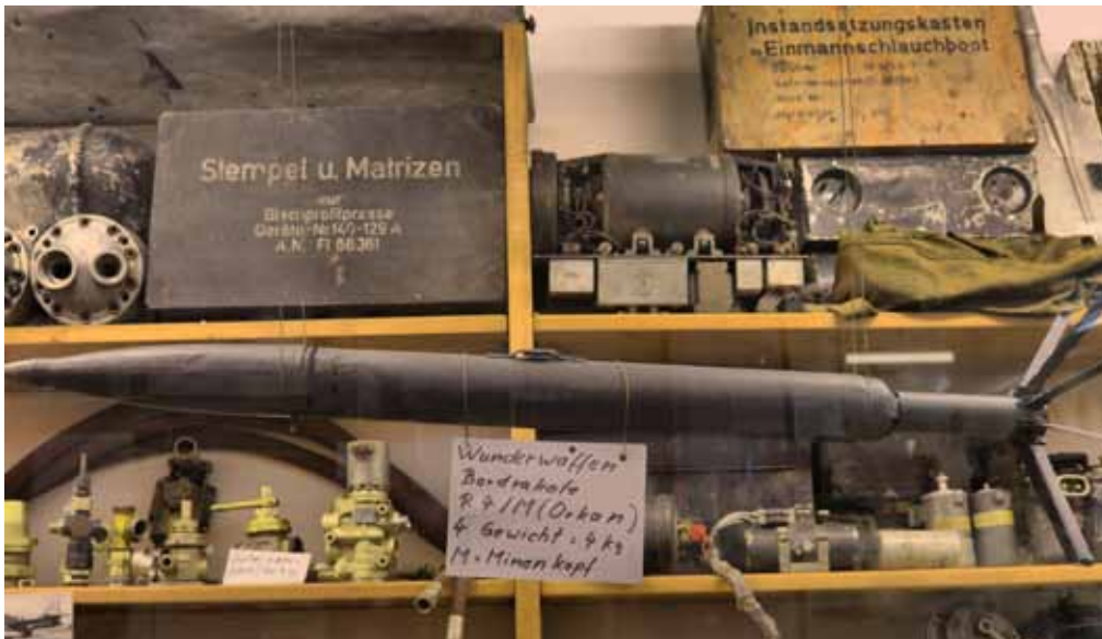
Die R4M-Rakete war eine Luft-Luft-Rakete, die unter dem Flügel einer Me 262 oder einer Focke-Wulf Fw 190 angebracht wurde und gegen B-17 und B-24-Bomber zum Einsatz kam.
