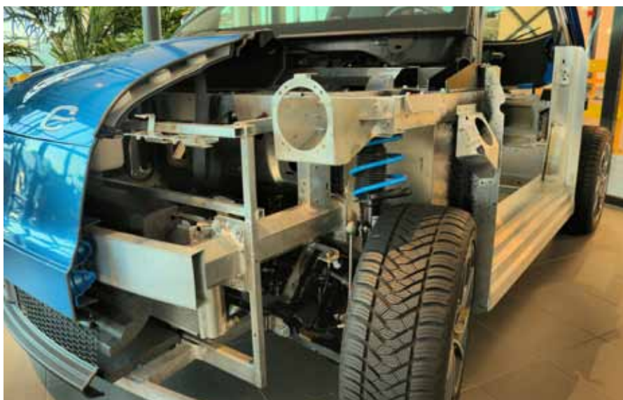
Aluminium und Kunststoff sind die dominierenden Materialien, die dem Fahrzeug von e.GO eine hohe Lebensdauer bescheren werden.
