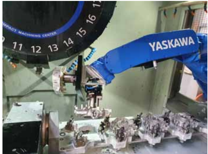
Werkstückwechsel: Der Roboter entnimmt ein bearbeitetes Teil und legt ein Rohteil in eine der vier Aufnahmen der Spannvorrichtung ein.
