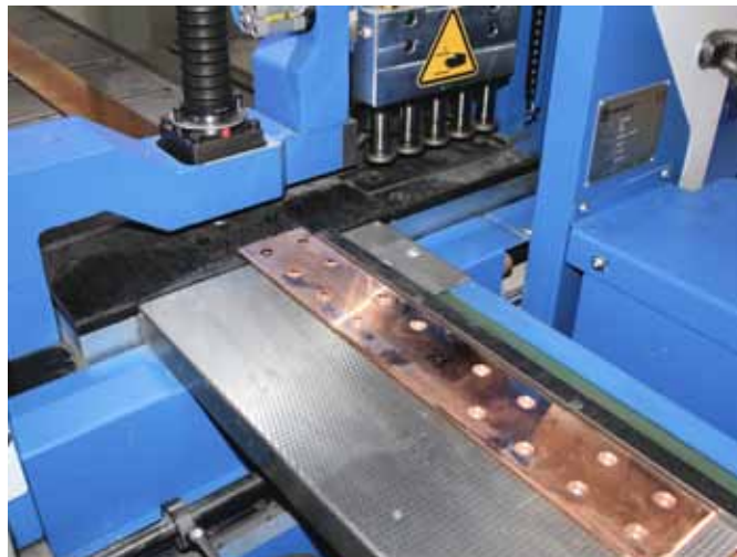
Ein komplett mit Befestigungslöchern versehenes und exakt auf Länge geschnittenes CU-Stromschienen-Bauteil.
