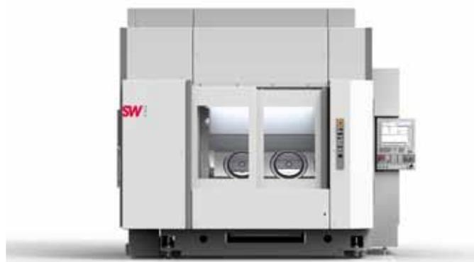
Eine Maschine viele Technologien: Auf einer SW-Maschine werden bis zu vier Teile gleichzeitig bearbeitet.
