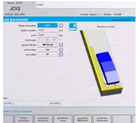
**Eine Spezialsoftware von Blohm fürs Schleifen von Gewindewalzbacken sorgt für die exakte Interpolation der Achsen.**
