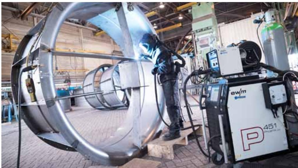
Eines von fünf vernetzten Schweißgeräten beim niederländischen Unternehmen Geha B.V. zum Verschweißen von Ventilatoren. Der Datentransfer erfolgt per LAN.
