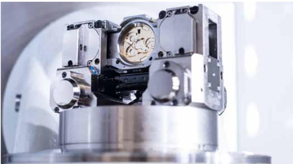
Fräsen, Bohren, Gewindeschneiden, Einstechen sowie Feinbearbeiten der Kanten – Röhms innovatives Kraftspann-Schwenkfutter eignet sich optimal, um Uhrenplatinen effektiv zu produzieren.
