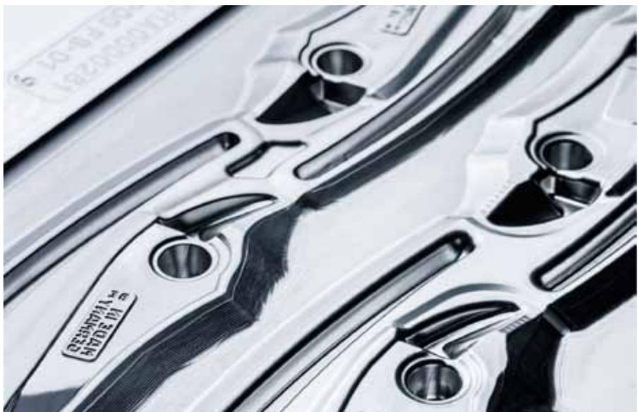
Die von den Knipex-Ingenieuren selbst konstruierten Schmiedeformen besitzen mehrere Funktionsflächen, um mit nur einem Gesenk aus einem sogenannten ›Piller‹ eine Rohform für ein Knipex-Werkzeug zu schmieden.
