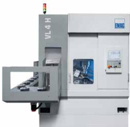
Die vertikale Pick-up-Wälzfräsmaschine ›VL 4 H‹ ist für radförmige Werkstücke bis 200 mm Durchmesser und Modul 4 ausgelegt.
