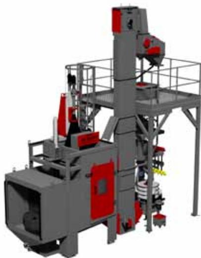
Das Kugelstrahlssystem ist für die Bearbeitung von Zahnrädern und Wellen mit einem Gewicht bis 60 kg ausgelegt.
