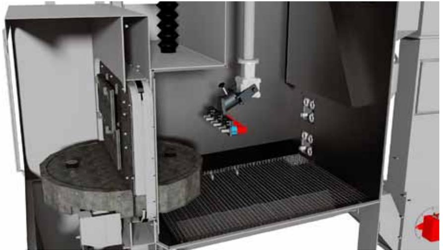
Durch die vertikal und horizontal verfahrbare Düseneinheit und die im Bereich von 0 bis 90 Grad schwenkbaren Düsen werden die Konturen aller Teile exakt erreicht.
