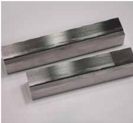
**Obere und untere Gewindewalzbacke für die Herstellung sogenannter Mathread-Schrauben.**
