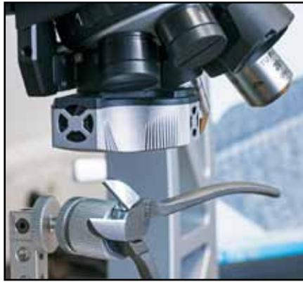
Beim Seitenschneider werden die Form und die Rauheit der Schneide mit einem optischen 3D-Messsystem präzise vermessen.
