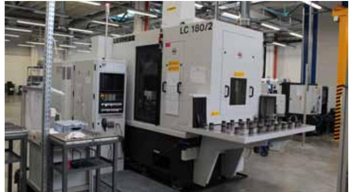
Die Wälzfräsmaschinen ›LC 180‹ von Liebherr sind mit einem Ringlader ausgestattet, der rasches Be- und Entladen erlaubt.
