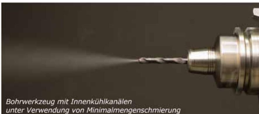
Zur Steigerung der Energieeffizienz werden mehr und mehr Bearbeitungsoperationen von klassischer Überflutungskühlung auf Minimalmengenschmierung umgestellt.
