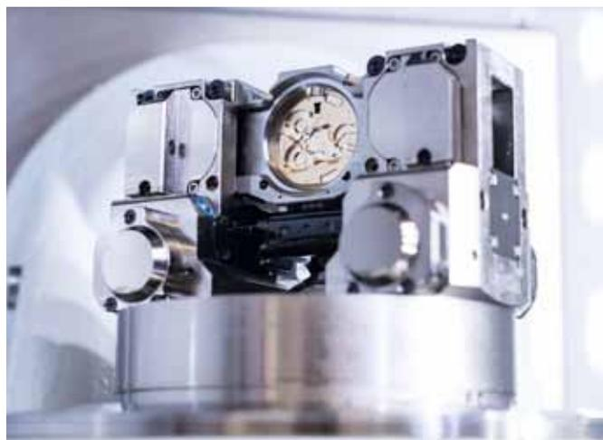
**Spannprimus für die Uhrenfertigung 38**
