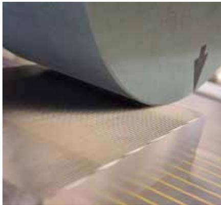
**Aufgespannt auf dem CNC-Drehtisch von pl Lehmann: Schleifen einer Gewindewalzbacke mit Ein- und Auslaufschrägen.**
