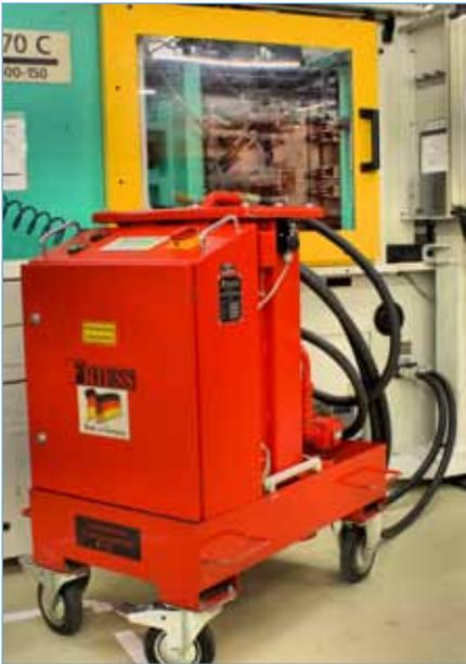
Mittels elektrostatischer Ölreinigungsgeräte der Friess GmbH können die Ölwechselzyklen von Hydraulikanlagen massiv verlängert werden, wie die Robert Bosch Fahrzeugelektrik Eisenach GmbH zeigt.
