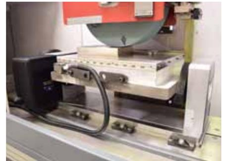
Der CNC-Drehtisch mit Gegenlager macht aus der dreiachsigen Profilschleifmaschine ein vierachsiges Schleifzentrum.
