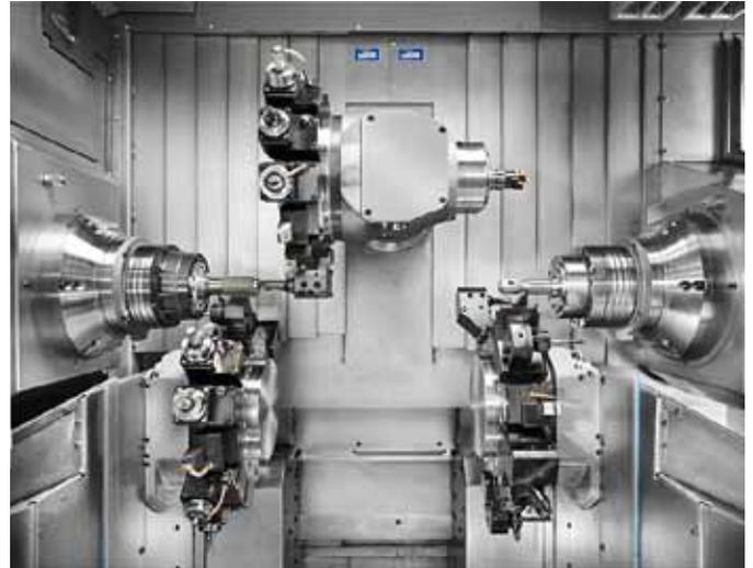
Durch das vertikal angeordnete Maschinenbett und anderer konstruktiver Kniffe ist der Arbeitsraum geräumiger geworden als beim Vorgängermodell. Es stehen jetzt 660 mm Drehlänge zur Verfügung.
