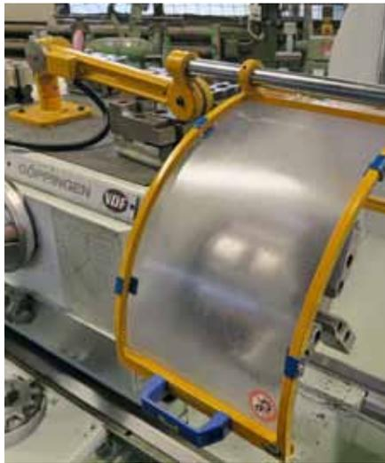
**Schnell angebracht und sicher im Betrieb: Das Unternehmen Hellwig rüstet alte Drehmaschinen mit modernen Futterschutzhauben nach.**
