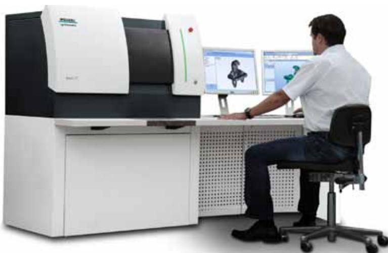
Der Computertomograph »Exact M« von Wenzel entspricht einem Vollschutzgerät nach den gesetzlichen Bestimmungen der Röntgenverordnung.
