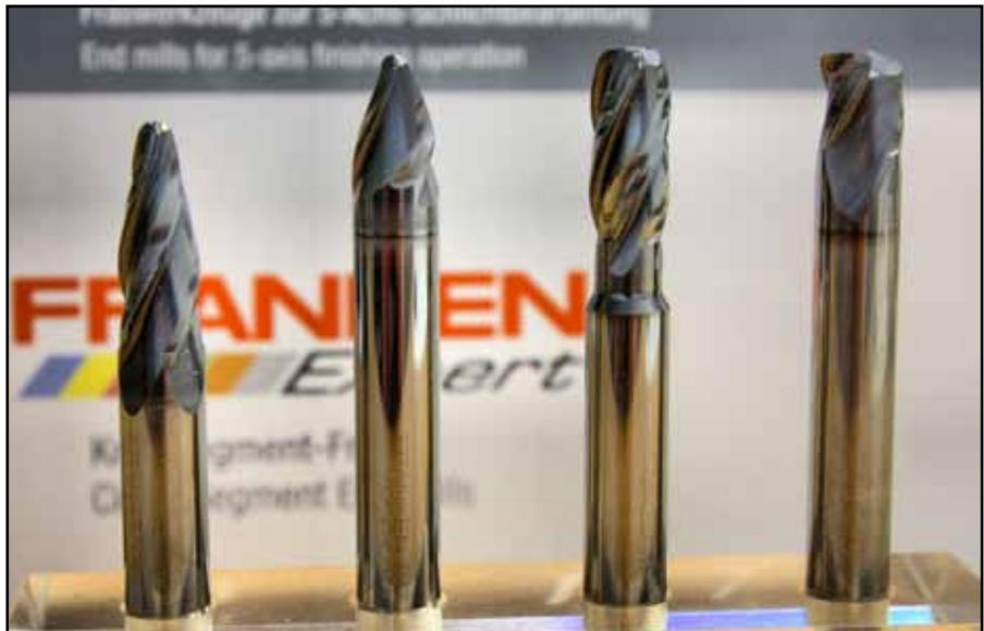
**Kreissegmentfräser von Franken gibt es in Kegel-, Tropfen-, Linsen- und Tonnenform. Sie ermöglichen eine wesentlich höhere axiale Zustellung als Kugelfräser, was zu einem immensen wirtschaftlichen Vorteil durch signifikant kürzere Hauptzeiten führt.**
