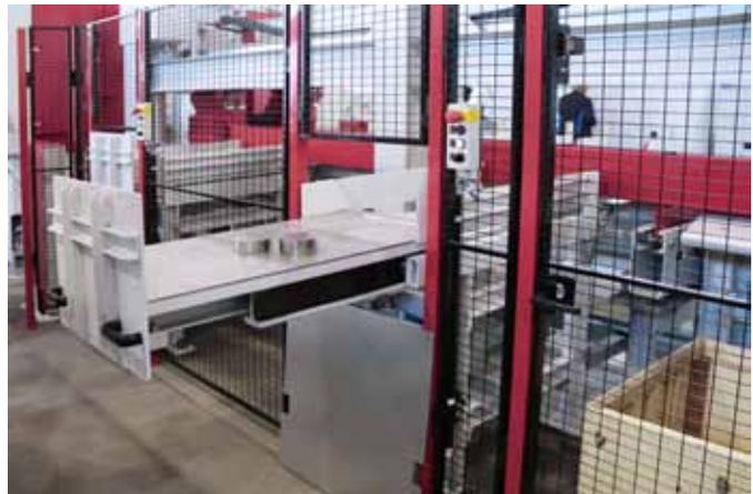
Verschiedene Schubladen und Gitterboxen auf einer Seite der Abfuhrrollenbahn nehmen die Gutteile auf.
