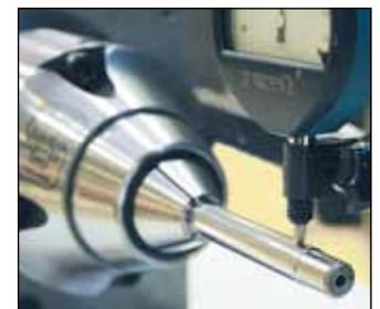
es in verschiedenen Größen. So etwa der Typ SRS W 20, dessen Einsatzspektrum im Miniaturbereich von 0,3 mm bis 10 mm Stangendurchmesser liegt. Ein Vergleichstest mit 300 HM-Werkstücken, Ø 6 mm, Prüflänge 50 mm, zeigt das Potenzial: So lag der Rundlauf mit SRS und Schaublin-Spannzange im Schnitt bei 0.0021 mm, ohne SRS bei 0.0083 mm. Die Standardabweichung betrug mit SRS 0.0018 mm gegenüber 0.0028 mm.
