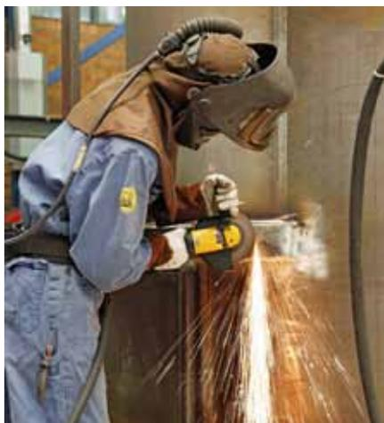
**Eine Abkühlpause ist bei GTG-Turboschleifern mit Druckluftantrieb unnötig.**
