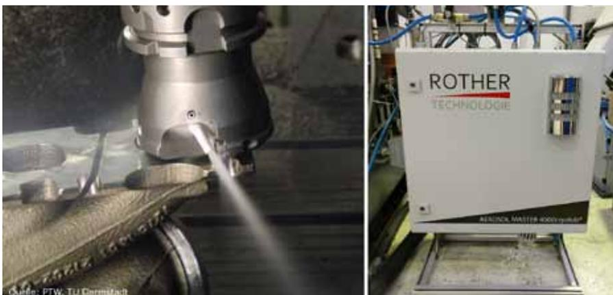
Die Produktivität bei der Bearbeitung von hochwarmfesten Materialien kann durch die Verwendung von MMS in Verbindung mit kryogener Kühlung gesteigert werden.
