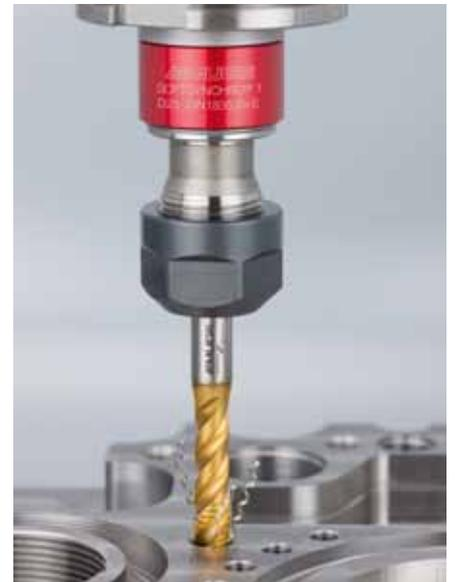
Spanabfuhr, konisch abgesetztes Führungsgewinde zur Vermeidung von Spanverklammerung sowie erhöhte Toleranz für abrasive oder klemmende Werkstoffe. Für optimale Leistungsfähigkeit ist ein Einsatz in Emuges Softsynchrospannzangen aufnahmen empfehlenswert.
