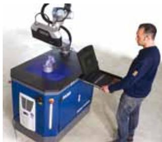
sungen erforderlich sind. Der Factory Array Imager ist ein auf Blaulicht-Technik beruhender neuer 3D-Sensor mit extrem hoher Messgenauigkeit, der rasch hochauflösende Daten für die Maßprüfung an Bauteilen, Baugruppen und Werkzeugen erfasst. In Verbindung mit einem kollaborativen Roboter ist der Robo-Imager eine betriebsbereite Lösung zur Automatisierung der Inspektion und Prüfung von Bauteilen überall in der Produktionsumgebung.
