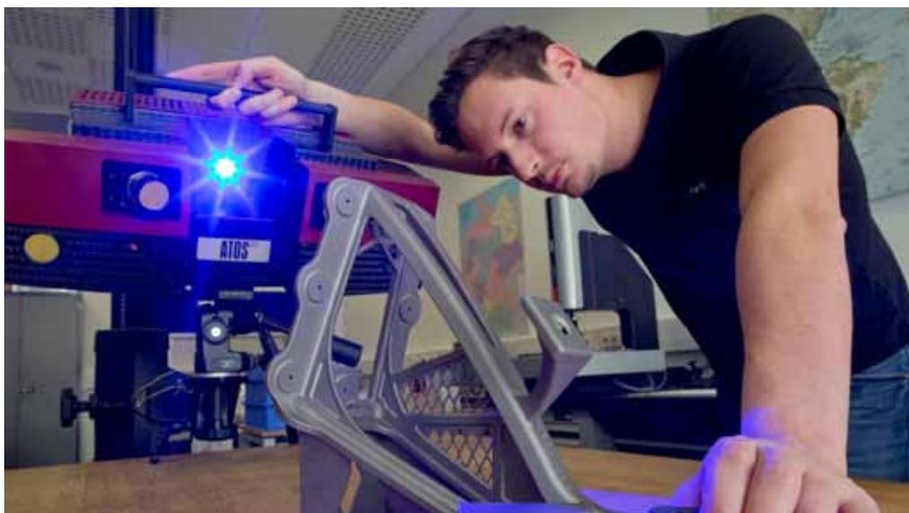
Optische Vermessung einer Leichtbaustuktur. Der 3D-Druck ermöglicht komplexe Bauteile, die Verarbeitung schwer zerspanbarer Materialien, sowie die Bauteilerzeugung in kürzester Zeit.
