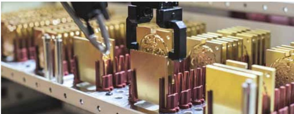
**Das wiederholgenaue Fertigen der Uhrenplatine bei IWC ist nur maschinell möglich. Bis zur fertigen Uhrenplatine sind bei einer Aufspannung 270 Operationen mit 54 Werkzeugen nötig.**
