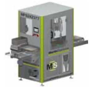
oder häufige Produktwechsel anstehen. Besonders gefragt ist sie bereits in der Automobil- und Elektronikindustrie sowie der Medizintechnik. Der Flexsorter, der jeden Förderkopf ersetzt, ist neu unter den Eigenentwicklungen von MartinSystems. Er versagt auch da nicht seinen Dienst, wo stoßempfindliche oder sich leicht verhakende Teile zugeführt werden müssen. Dazu dreht und schüttelt der Rütteltisch die Teile, um sie für die Materialzuführung wieder zu entzerren.
