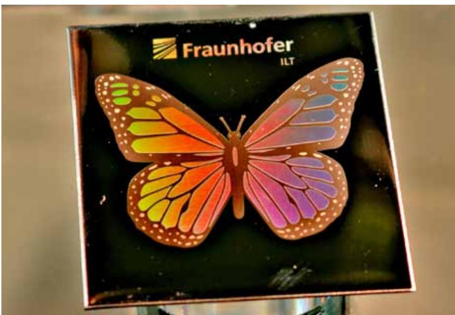
Mit dem Ultrakurzpulslaser ist es möglich, Oberflächen derart zu bearbeiten, dass sich dort das Licht bricht und Farben hervorgerufen werden, deren Spektrum und Intensität sich je nach Blickwinkel ändert.
