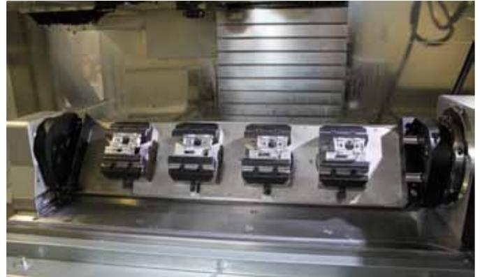
Für die vierachsen-Bearbeitung ist die Schwenktisch-Grundplatte mit vier Gressel-Zentrischspannern ›C2 125‹ bestückbar.
