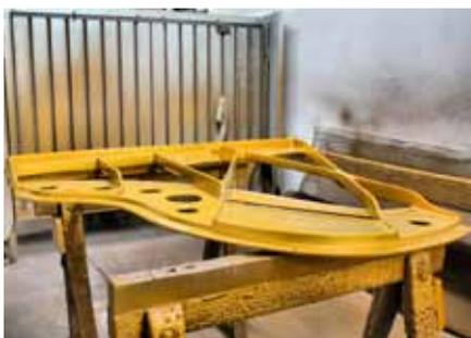
Ein schwerer Gussrahmen nimmt später die Saiten auf, die Zugkräfte von bis zu 20 Tonnen entwickeln können. Dieser besteht aus „fehlerhaftem“ Guss, was ein wichtiger Grund für guten Klang ist.
