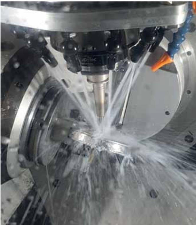
Mit der »Mikron HSM 200U LP« werden Zahnprothesen präzise mit sehr guter Oberflächenqualität hergestellt.
