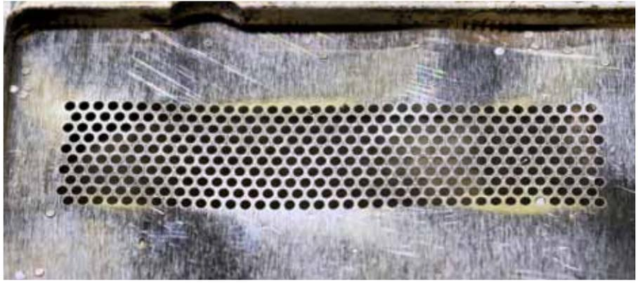
Mit dem UKP-Laser steht ein Werkzeug zur Verfügung, das sich ideal zum Bohren großer Mengen kleiner Bohrungen eignet. Die kurze Einwirkzeit des UKP-Lasers beim Bohren sorgt dafür, dass nahezu kein Wärmeeintrag in das umliegende Material erfolgt. Gefügeveränderungen und damit einhergehende Anlassfarben sind daher nicht zu erwarten. Darüber hinaus ist Grat kein Thema, sodass Nacharbeit entfällt.
