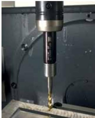
**Die modularen Verlängerungen ermöglichen das Fertigen von komplexen Geometrien ohne Spezialwerkzeug.**
