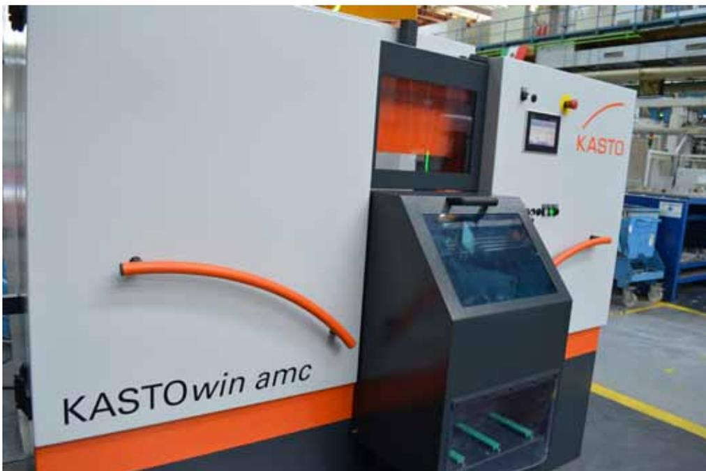
Um additiv gefertigte Titanbauteile von ihrer Grundplatte zu trennen, setzt Airbus Helicopters auf die vollautomatische Bandsäge »Kastowin amc«.
