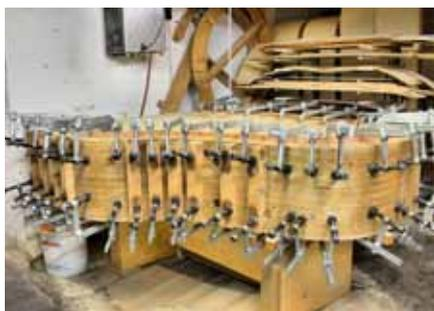
Beim Herstellen des Korpus wird auf das übliche Schlitzfenster verzichtet. Zudem ist es erwähnenswert, dass ein Knochenleim zum Einsatz kommt, der dafür sorgt, dass hohe Luftfeuchtigkeit vertragen wird.
