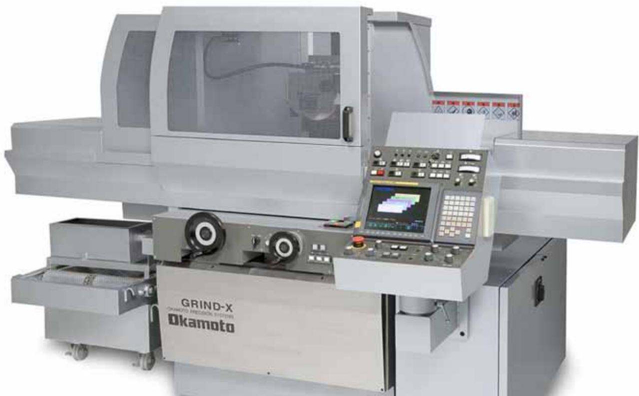
Mit der ›UPZ 525 NCII‹ bietet Okamoto eine CNC-Schnellhubmaschine an, die mit ihrer speziellen Technologie optimal für die Herstellung von Präzisionsoberflächen geeignet ist.
