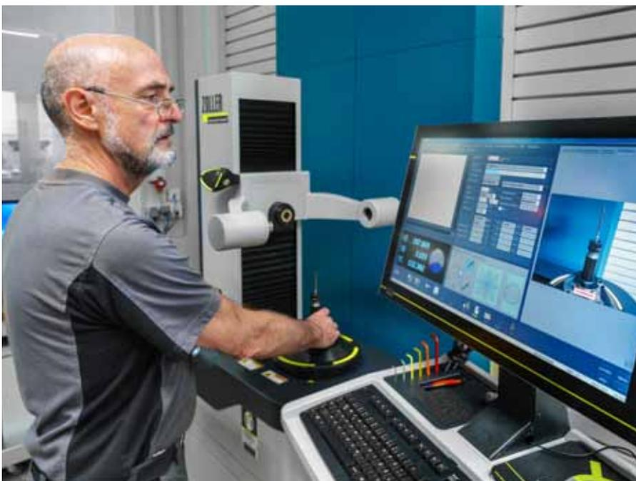
Die Werkzeuge werden am Zoller-Einstellgerät vermessen und die Werkzeug-Ist-Daten über einen Postprozessor für die Maschine steuerungsgerecht aufbereitet.
