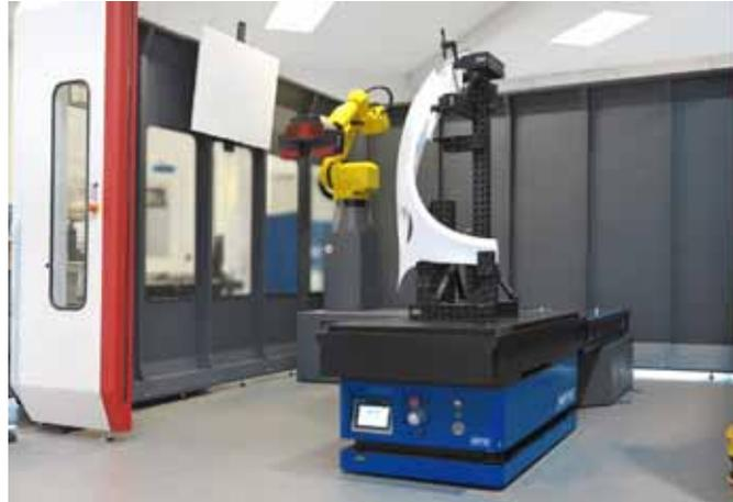
sich der Scooter schnell und flexibel jeder Raumgeometrie an. Ein laserbasiertes 360-Grad-Orientierungs- und -Sicherheitssystem lässt ihn vor plötzlichen Hindernissen stoppen, und sogar hinterlegte Ausweichrouten einschla-
