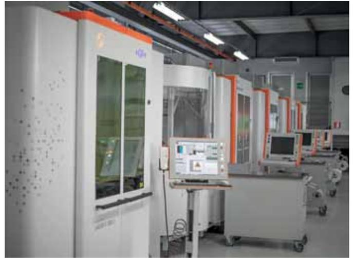
Im Maschinenpark von Standex Engraving Mold-Tech befinden sich 31 AgieCharmilles Lasertexturiermaschinen für die schnelle Endbearbeitung komplexer Formen in höchster Qualität.
