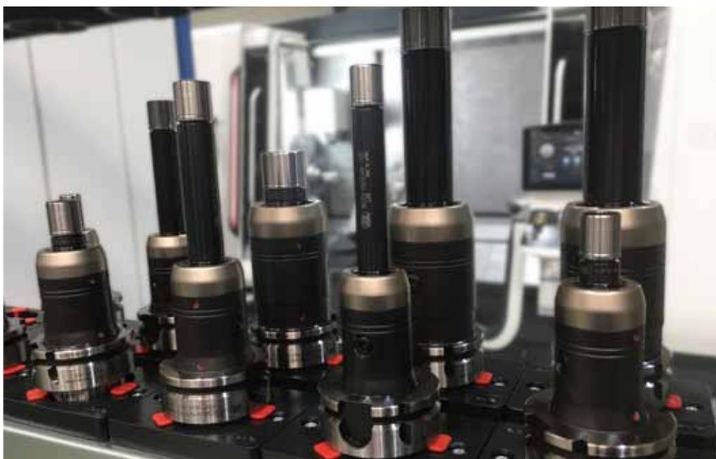
Schittl hat einen umfangreichen Maschinenpark mit verschiedenen Aufnahmetypen. Die Verlängerungen passen auf jede Aufnahme und reduzieren so die Anzahl der benötigten Werkzeuge.
