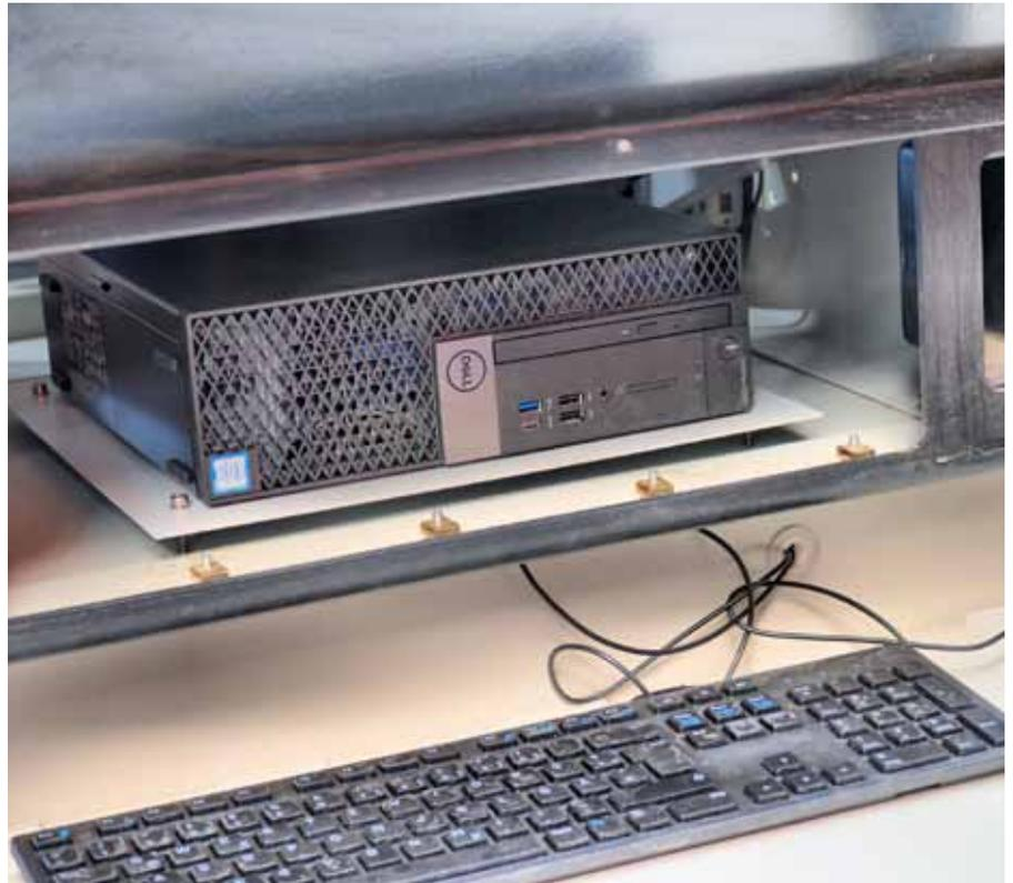
**Die PC-basierte Steuerung der Omax-Wasserstrahlanlagen ist geschützt unterhalb des Steuerung-Monitors untergebracht. Der PC verfügt über schnelle Prozessoren, wie etwa den i7 von Intel, 16 GB RAM und stammt von renommierten Herstellern, um die Gefahr eines Ausfalls so gering wie möglich zu halten.**
