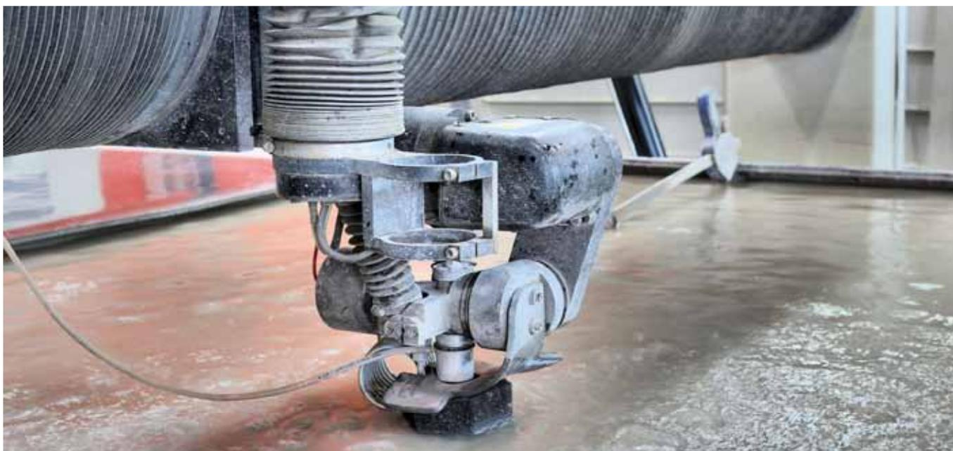
Der ›Tilt-A-Jet‹ von Omax ist ein während der Bearbeitung um einen von der Omax-Steuerung berechneten Winkelbetrag schwenkender Wasserstrahlkopf, der auf diese Weise genaue rechtwinklige Kanten erzeugt. Der Trick dabei ist, dass die Steuerung den Kopf so schwenkt, dass der beim Wasserstrahlschneiden entstehende Schnittpaltkonus in das Abfallstück verlagert wird.
