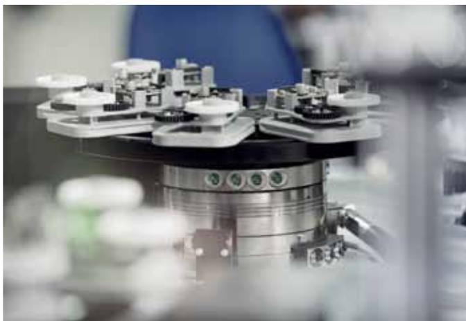
**Mechatronische Drehmodule, wie das ERS von Schunk, machen den Aufbau kompakter, mechatronischer Handhabungssysteme möglich.**
