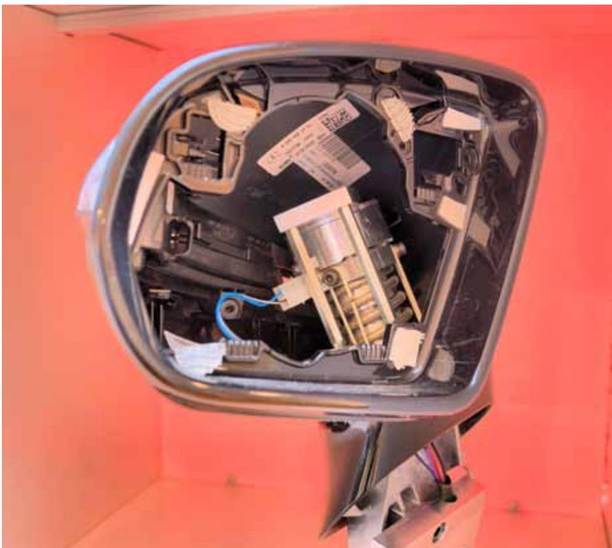
Federn aus Formgedächtnislegierung sind in der Lage, Stellmotoren für klappbare Kfz-Außenspiegel zu ersetzen. Sie sind robust und überzeugen durch hohe Zuverlässigkeit.
