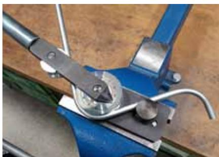
**Mit dem Handrohrbieger von Stauff lassen sich Biegungen präzise erzeugen.**
