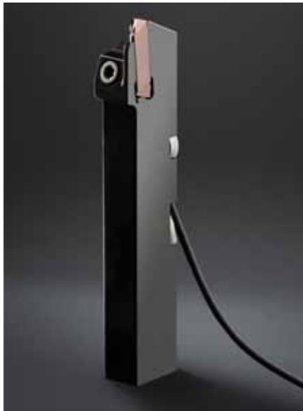
chung von Mikro-Drehbearbeitungen entwickelt. Das Piezo Tool System (PTS) besteht aus einem Kraftsensor, welcher in das Drehwerkzeug eingelegt wird und Aufschluss über den Zustand des Werkzeuges während der Bearbeitung gibt. Der extrem kleine Piezo-Sensor misst selbst niedrigste Zerspankräfte mit hoher Auflösung. Der Maschinenbediener kann so fehlerhafte Materialien und Schneid-
