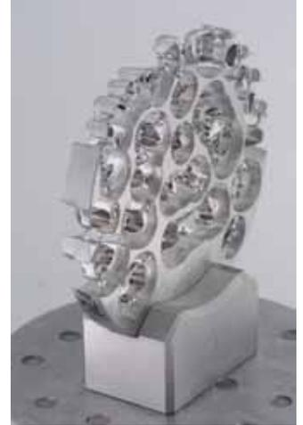
Fertig bearbeiteter Rohling, eingespannt in das System 3R-Nullpunktspannsystem.
