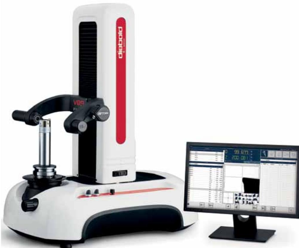
Mit den VEG Plus-Voreinstellgeräten können sekundenschnell die Maße in X- und Z-Achse, Radius, Rundlauf und Winkel ermittelt werden.
