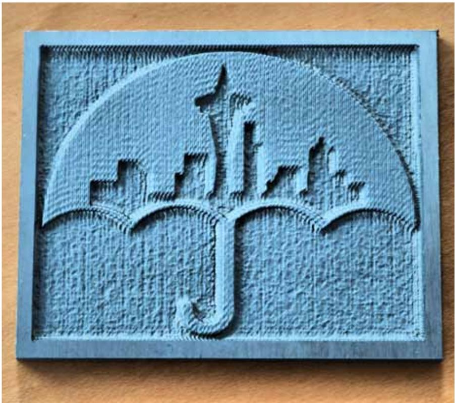
Die per Wasserstrahl erzeugbaren 3D-Relief-Bilder sind erstaunlich aussagestark, weshalb Omax-Wasserstrahlanlagen nicht nur zur Kennzeichnung fälschungssicherer Produkte, sondern auch für künstlerische Anmutungen interessant sind.
