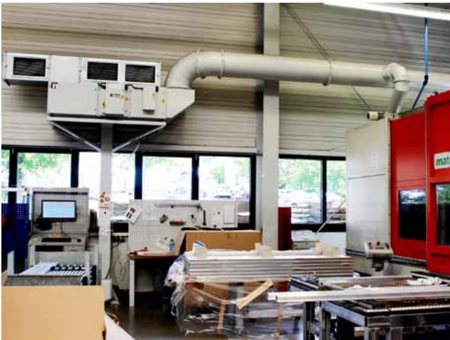
Bei der Fräsbearbeitung mit Minimalmengenschmierung an Aluminiumprofilen wird die abgesaugte Luft über zweistufige elektrostatische Abscheider mit mechanischem Vorfilter gereinigt und in die Halle zurückgeführt.
