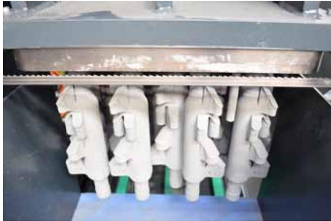
Gesägt wird bei der »Kastowin amc« kopfüber – das schont die teuren Bauteile, die dadurch nach dem Schnitt nicht umstürzen oder einknicken können.
