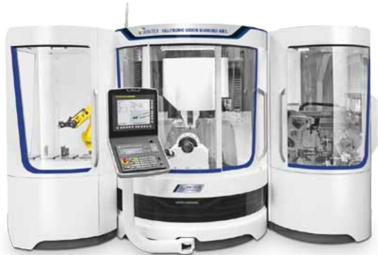
Mit der ›Helitronic Vision Diamond 400 L‹ hat Walter sein Produktportfolio bei den Erodier- und Schleifmaschinen im Two-in-One-Konzept erweitert. Damit können rotationssymmetrische Präzisionswerkzeuge bearbeitet werden.
