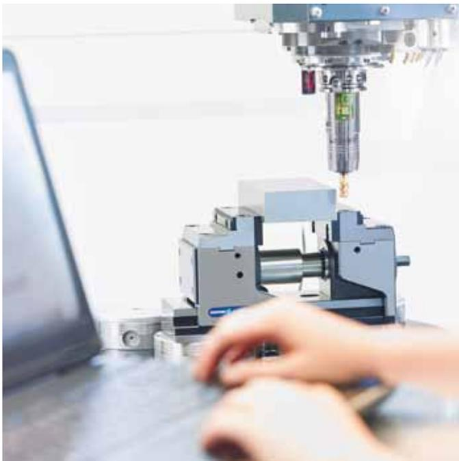
Der smarte Werkzeughalter »iTendo« von Schunk ermöglicht eine Echtzeitprozessüberwachung und -regelung unmittelbar am Werkzeug.
