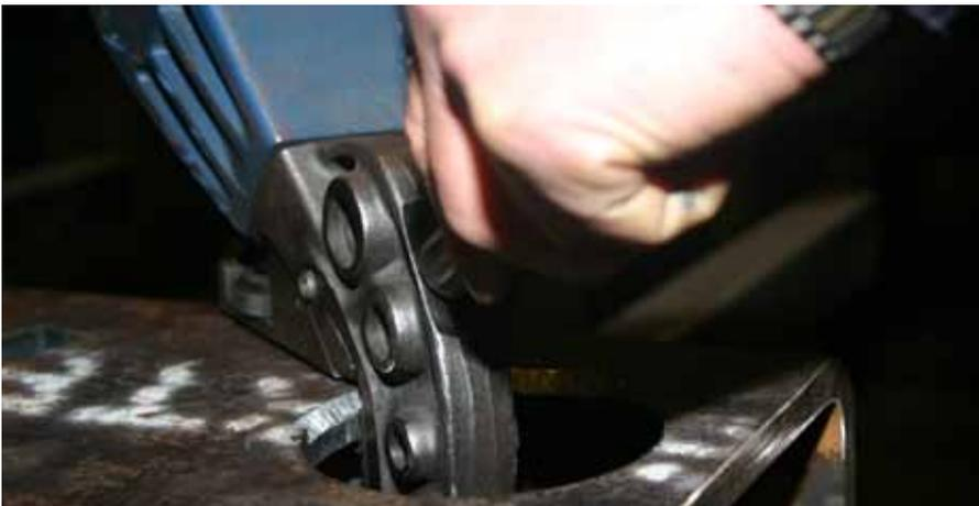
**Kantenformer, wie die Trutool TKF-Baureihe von Trumpf, sind einfach und sicher in der Handhabung.**
