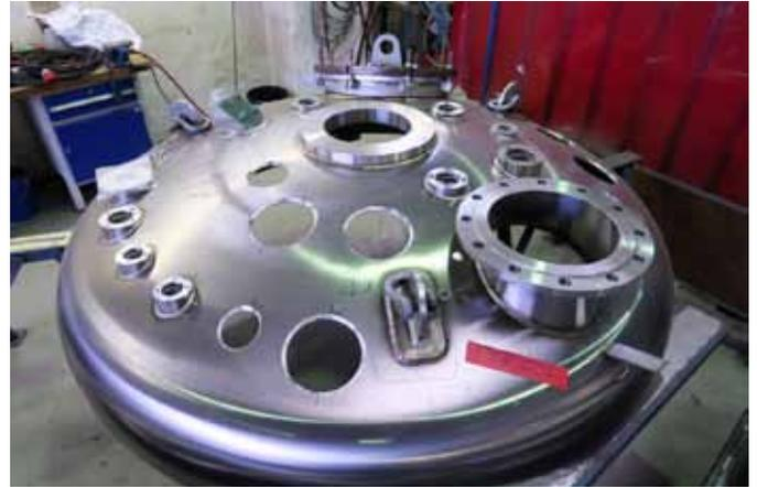
Die auf der MG Plasmaschneidanlage vorbereiteten Behälterböden werden im Nachgang mit zahlreichen Stützen versehen.
