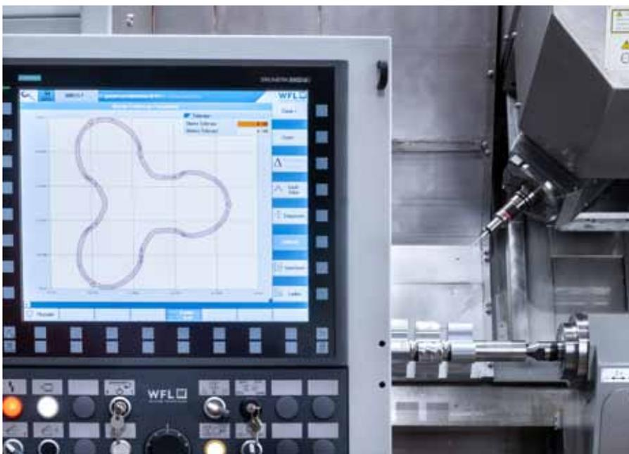
Darstellung der Kontur in der von WFL entwickelten Softwarelösung. Die schwarze Linie visualisiert das Soll-Maß, die blaue das gescannte Ist-Maß und die rote die vorgegebene Toleranz.
