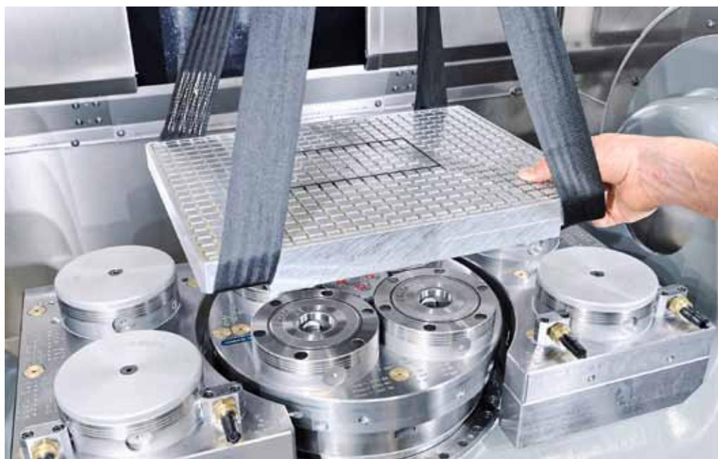
Mithilfe des Schunk Vero-S Nullpunktspannsystems und der integrierten Medienübergabe ist die Schunk Planos-Vakuums Spannplatte in wenigen Sekunden in die Maschine eingewechselt.
