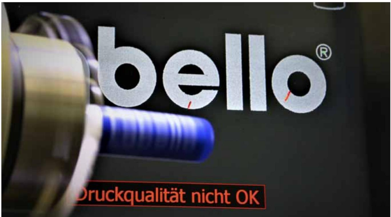
Analyse des Runddrucks an einem rotierenden Lippenpflegestift mithilfe der oben angeordneten Kamera. Fehlstellen in den Buchstaben »e« und »o« sind farblich markiert
