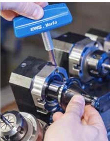
EWS Varia VX-Schnellwechseladapter mit Iscar Multi-Master-Schnittstelle bieten einen hohen Mehrwert bei Flexibilität, Handhabung und Produktivität.
