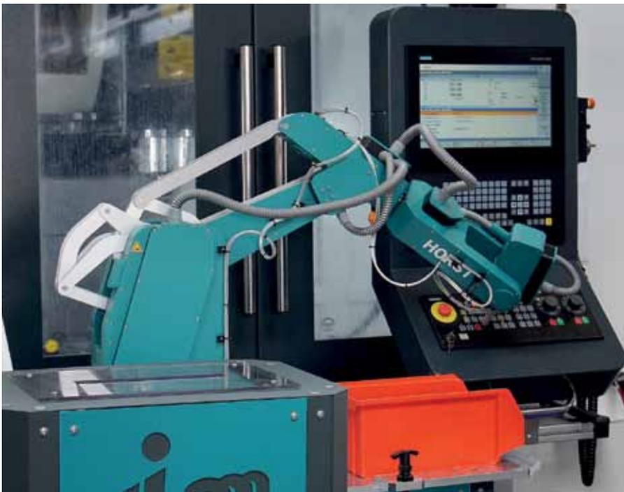
An der CNC-Fräsmaschine arbeitet Horst, wie es ein menschlicher Maschinenbediener täte. Er startet mit präzisiertem Druck auf den Startknopf sogar den Fräsprozess.
