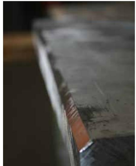
**Kantenformer eignen sich vor allem für die Erzeugung perfekter Schweißkanten. Die Oberflächen der erzeugten Kanten sind oxidfrei und metallisch blank.**
