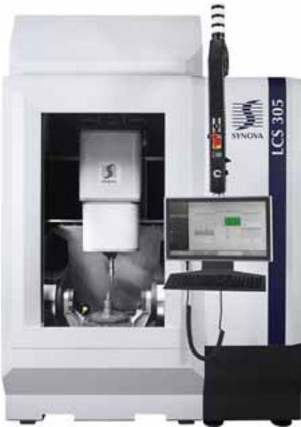
Die Materialbearbeitung erfolgt beim LMJ-Verfahren von Synova durch einen dünnen Wasserstrahl, in den Laserimpulse geleitet werden. So werden Werkstoff-Beeinträchtigungen verhindert.
