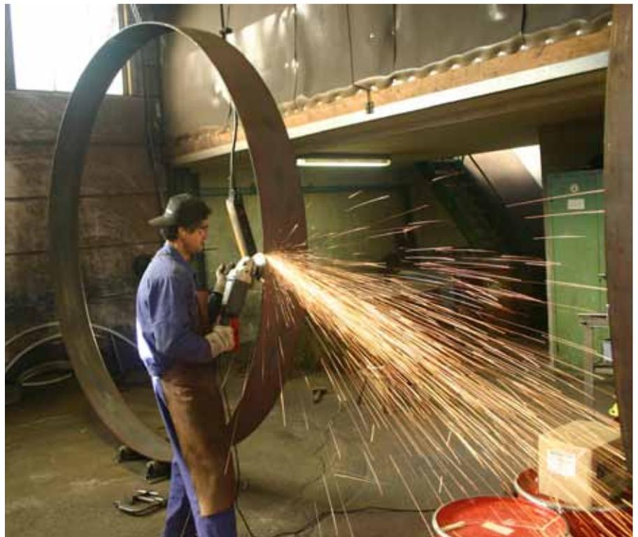
**Der Einsatz von Winkelschleifer kann den Arbeiter einer nicht zu unterschätzenden gesundheitlichen Gefahr aussetzen – durch Staubentwicklung, Funkenflug und die sehr schnell drehenden Scheiben. Deshalb ist Schutzausrüstung notwendig. Die dabei erzeugten Kanten können in Sachen Gleichmäßigkeit und Qualität stark variieren.**
