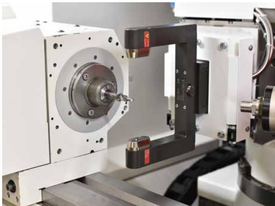
Am drehenden Werkstück tastet ein Laserstrahl das Werkstück viele tausend Mal ab, wodurch dessen präzises Maß ermittelt wird.
