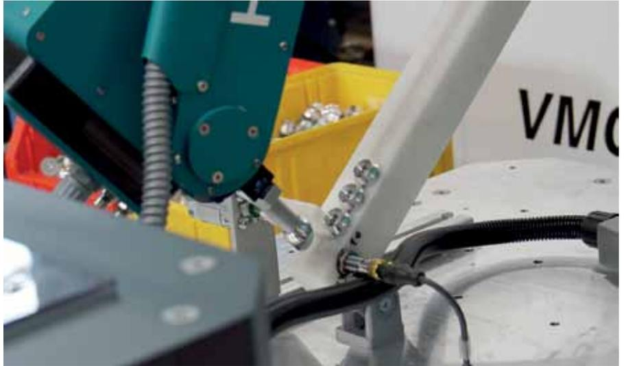
Horst nimmt das Endstück einer Rotationsdüse auf, platziert es auf der Aufnahme in der Fräsmaschine und schließt mit seinem Arm die Sicherheitstür der Maschine.
