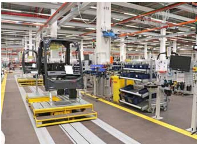
Für eine neue Staplergeneration, die bei Linde im Aschaffener ›Werk 2‹ gebaut wird, entwickelte Knoll zwei Vormontage-linien – für den Rahmen und das Fahrerschutzdach
