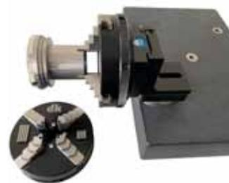
durch das Vierbackenfutter. Diese Lösung gibt es optional mit der standardisierten SWA39-Schnittstelle, die das Backenfutter an alle Schnellspannhalter, Aufbau- und Verstellelemente des dk-Baukastens adaptierbar macht. Eine integrierte Stiftbohrung und drei Sätze verschieden langer Stifte, ermöglichen das Halten des Werkstücks auch oberhalb der Backen. Die Backen lassen sich zudem werkzeuglos umkehren.
