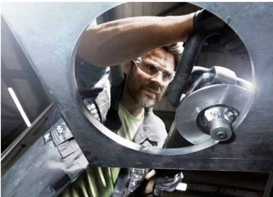
Kantenfräser wie das Trutool TKA 1500 von Trumpf lassen sich an geraden Kanten ebenso schnell und effizient einsetzen wie an gerundeten Innen- und Außenkonturen.
