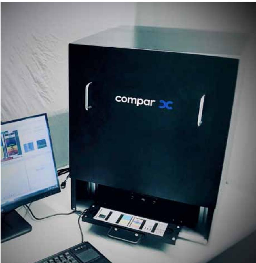
Beispiel für eine von Compar hergestellte Einheit zur separaten Qualitätskontrolle im Labor. Im Inneren befinden sich drei parallel angeordnete Kamerasysteme
