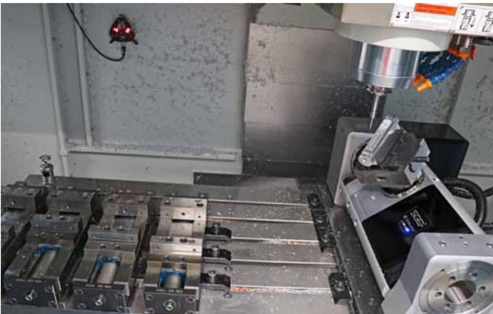
Die ›MTcut V130‹ ist ein Dreiachs-Vertikalbearbeitungszentrum, das mit einem CNC-Dreh-Schwenktisch von pL Lehmann ergänzt wurde. Daneben haben noch vier Schraubstöcke Platz.
