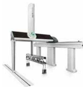
Opera geringer als bei üblichen Brücken-KMGs, womit sich die Kosten für eine Temperaturregelung reduzieren. Das leistungsfähige Delta Opera bietet eine Reihe an Verbesserungen beim Bedienkomfort, einschließlich Anzeigeleuchten für Gerätestatus und -geschwindigkeit sowie Hexagons Manuelle Taster-Wechseleinrichtung (MAC) für den bequemen, nahtlosen Wechsel von Tastköpfen.
