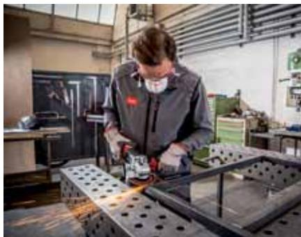
**Mit fixer Geschwindigkeit von 11500 U/min und kraftvollen 1200 Watt ist der handliche Winkelschleifer ›L 12-11 125‹ ideal für den harten Dauereinsatz.**
