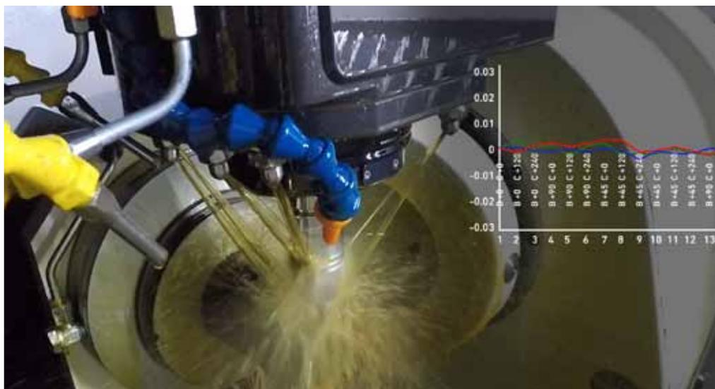
Der AMC-Zyklus besteht aus Soft- und Hardware, wurde intern entwickelt und ermöglicht es, eine Fräsmaschine der Mikron Mill S- oder X-Baureihe schnell und einfach zu kalibrieren.
