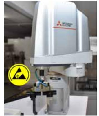
einem leitenden Speziallack beschichtet werden. Hierdurch sind sie, ebenso wie die Knickarmroboter, nachweislich ESD-konform und es können bei beiden Robotertypen ESD-Risiken in der Produktion ausgeschlossen werden. Die Geräte sind unter gesonderter Artikelnummer in ESD-fähiger Ausführung mit Zertifikat bestellbar.
