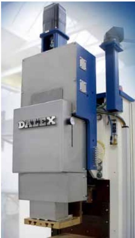
Der Elektro-Pneumatische Schweißantrieb von Dalex sorgt dank eines hervorragenden Nachsetzverhaltens für ausgezeichnete Schweißqualität.
