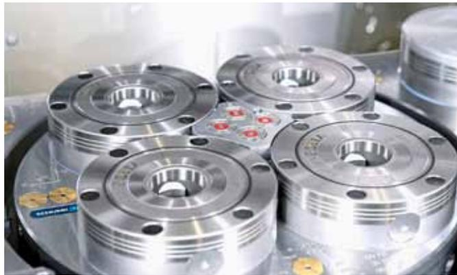
**Die Bauhöhen der Vero-5 NSE plus Nullpunktspanmodule und der anwendungsspezifischen Medienübergabe in der Mitte sind in dieser Anwendung exakt aufeinander abgestimmt.**
