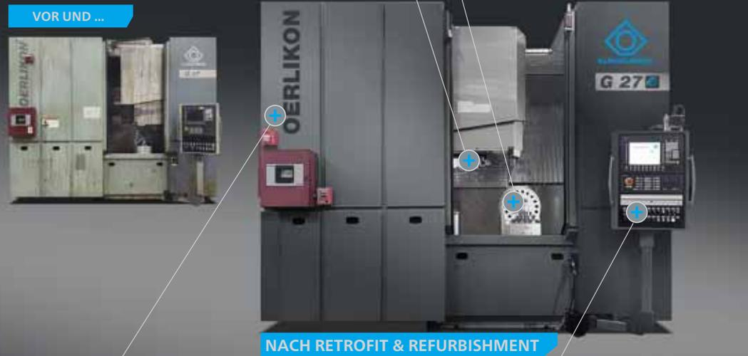
Retrofitpaket inkl. neuen Schaltschrank, Kabel, Motoren, Messsysteme und Sensoren – hohe Produktionssicherheit und reduzierte Ausfallwahrscheinlichkeit
