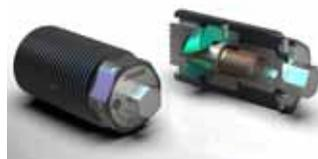
menten. Das selbsthemmende Keilspannsystem bietet einen Spannhub von bis zu 3 mm. Neben den Größen M36, M48, M64 und M80 bietet Jakob auch eine Sonderausführung SC 100 an. Bei ihr sind mit nur 130 Nm Anzugsmoment Spannkraften von bis zu 250 Nm erzeugbar.
