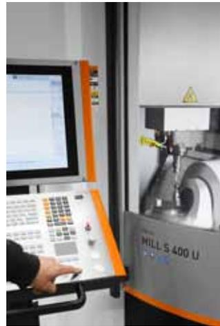
Mit der automatisierten Kalibrierfunktion ›AMC‹ von GF Machining Solutions ist das Kalibrieren der Maschine zur Gewährleistung einer stabilen, langfristigen Präzision so einfach wie ein Knopfdruck.
