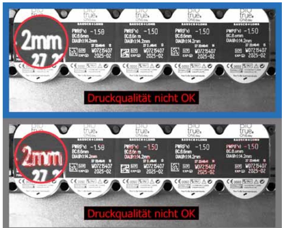
Eine Druckinspektionssoftware ohne Verzugkompensation (unteres Bild) wird immer falschen Ausschuss produzieren, ohne die echten Fehler zu finden. Compars Printinspektion (oberes Bild) kompensiert den Verzug.
