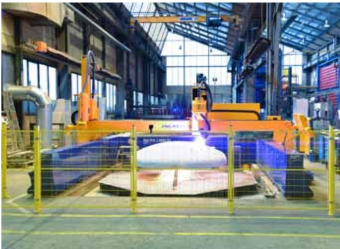
Die Baureihe ›MG‹ wurde für die präzise und flexible 3D-Bearbeitung von Blechen und Behälterböden ausgelegt.
