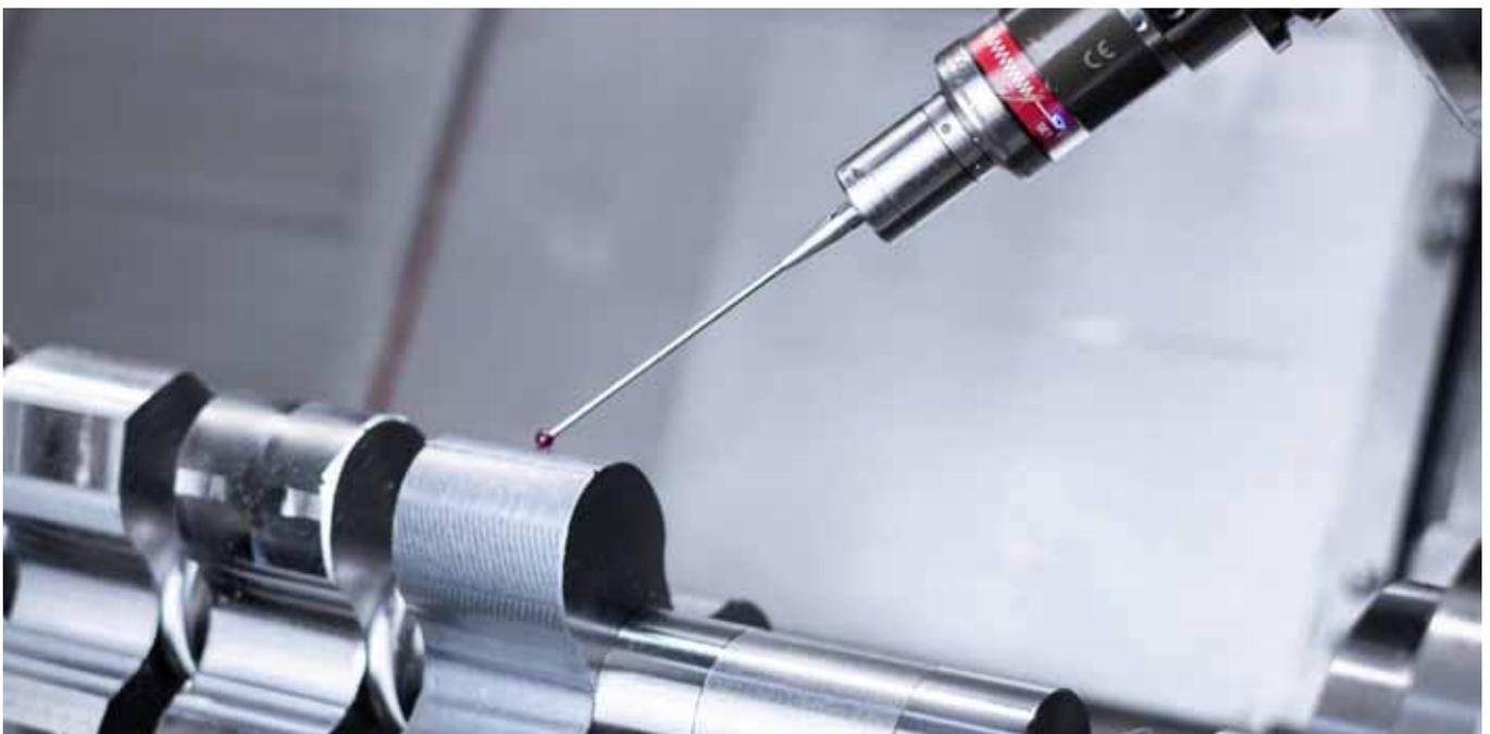
Der auf der ›M40 Millturn‹ eingewechselte Messtaster ›TC63-Digilog‹ auf der Oberfläche des gefrästen Rootsrotors. Der Digilog-Taster bewegt sich ›scannend‹ mit bis zu zwei Metern pro Minute und erzeugt so in kürzester Zeit tausende Messwerte.
