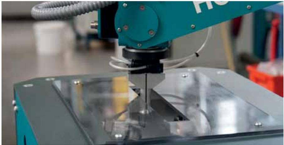
Zum Schluss wird die Komponente in die Druckluft-Reinigungsanlage mit Absaugung gehalten, wo sie mit hohem Druck von feinsten Partikeln und KSS gesäubert wird.
