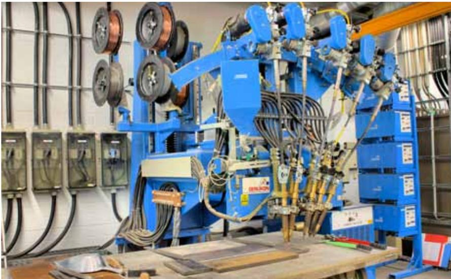
**Bis zu 300 Millimeter dicke Bleche sind problemlos per UP-Schweißen verbindbar. Mehrere Elektroden sorgen für raschen Schweißfortschritt.**
