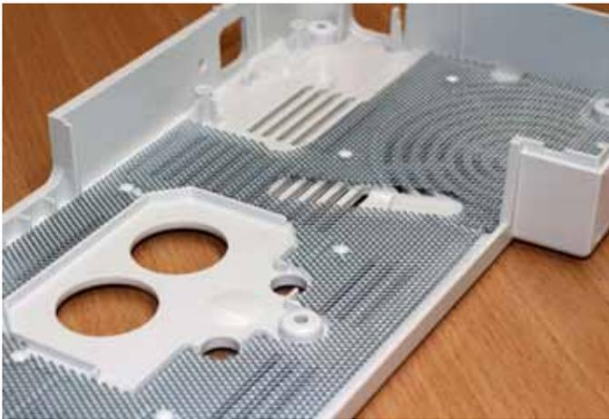
**Fixieren von metallischen Bauteilen:** Das Heißverstemmgerät erwärmt die Enden der an das Gehäuse angespritzten Bolzen und formt am Bolzenende einen Nietkopf, der das Blech fixiert.
