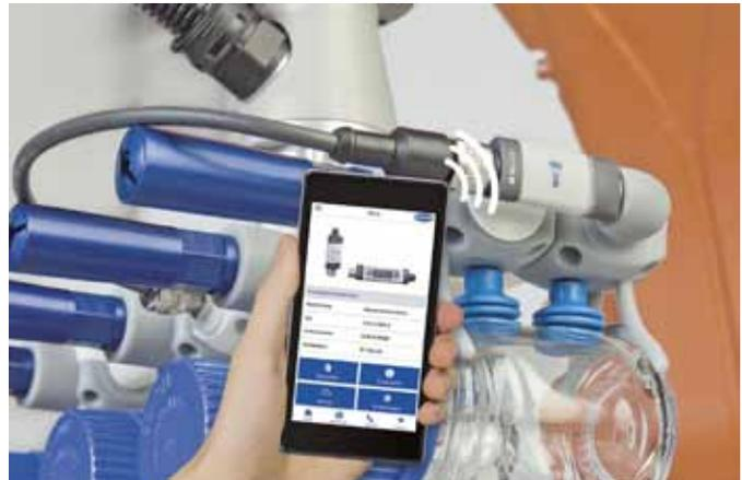
Vakuum-Komponenten von Schmalz gewähren dem Anwender via Smartphone oder Tablet einfachen Zugriff auf Service- und Wartungsinformationen wie Typ oder Seriennummer.
