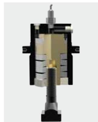
Mit diesem System wird eine hohe Betriebssicherheit gewährleistet, da die Spannkraft unabhängig vom Öldruck oder Leckageverlusten stets in voller Höhe erhalten bleibt. Durch die kurzen Betriebszeiten des Hydraulikaggregats bietet dieses System auch unter wirtschaftlichen Aspekten Vorteile.
