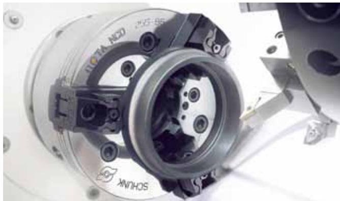
Pronto von Schunk senkt die Rüstzeit um bis zu 95 Prozent. Die Spanneinsätze lassen sich auch per Roboter wechseln.
