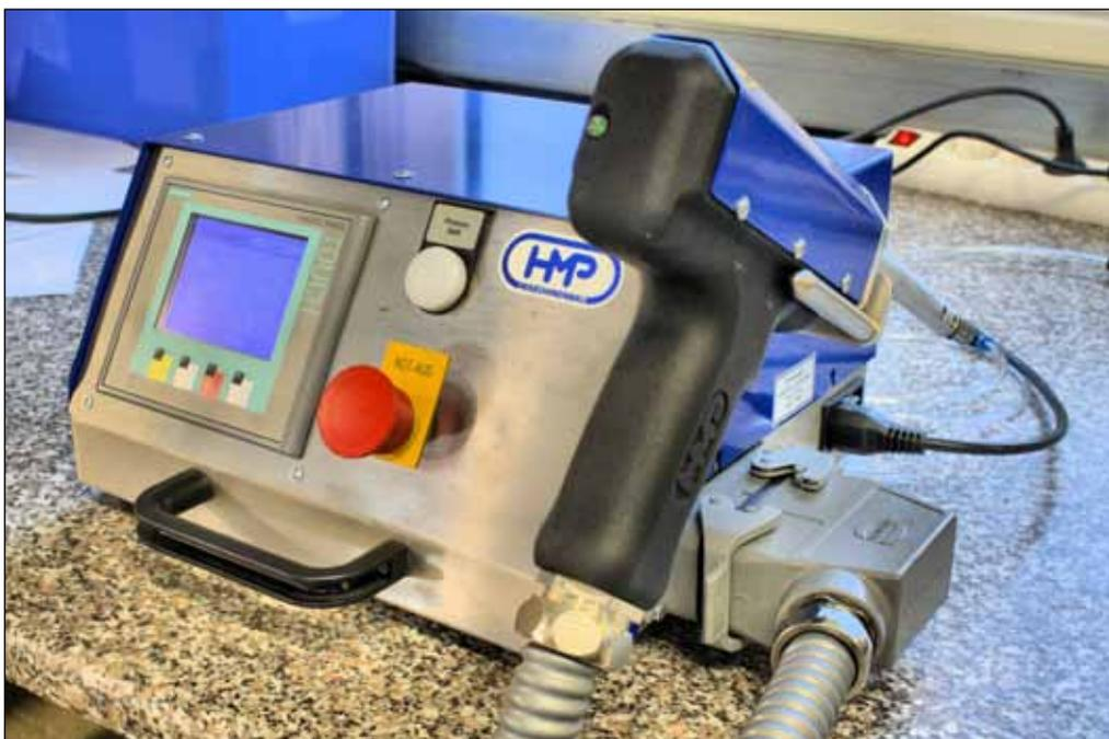
Mit Heißverstemmgeräten von HMP lassen sich Thermoplaste rasch in einen verformbaren Zustand bringen, um anschließend in jedes gewünschte Profil gebracht zu werden.
