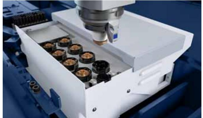
Der automatische Düsenwechsler mit bis zu acht Plätzen tauscht die Düse im Schneidkopf vollautomatisch.
