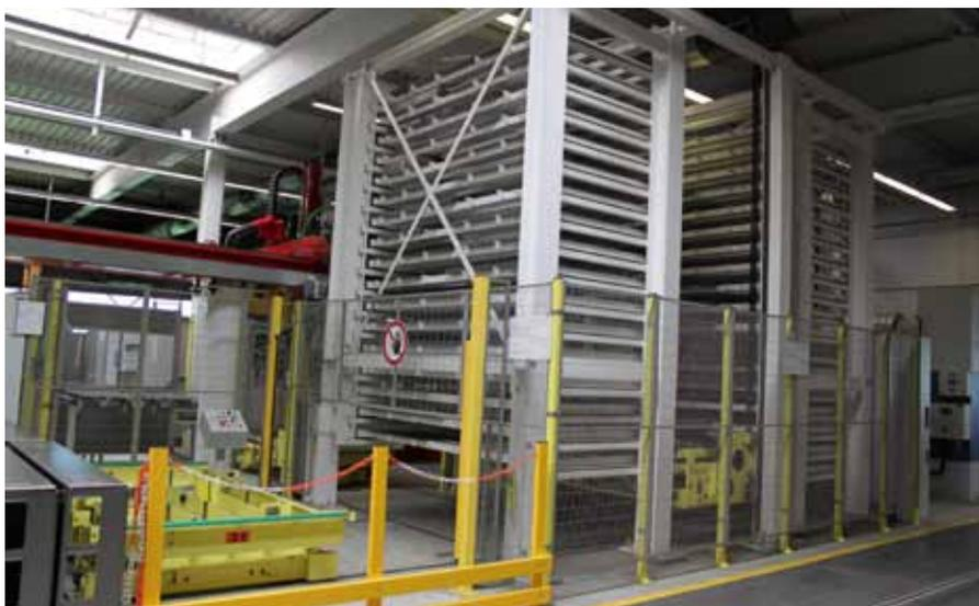
Das automatische Blechlagersystem ›Unitower‹ von Kasto ist als Doppel-Regalblock mit dazwischen verfahrenem Regalbediengerät ausgeführt und für insgesamt 35 Paletten-Lagerplätze ausgelegt.
