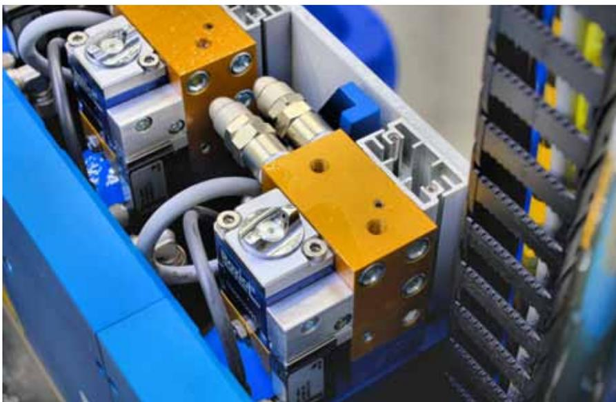
Kompakte, pneumatische Teleskopzylinder erlauben das Ein- und Ausfahren der Düsen. Auf diese Weise sind Bleche unterschiedlichster Breite problemlos beöhlbar.
