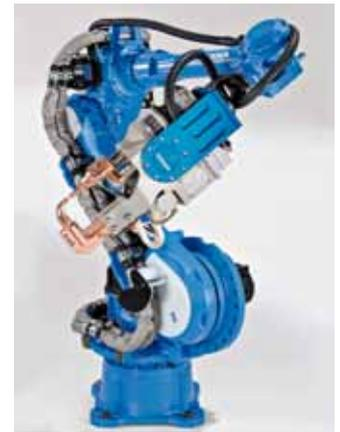
te Bauweise ermöglicht eine platzsparende Anordnung und eine hohe Roboterdichte in der Zelle. Mit 80 kg Tragkraft, einem maximalen Arbeitsbereich von 2236 mm und einer Wiederholgenauigkeit  $\pm 0,07$  mm ist der Motoman MS8oW optimal für Anwendungen in der Automobilindustrie geeignet.
