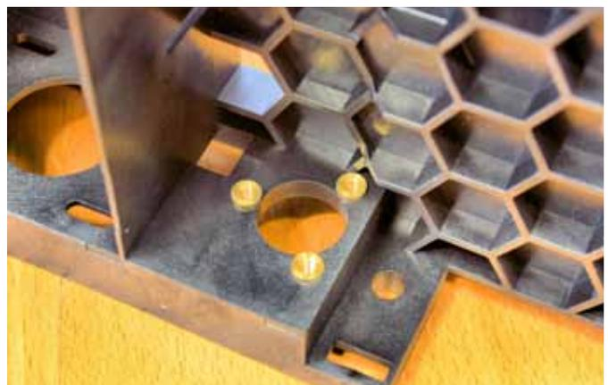
**Via Heißverstemmen sind Rändelmuttern selbst an beengten Stellen einbringbar. Ultraschall-Lösungen müssen hier passen.**
