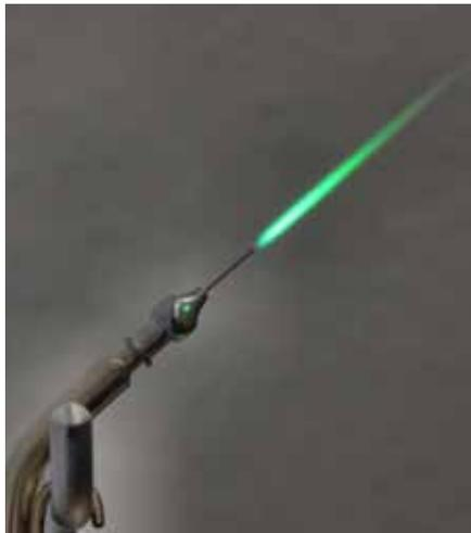
**Wird Gas durch einen mit Flussmittel gefüllten ›Booster‹ geleitet, wird die Flamme weicher und mit Flussmittel versetzt.**
