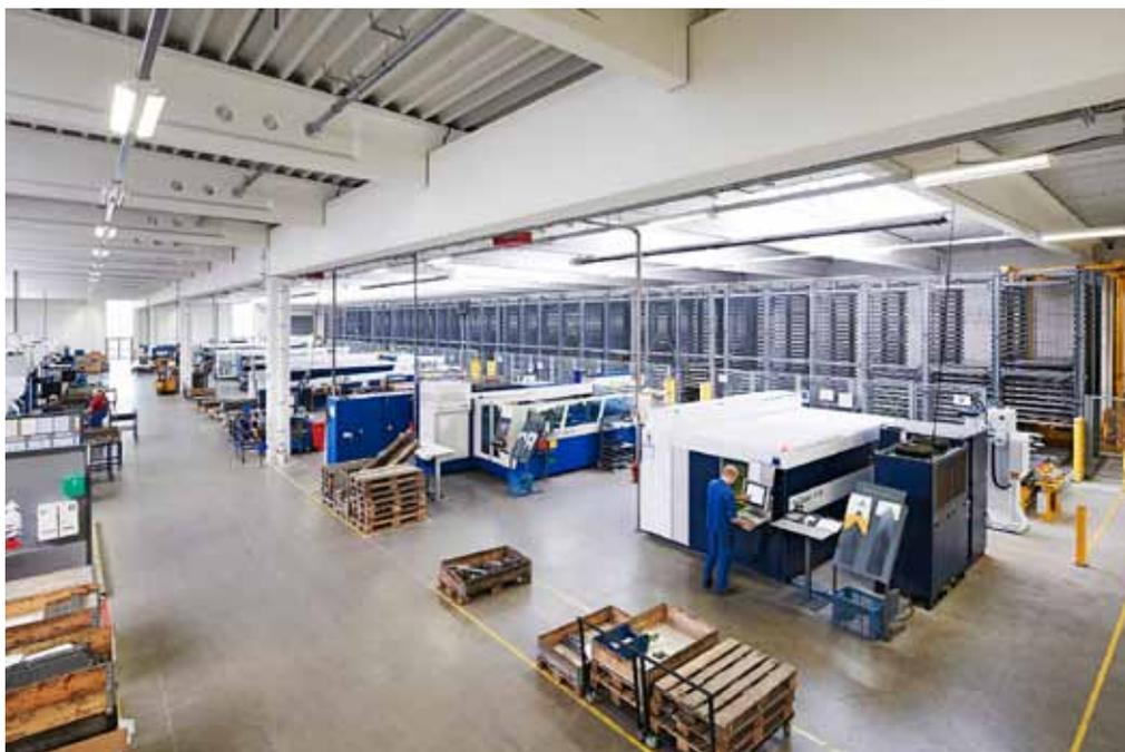
Um den vorhandenen Platz optimal auszunutzen, konzipierte Remmert das Blechlager in Längsbauweise. OMT kann dadurch bis zu acht Maschinen an das System anschließen.
