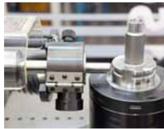
kurze Spindelabstand unterstützt das einfache Einlagern des zu prüfenden Werkzeugs oder Adapters optimal. Die Arbeitshöhe ist ideal ausgelegt und die obligatorische Schutzeinrichtung schließt sich automatisch über dem Arbeitsbereich. Sobald der Prüfling eingesetzt ist, läuft der gesamte Auswuchtprozess vollautomatisch ab. Das Ergebnis ist ein exakt ausgewuchtetes Werkzeug, das höchsten Anforderungen an die Präzision gerecht wird.
