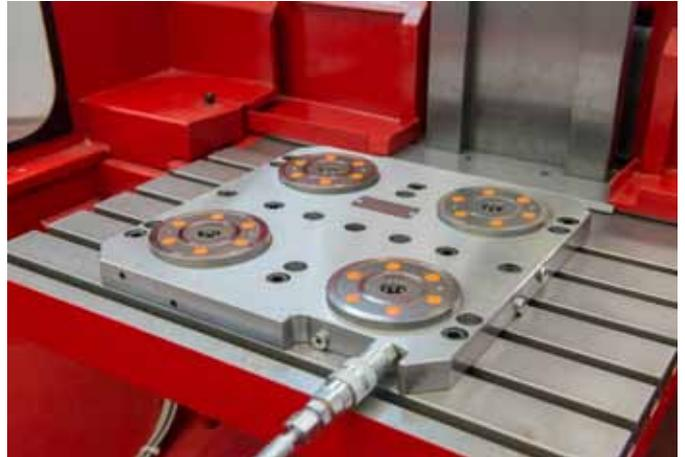
In der Standard-Grundplatte sind vier AMF-Nullpunktspannmodule »K 10.2« mit 22 Millimeter Einbautiefe verbaut.
