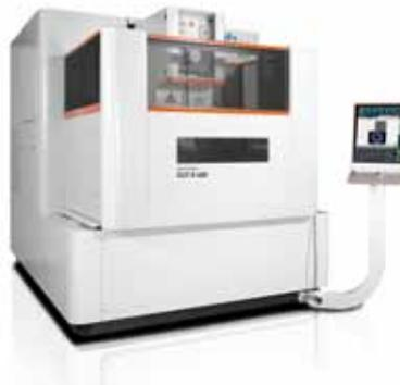
ierliche Produktion möglich. Die AC CUT HMI sorgt für ein leistungsstarkes Auftragsmanagement. Informationen über Geometrien, Verarbeitungsprozesse und Steuerprogramme werden in einer Datei verarbeitet. So ist ein Auftragstransfer zwischen den Maschinen der CUT E-Serie möglich.
