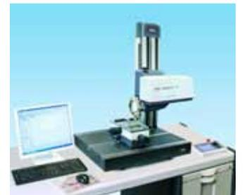
ein Vielfaches. Je nach Aufgabenstellung kommen Diamantspitzen mit 2µm- beziehungsweise 5µm-Radius für Rauheitsmessungen, Hartmetallschneiden mit 25µm oder Rubinkugeln für Konturmessungen zum Einsatz. Dank der magnetisch gehaltene Tastarme und der optionalen Tastarmwechseleinrichtung, die das vollautomatische Tauschen der Tastarme ermöglicht, ist das System für vollautomatische Messungen geeignet.
