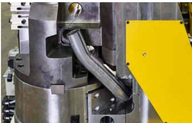
**Das neue Biege-Hackwerkzeug reduziert den Materialverschnitt um bis zu 90 Prozent und verkürzt die Produktionszeiten.**
