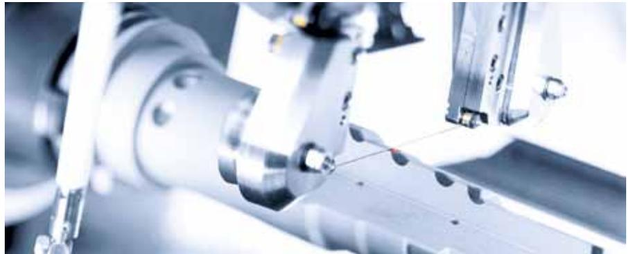
Beim Erodieren gewährleistet ein feiner Draht die akkurate Bearbeitung von PKD-bestückten Werkzeugen.
