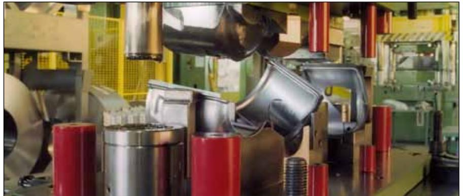
Die Berthold Kunrath GmbH produziert komplexe Blechteile, vorwiegend aus Edelstahl, die zum Beispiel in Schalldämpfern und Katalysatoren verbaut werden.
