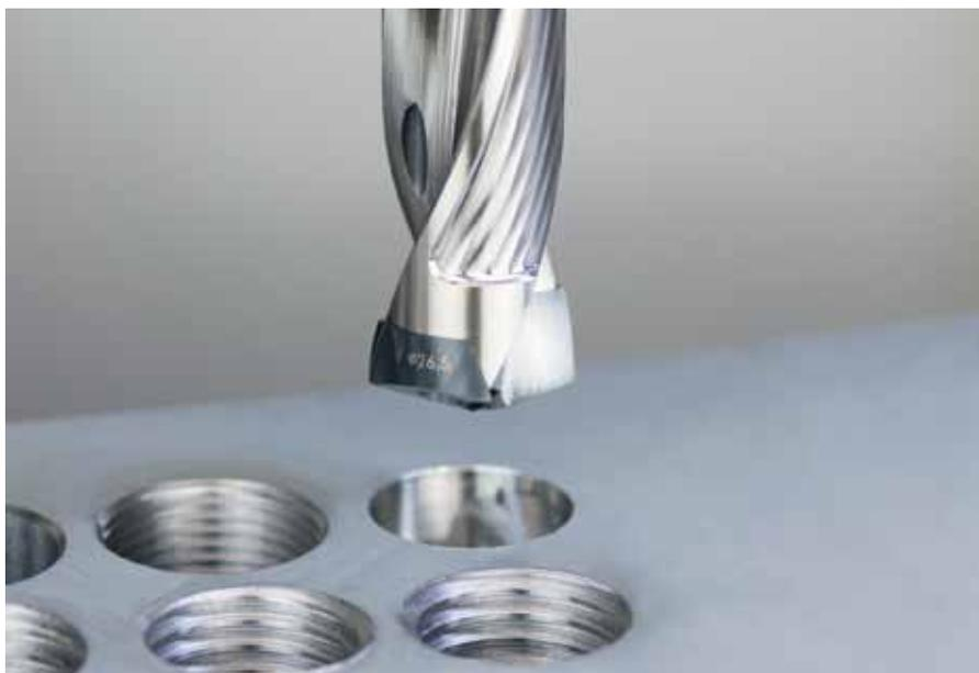
ist in seiner Schneidengeometrie eine Weiterentwicklung der Vollhartmetall-Spiralbohrer ›EF-Drill‹, wurde aber in seiner Eigenzentrierfähigkeit verbessert. Das ermöglicht höchste Bohrungsgenauigkeiten für die Gewindekernlochherstellung, insbesondere auch beim Gewindeformen. Zur hohen Präzision trägt auch die form- und kraftschlüssige Auslegung
