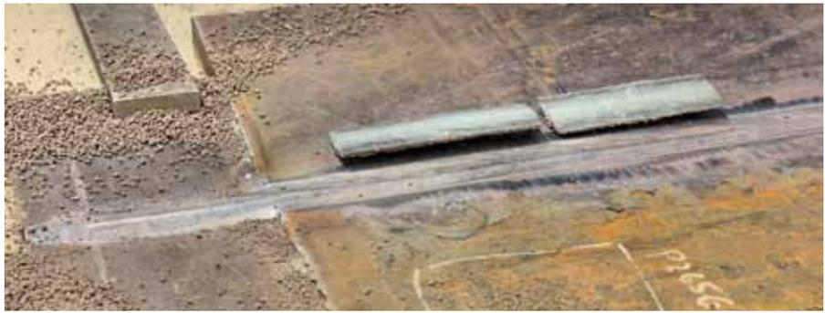
**Das Unterpulverschweißen kann mechanisiert oder automatisiert ablaufen. Es ist das optimale Verfahren, um besonders dicke Bleche in kürzester Zeit zu verschweißen.**
