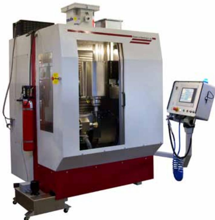
Ideal für die fünfachsigem Bearbeitung sprödharter Materialien: die Dama Ultraschall-Schleifmaschine ›USG 500‹, die mit einem CNC-Rundtisch von pL Lehmann aufwartet.
