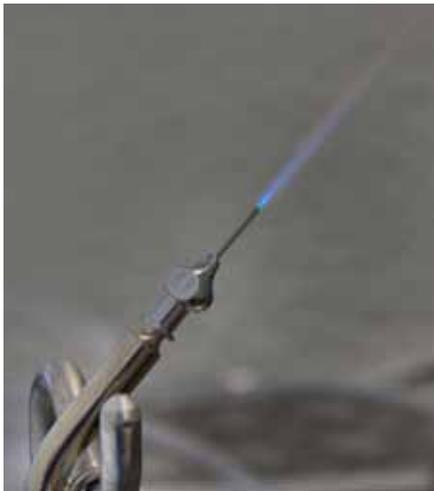
**Bis zu 2860 Grad Celsius erreicht eine Wasserstoff-Flamme. Deren nur geringe Größe ist ideal für kleine Werkstücke.**
