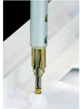
**Mit wenig Druck wird eine erwärmte Rändelmutter in einen thermoplastischen Kunststoff eingebracht.**
