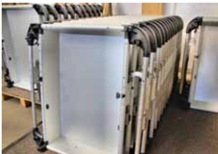
Eine einteilige, robuste Wanne aus 1,5 Millimeter dickem Aluminiumblech bildet die Basis der Fahrradanhänger.
