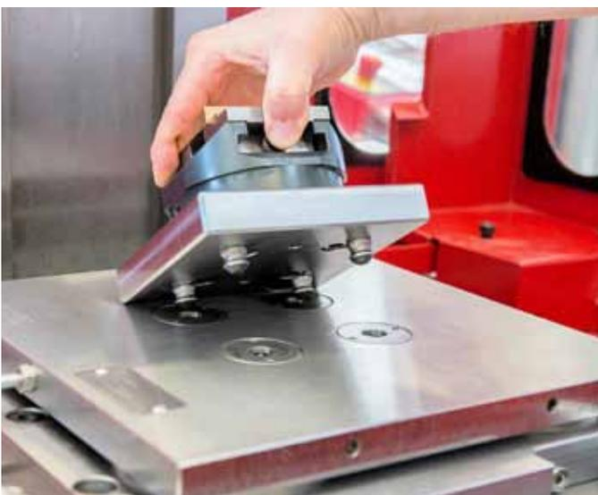
Auf der Grundplatte sitzt eine Sonderplatte mit vier AMF-Nullpunktspannmodulen vom Typ »K 5«.
