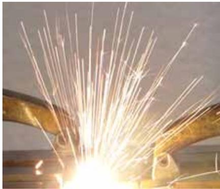
Grundsätzlich entstehen beim thermischen Fügen von Stahl an Aluminium spröde intermetallische Phasen, sodass es unter Belastung zu einem frühzeitigen Versagen der Verbindungen kommt. Die Eigenschaften der Schweißnähte lassen sich jedoch durch das Mischungsverhältnis der Metalle beziehungsweise die Einschweißtiefe optimieren. Bei erfolgreicher Entwicklung kann der Prozess natürlich auch für andere großbauteilige Branchen, etwa für den Waggon- oder den Nutzfahrzeugbau, interessant werden.
