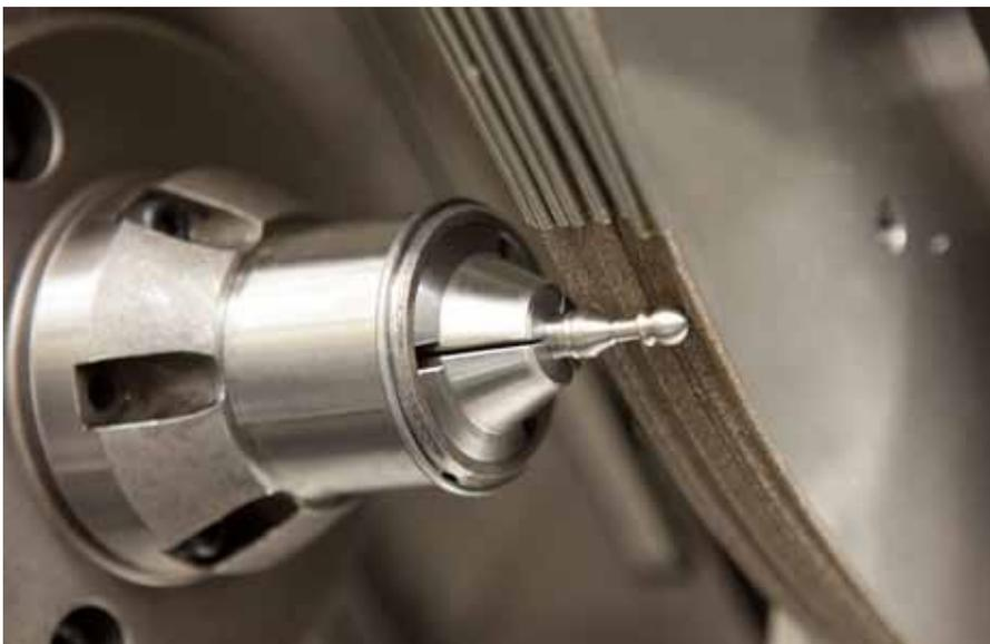
Der Einsatz einer Profilscheibe erlaubt das Einstechschleifen der gesamten Werkstückkontur und ermöglicht dadurch eine extrem kurze Bearbeitungszeit.
