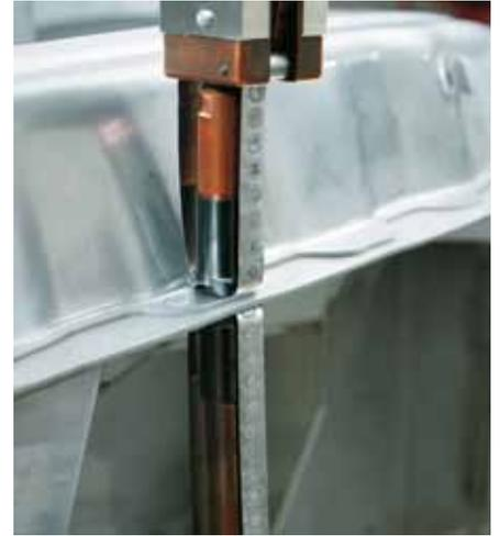
**DeltaSpot bietet: 50 Prozent Energieeinsparung, weniger Schweißspritzer sowie exakt reproduzierbare Schweißpunkte.**
