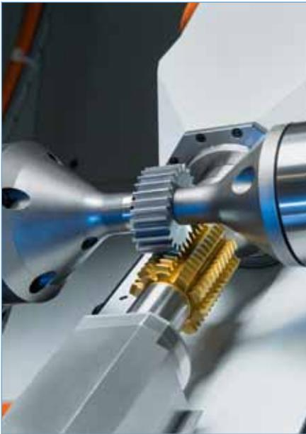
Mit dem innovativen Modell »160« hat die Emag-Tochter »Koepper« eine Wälzfräsmaschine im Portfolio, die dank einer besonderen Software problemlos sogar ovale Zahnräder fräsen kann.
