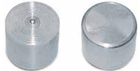
Drehmaschinen lassen oft einen Butzen in der Werkstückmitte stehen (links). Die Grindstar vermeidet dies (rechts).
