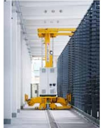
Ein Regalbediengerät ermöglicht die Ein- und Auslagerung von Blechen und Boxen.
