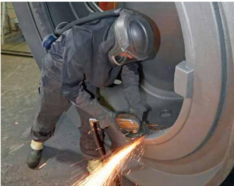
Für schwere Entgratarbeiten werden die 4,5 Kilowatt starken GTG-40-Turbinenschleifer von Atlas Copco eingesetzt. Sie sind mit 230- und 180-mm-Schleifmitteln bestückt.
