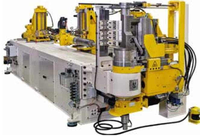
**Biegen und Trennen von Rohrkomponenten in einem Arbeitsschritt ermöglicht die Lösung von Schwarze-Robitec.**
