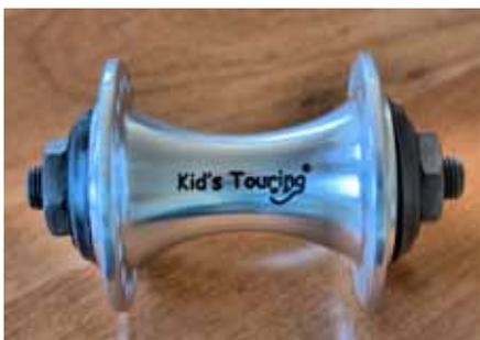
Das verwendete Nabenlager ist nicht mit einem Gleitlager, sondern mit hochwertigen Kugellagern versehen.
