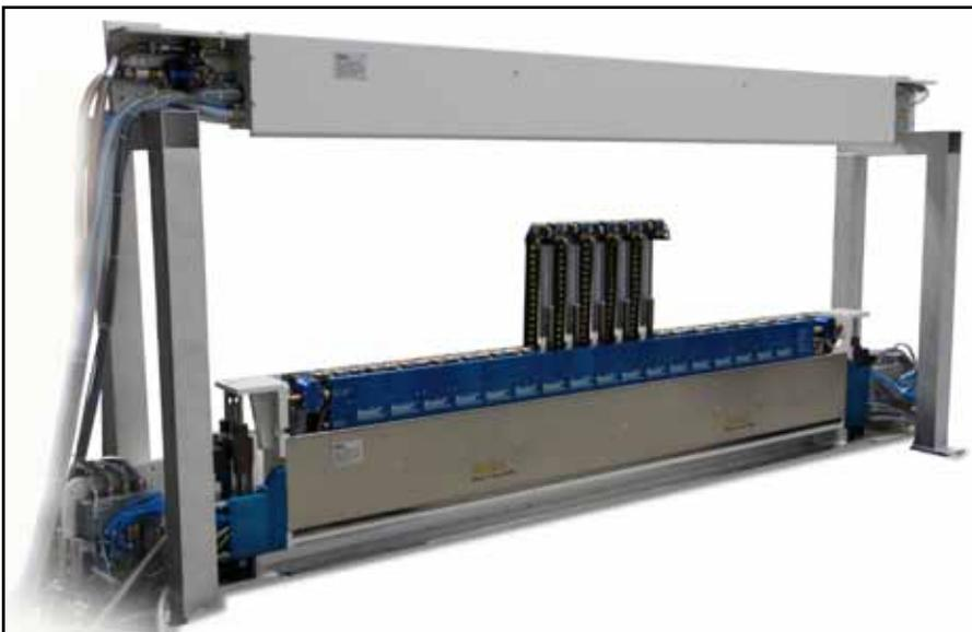
Die neue Sprühbeölungsanlage ›SA KS PP 1900 38-100 To M1‹, von Raziol baut besonders schlank und ist daher ideal für das Retrofit von Pressenanlagen mit wenig Platz.
