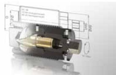
M80 wird auch eine Sonderausführung »SC 100« angeboten. Bei ihr können mit nur 130 Nm Anzugsmoment Spannkraften von bis zu 250 Nm erzeugt werden. Bedient wird die Kraftspannschraube mit einem 14 mm Innensechskantschlüssel.
