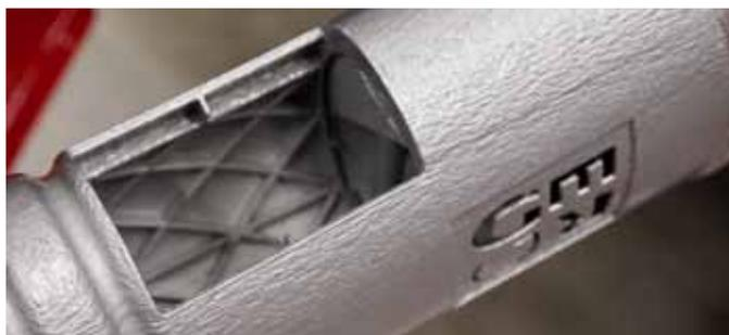
Die Oberflächengüte von 3D-Druck-Bauteilen ist vergleichbar mit der von Druckgussbauteilen. Bis die optische Oberflächenqualität für Einsätze bei Außenhautanwendungen reicht, wird vermutlich noch viel Zeit vergehen.
