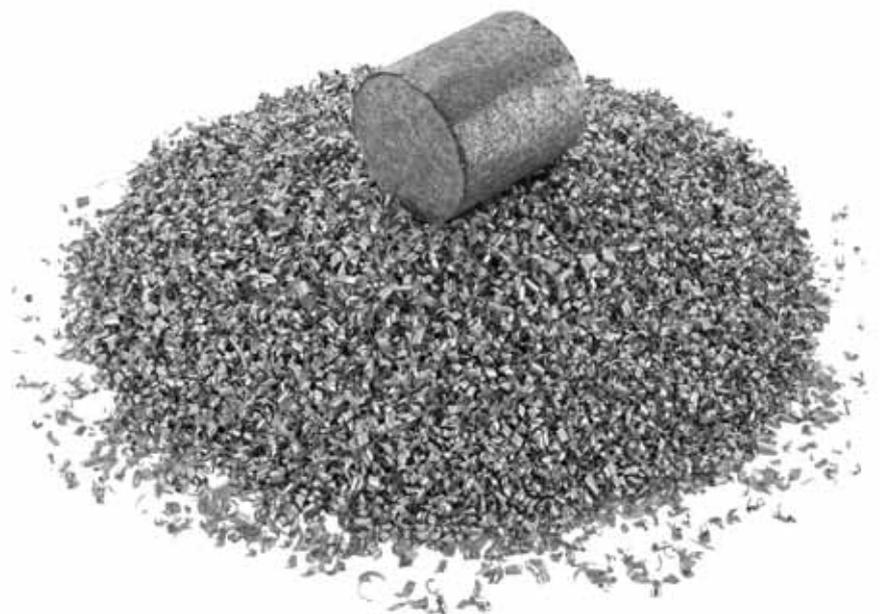
Seit 2001 komprimiert die kompakte Anlage von Ruf bei ZF Gusstechnologie zuverlässig Aluminiumspäne zu Briketts.
