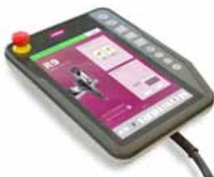
entkoppelt werden. Der programmierte Ablauf kann visualisiert werden. Basierend auf der Programmierung generiert die Steuerung eine virtuelle Arbeitszelle, in die gezoomt werden kann, wobei die Perspektive frei wählbar und jederzeit änderbar ist. Diese digitale Kopie der tatsächlichen Arbeitszelle verfügt über dieselben Ausstattungsmerkmale und Charakteristika wie
