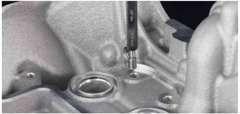
Das mittels PunchTap hergestellte Gewinde bietet eine ähnliche Festigkeit, wie sie klassische Gewindeformer erzeugen. Zudem sind die Gewinde absolut maßhaltig.
