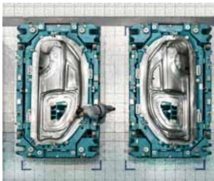
**Im Audi-Kompetenzcenter entstehen Presswerkzeuge für Türen, Motorhauben und die Seitenteile der Fahrzeuge.**
