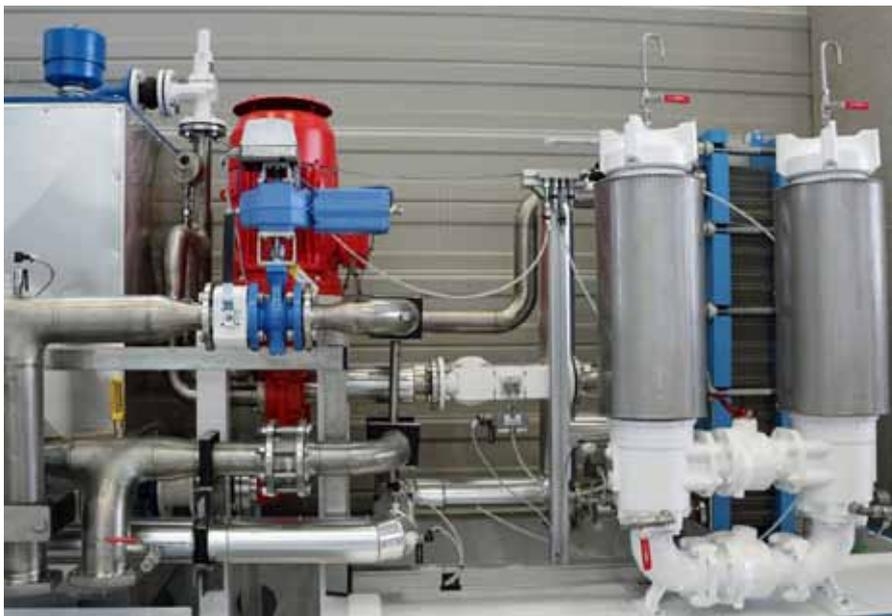
Das Schmieraggregat für den Prüfstand versorgt dessen „steifigkeitsvariable“ Lageranordnung mit der optimalen Schmierung.
