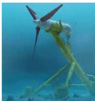
erhöhter Korrosionsgefahr. Um solchen Bedingungen trotzen zu können, sind seetaugliche Dichtungen erforderlich, wie sie bei der SKF Marine GmbH in Hamburg entwickelt und hergestellt werden. Für die Hauptwelle zum Rotor wurden deshalb besonders robuste Gleitringdichtungen vom Typ »Carboplan Tidal« eingesetzt. Im Testlauf erzielte MeyGen mit 700 Megawattstunden einen neuen Weltrekord für diese Art von Gezeitenkraftwerken, obwohl nur zwei der insgesamt vier Turbinen in Betrieb waren.
