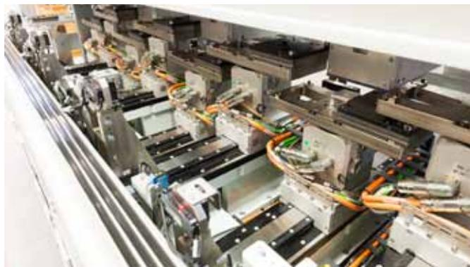
Die Aufteilung in acht Parallelprozesse erhöht die Bestückungsfrequenz und erleichtert die Entstörung. So wird eine Bestückungsfrequenz von 600 Federn pro Minute erreicht.
