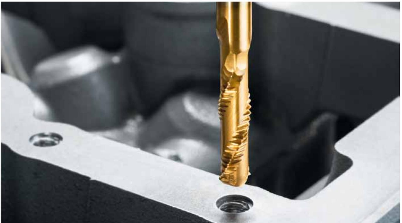
Der PunchTap-Gewindeformer von Emuge besitzt ein innovatives Profil. Das dadurch mögliche, neuartige Verfahren überrascht mit einem im Vergleich zum herkömmlichen Gewindeformen völlig anderen Bewegungsablauf, was satte Zeiteinsparungen ermöglicht.
