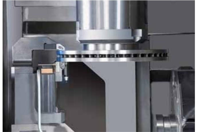
Die Feinbearbeitung der Reibringflächen erfolgt durch parallele Bearbeitung beider Flächen mit einem Abhebestahlhalter.
