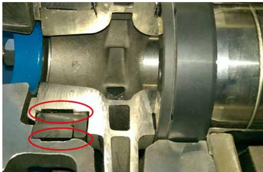
Anwendung in einer Kreiselpumpe: Um unterschiedliche Wärmeausdehnungen von Edelstahl und Siliziumkarbid im Bereich der Gleitlager der Pumpe auszugleichen, werden Toleranzhülsen als Verbindungselement eingesetzt.
