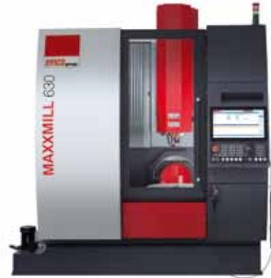
Die ›Maxxmill 630‹ von Emco ist das ideale Vertikalfräszentrum für die Fünfseitenbearbeitung von Werkstücken.
