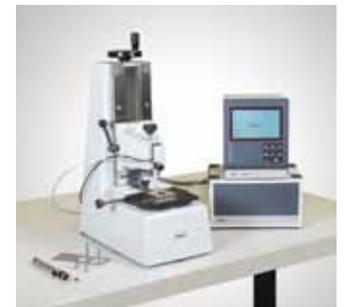
Messtisch ist mit verschleißfesten Hartmetalleisten ausgelegt, die ein reibungsarmes Verschieben der Endmaße ermöglichen. Bei der Messung werden nacheinander ein Messpunkt auf dem Normal und fünf Messpunkte auf dem zu prüfenden Parallelendmaß angefahren und gemessen. Der Messplatz bietet eine hohe Messunsicherheit von  $MPEE_1(0,03 + L/3000)$  µm und eine Wiederholbarkeit von  $\pm 0,01$  µm.
