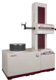
Das System ist ab Werk ausgerüstet mit einem automatischen Ausrichttisch mit vollautomatischer Zentrier- und Nivellierfunktion. Hochpräzise Glasmaßstäbe minimieren Positionierungsfehler und schnelle Verfahrbewegungen der Achsen reduzieren die Gesamtmesszeit vom Einrichten bis zum Messen. Das System wird von der Roundpak V7.4-Software gesteuert. Sie bietet Teileprogrammerstellung ebenso wie Einzelmessfunktionen.
