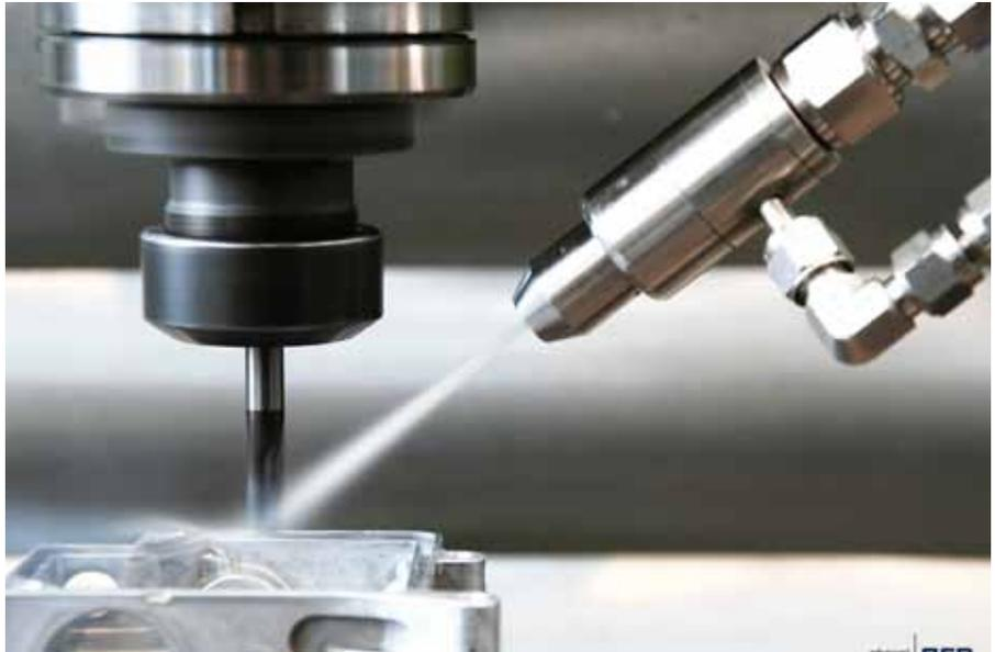
Die Zweistoffringdüsen-Technologie sorgt für einen konstanten Druck, der eine Vereisung der Düse verhindert und eine gleichbleibend gute, externe Kühlung sicherstellt.
