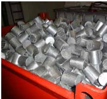
**60 mm Durchmesser weisen die Aluminiumbriketts auf, die von der Presse erzeugt werden.**
