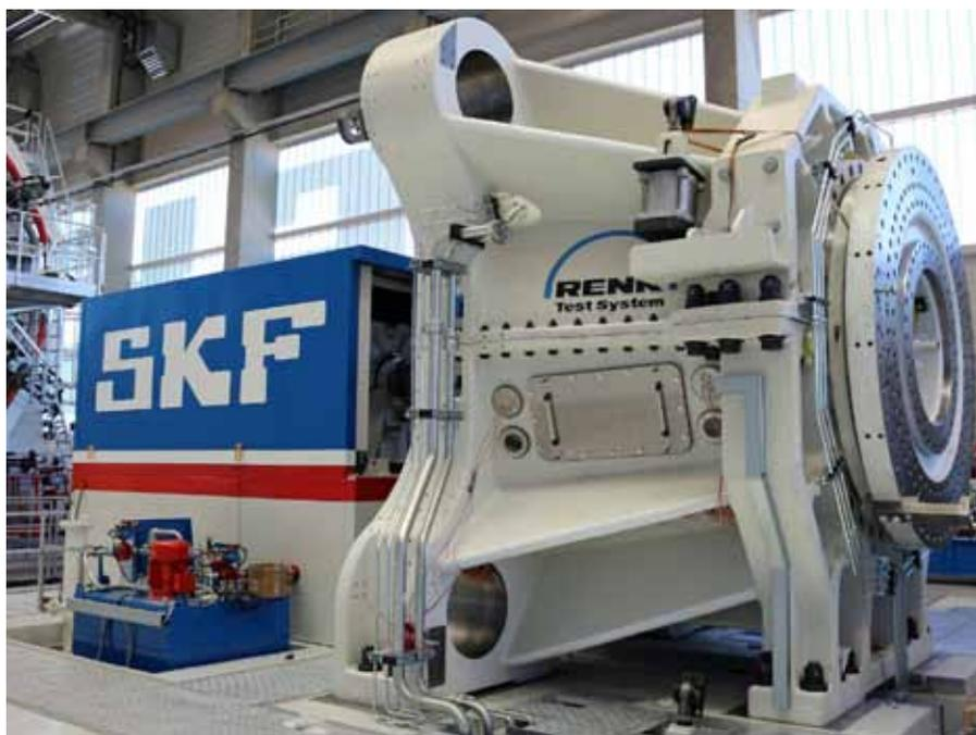
Der neue SKF-Prüfstand für Großlager in Anwendungsbereichen wie dem Schiffbau, dem Bergbau, der Zement- und Stahlbranche oder auch der Papierindustrie entwickelt Kräfte von gut einem halben Dutzend Meganewton und kann dabei Rotationsgeschwindigkeiten von über 200 min<sup>-1</sup> erzielen.
