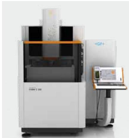
lässt und sich andererseits bei der Fertigbearbeitung feinste Oberflächendetails erzielen lassen. Dank der speziell entwickelten Technologien der Agiecharmilles Form S 350 werden die Mikrobearbeitungsprozesse gleichzeitig optimiert, sodass sie weniger Elektroden verbrauchen, wodurch sich die Rentabilität erhöht. Darüber hinaus steigt die Nutzungsdauer der Multi-Pitch-Elektroden bei gleichzeitiger Wahrung der Detailgenauigkeit.
