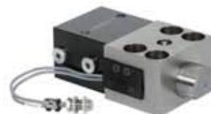
zylinder und einem gehäusegeführten Bolzen mit einer Kontaktfläche, die um 20 Grad abgewinkelt ist. Für zusätzliche Sicherheit sorgen eine Stufe in Form einer „Nase“ am Spannbolzen und ein entsprechender Adapter am Werkzeugspannrand. Kommt es am Pressenstößel aus irgendeinem Grund zum Druckabfall, senkt sich das Oberwerkzeug auf die Sicherheitsstufe ab und bildet mit dem Adapter einen Formschluss, durch den Bolzen und Werkzeug fixiert werden.
