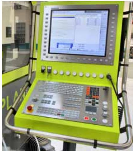
**Als Steuerung ist die »CNC 31i« von Fanuc, die »840 D PL« von Siemens oder die »iTNC 530« von Heidenhain zu haben.**
