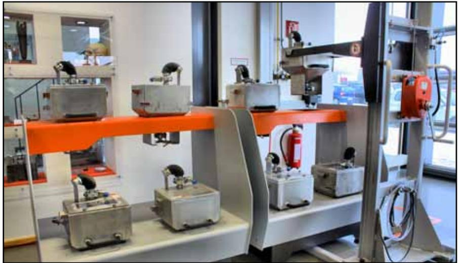
Von Concept Laser gibt es eine Wechsellösung, die es in kurzer Zeit erlaubt, deren Laserschmelzanlagen auf eine andere Pulversorte umzurüsten.
