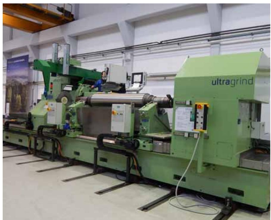
Die Walzenschleifmaschine ›Ultra-grind 700 R‹ der Heinrich Georg Maschinenfabrik kann mit konventionellen oder mit CBN-Schleifscheiben ausgerüstet werden.
