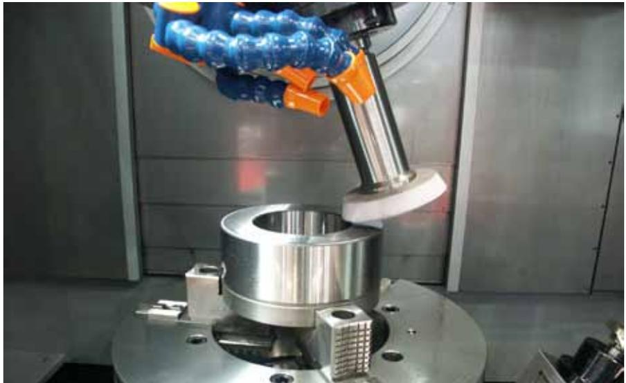
Okamotos Schleifmaschinen sind mit Vorschubgeschwindigkeiten von  $20.000 \text{ mm/min}$  im Quer- sowie Längsvorschub nicht nur schnell, sondern auch äußerst präzise.
