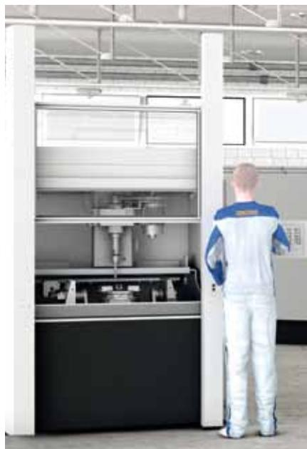
etwa die Kontaktleiste, oder der Sicherheitslichtvorhang, entsprechen mindestens Performance Level D nach DIN EN ISO 13849-1 und erfüllen die geltenden Normenanforderungen umfassend. Zusätzliche Sicherheit gewährt die Behinderungserkennung durch die statische Kraftbegrenzung an der Hauptschließkante.
