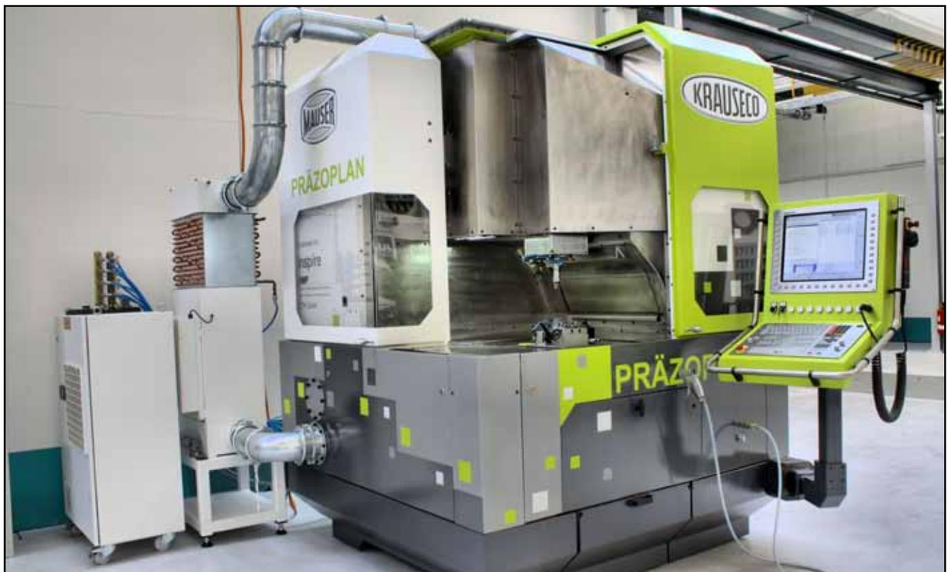
Luftlagerung und Thermokzept sind die Basis, die es dem ›Präzoplan‹ von Mauser erlauben, spiegelnde Oberflächen zu fräsen. Zusammen mit einer Hochleistungsspindel von Diebold kann diese Maschine Oberflächen mit einer Rauheit von nur  $R_a$  1,5 nm fräsen.
