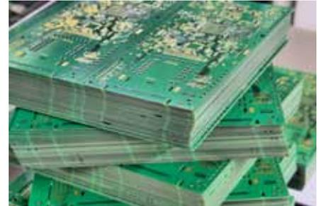
Die für die Geräte genutzten Platinen sind bis zu sechs Mal unterteilt.
