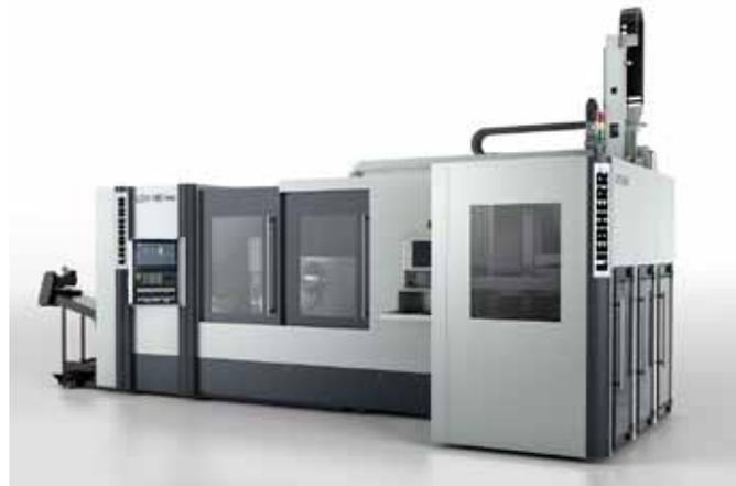
Die Wälzfräsmaschine ›LCH 180 two‹ von Liebherr beherrscht das Drückentgraten zwischen den Schnitten.
