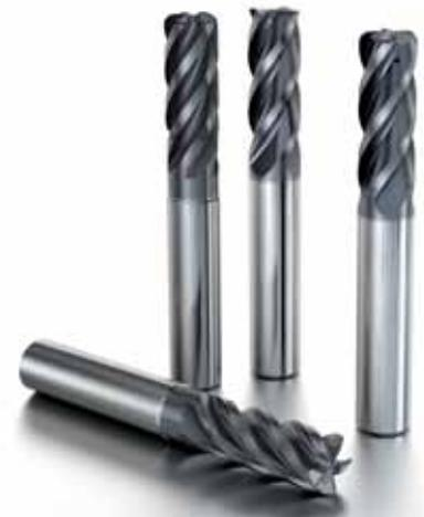
eine für alle Bedingungen, vorzugsweise für die Trockenbearbeitung; die andere für schwierige Bedingungen und lange Eingriffszeiten bei der Nassbearbeitung. Die Stirngeometrie wurde für anspruchsvolles Eintauchen optimiert. Weitere Merkmale sind Differentialteilung sowie eine Stützphase – so können Vibrationen minimiert und eine zuverlässige Schruppbearbeitung gewährleistet werden.
