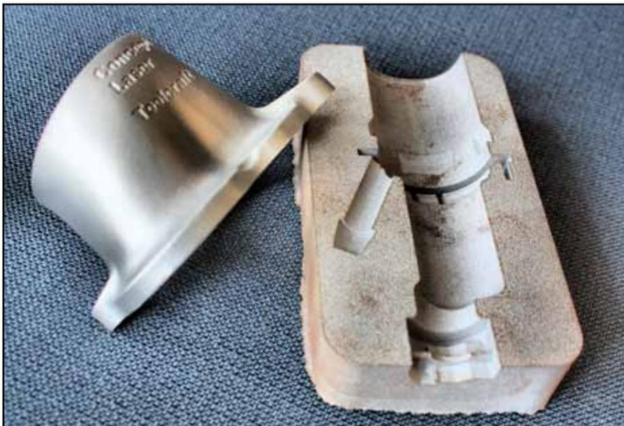
Metallpulver konnte Anfangs nur unzureichend verbunden werden, wie man an der körnigen Struktur des rechten Werkstückes sieht. Den Stand der Technik präsentiert das linke Werkstück mit seiner feinen Oberfläche und seiner hohen Festigkeit, die den echten Praxiseinsatz erlaubt.
