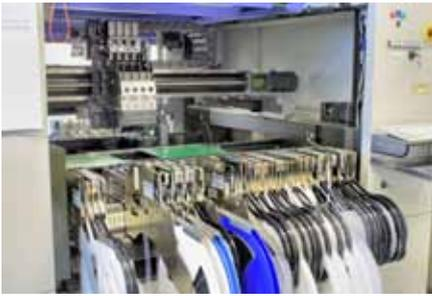
Mit modernsten Bestückungsautomaten werden SMD-Bauteile vollautomatisch auf die Platinen aufgebracht und in einer nachfolgenden Anlage verlötet.
