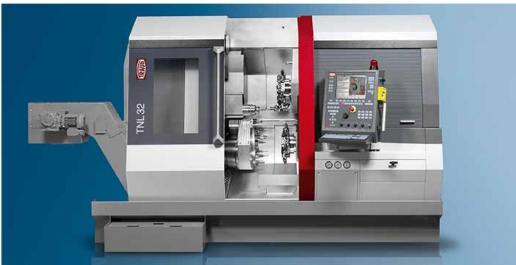
**Die Traub TNL32-11 ist eine Lang-/Kurzdrehmaschine mit zwei Revolvern und dreiaxsig verfahrbarem Frontapparat. Es können drei Werkzeuge simultan und unabhängig im Eingriff sein.**
