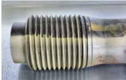
**WJT entfernt Oxidationen, ohne die Oberfläche des Teils zu beschädigen.**
