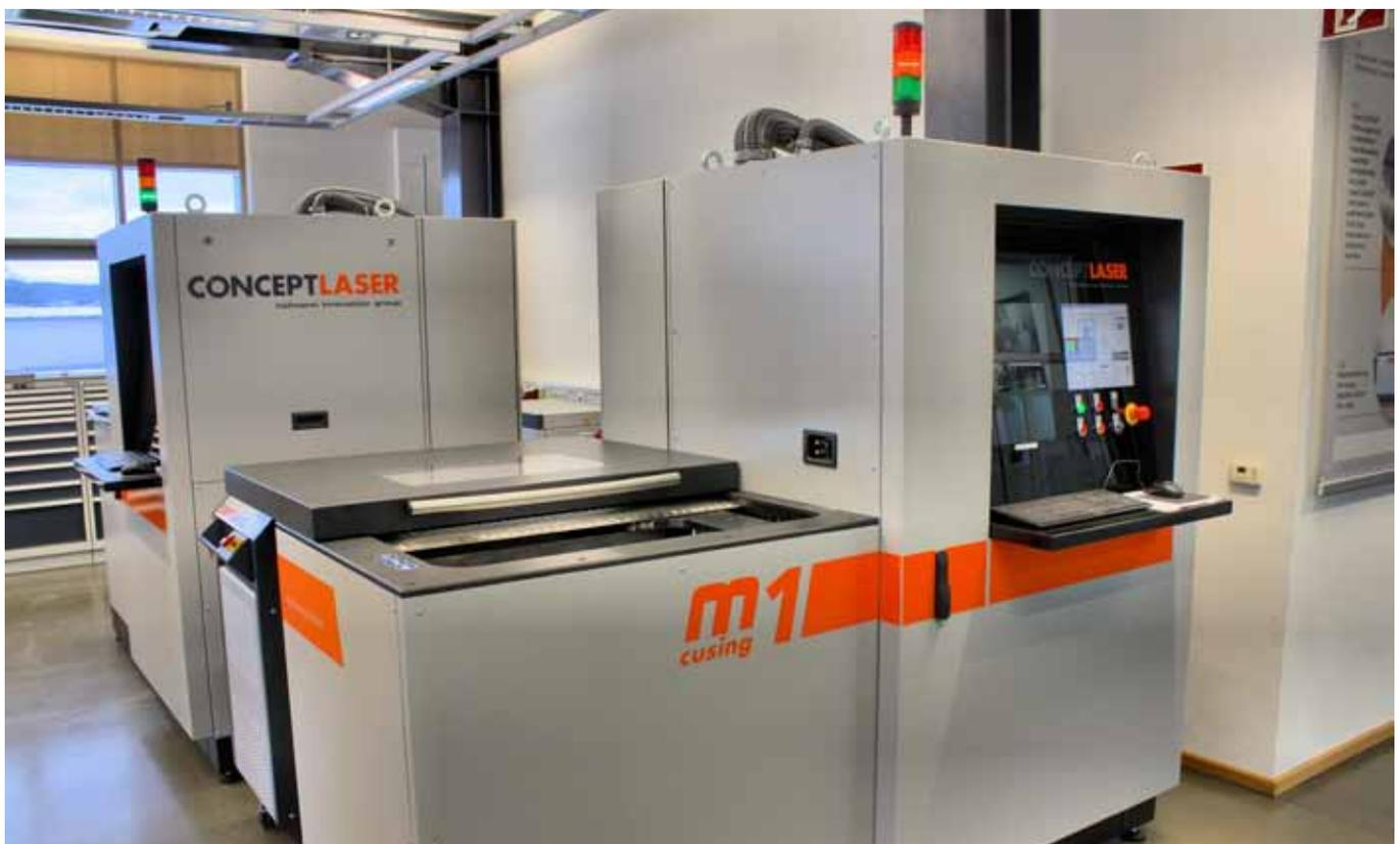
Die Laserschmelzanlage ›M1 cusing‹ von Concept Laser besitzt auf der rechten Seite einen 250x250x250 mm großen Bauraum. Fertige Teile werden automatisch in die links angebrachte Entnahmestation transportiert, wo sie bequem entnommen werden können.
