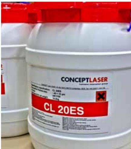
Zum Laserschmelzen wird Metallpulver verwendet. Das spätere Werkstück ist ähnlich belastbar wie Teile, die aus Vollmaterial hergestellt wurden.
