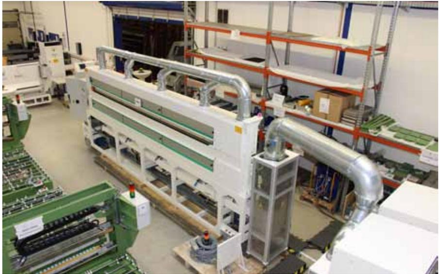
Die Raziol-Sprühanlage ›SA-SLS PP4300 86-100 To M1‹ besitzt eine Befettungsbreite von 4,30 Meter und ist daher ideal für große Bleche geeignet.
