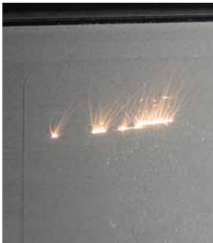
Mit einem gepulsten Faserlaser wird punktweise das Metallpulver zum Schmelzen gebracht, das sich daraufhin mit dem unteren Material fest verbindet.
