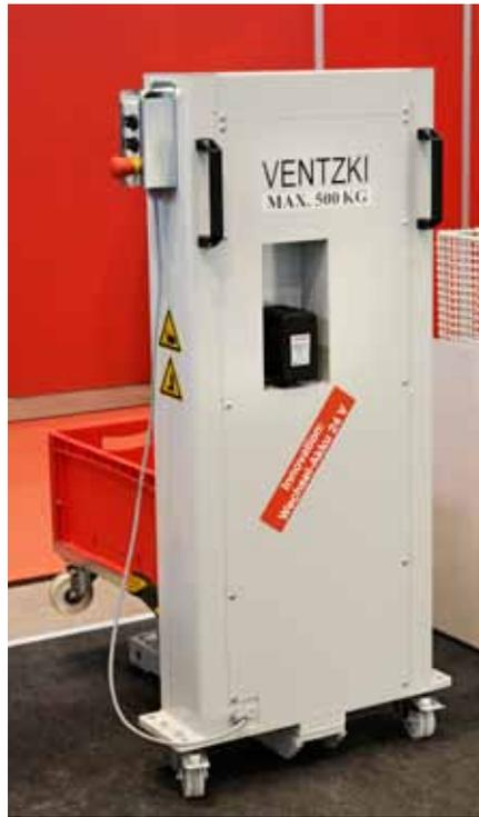
Arbeiten. Das Akku-Hubgerät ist in teilmobiler Ausführung erhältlich. Durch die Ausstattung mit zwei Laufrollen, kann der Standort des Geräts flexibel gewählt werden. Da keine feste Montage erforderlich
