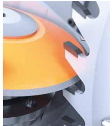
**Hartmetallbestückte Kreissägezähne werden mit den CHP-Maschinen an den Span- und Freiflächen bearbeitet.**
