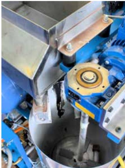
**Wasser und Korund werden bei der Waterjet Suspension Cleaning Technology bereits vorab in einem Behälter vermischt, was die hohe Effektivität des patentierten Verfahrens erklärt.**
