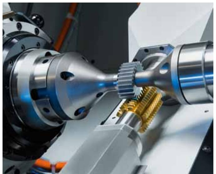
Der Wälzprozess erfolgt mit perfekt synchronisierten Maschinenachsen. Der Wälzfräser fährt das Teil konturengetreu ab.
