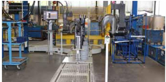
Auf den geraden Strecken wird das von Knoll entwickelte Staurollen-Transportband ›TS-S‹ eingesetzt.
