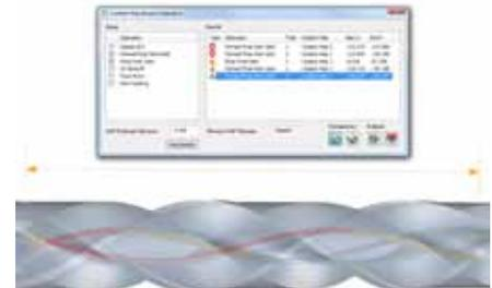
Im Rohlingseditor werden Kühlkanäle definiert. Ein Analyse-Werkzeug bestimmt die minimale Wanddicke.
