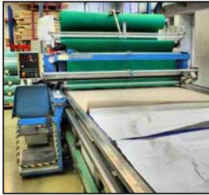
Bis zu zehn Meter lang sind die Stoffbahnen, die vom Ballen abgerollt, mehrlagig gestapelt und akkurat vom Cutter zugeschnitten werden.
