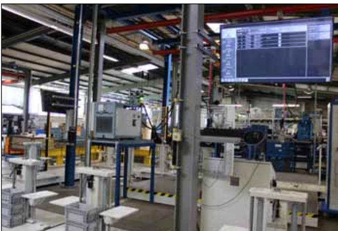
Anfang und Ende der Knoll-Montageanlage bei HAP: Links im Vordergrund ist die Startstation zu sehen, an der das RFID-Tag mit dem Auftrag beschrieben wird, rechts die Entnahmestation.
