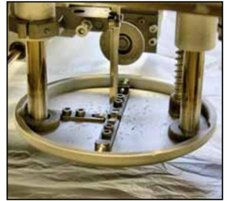
Schneller als jeder Mensch: Der computergesteuerte Cutter besitzt ein spezielles Messer, das rundum drehbar ist, um das Gewebe zuzuschneiden.
