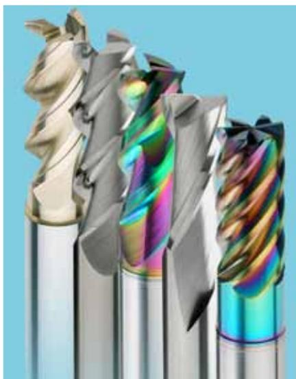
Miete für ein Plus an Leistung. Ein weiteres Augenmerk gilt der Geometrie und der Spankontrolle, die wesentlich die Grenze des Zerspanvolumens bestimmen. Spezielle Geometrien mit schlanken und scharfen Schneidkeilen – drei Schneiden zum Schrappen, sechs Schneiden zum Schlichten – sorgen für ein hohes Abtragsvolumen bei reduzierten Bearbeitungskräften und ruhigem, vibrationslosem Rundlauf.
