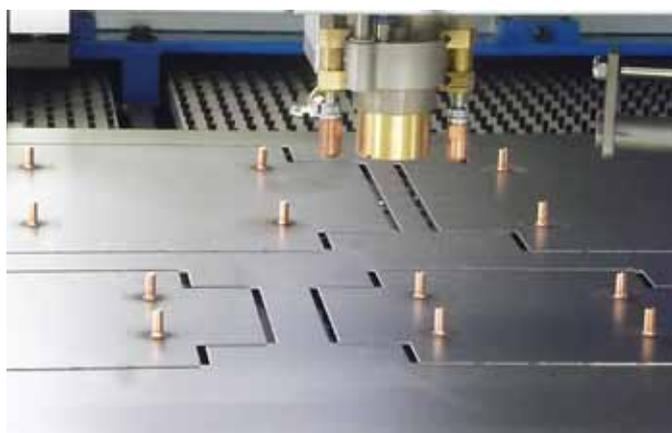
**Mittels des Bolzenschweißkopfes können Blechteile in einer Aufspannung durch Bolzenschweißen komplettiert werden.**
