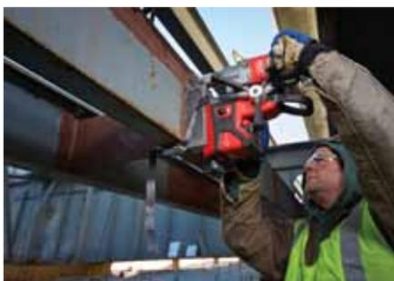
Die ›Fuel M18 FMDP‹ ist mit Redlithium-Ion-Akkus mit 5,0 Ah ausgestattet.
