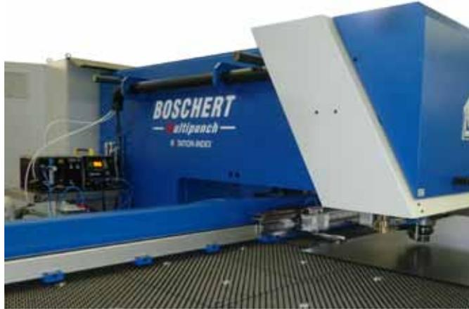
**Boscherts Hochleistungs-CNC-Stanzmaschine ›Multipunch‹ gibt es nun mit der Zusatzausrüstung ›Bolzenschweißsystem‹.**
