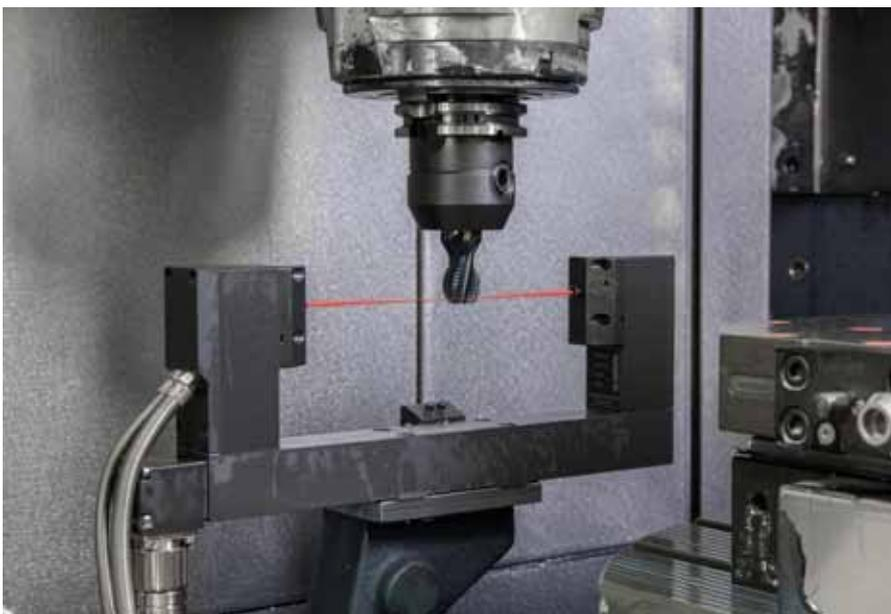
Vom 0,5mm-Kugelfräser bis zum 63mm-Sägeblatt – bei Stryker-Leibinger wird jedes Werkzeug mit Hilfe des Blum-Lasermesssystems gemessen.
