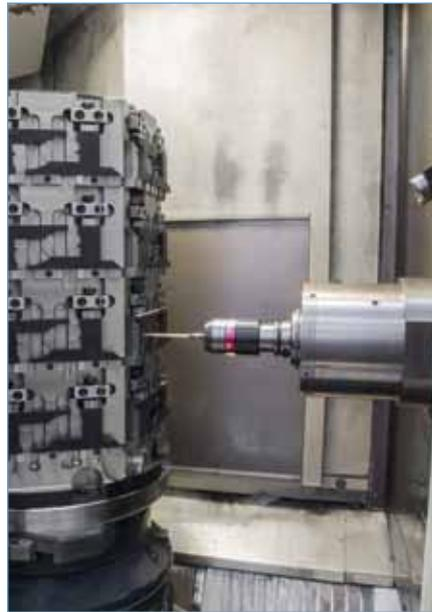
Wärmeeinflüsse machen die Fertigung von Passungen sehr zeitaufwendig. Abhilfe bringen Messtaster von Blum, die in der Messmittelfertigung von Helios Preisser für massive Erleichterung sorgen.
