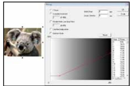
Damit Pixelbilder ansprechend gelasert werden können, ist eine Kopplung der Graustufen mit der Lasergeschwindigkeit problemlos einstellbar.
