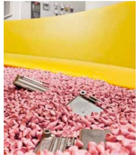
Die acht Millimeter hohen Schleifkörper ›HDC‹ eignen sich besonders für Werkstücke, die viele Innenecken aufweisen.
