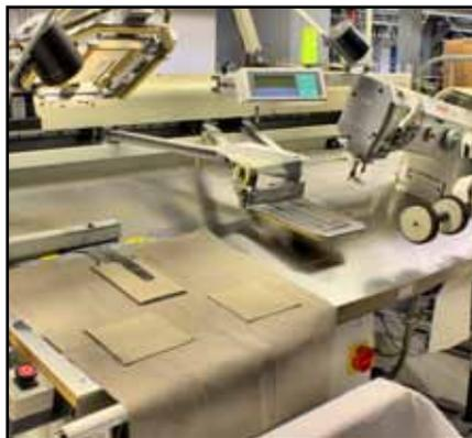
Spezialmaschinen, wie etwa Taschenautomaten, sorgen dafür, dass Routinearbeiten rasch erledigt werden.
