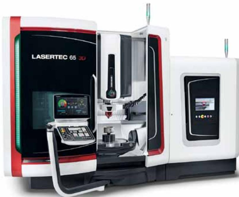
Bei der ›Lasertec 65 3D‹ von Sauer ist der Laser inklusive des Pulveraufbaukopfes im HSK-Werkzeughalter der Frässpindel untergebracht und bei Bedarf automatisch einwechselbar.
