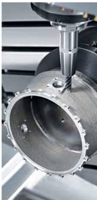
**Technologieintegration: Laserauftragschweißen und Fünfachsfräsen sorgt für beste Oberflächen und hohe Bauteilpräzision.**
