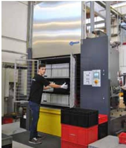
**Ideal zur Transportbehälterreinigung geeignet: Bupicleaner KLT-Reinigungsanlage.**
