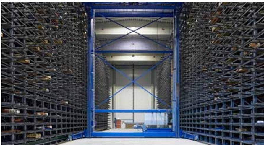
Remmerts Wabensystem zeichnet sich durch eine hochverdichtete Bauweise aus. Die Lagergrundfläche ist trotz höherer Lagerkapazität lediglich doppelt so groß wie bisher.
