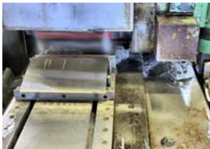
**Mittels Bandschleifmaschinen mit eingebauter Kopiereinrichtung werden Rohling-Pakete in Form geschliffen.**
