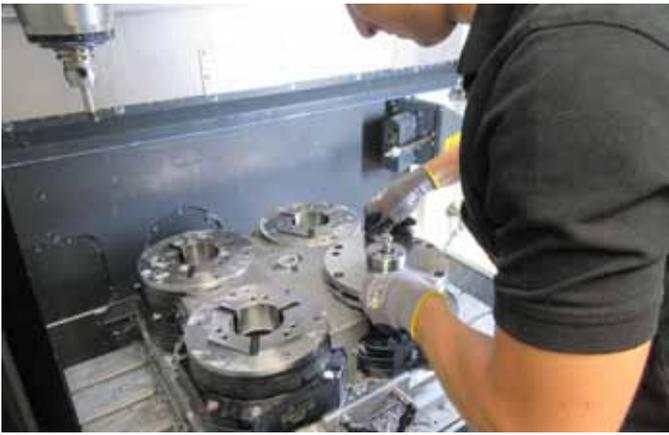
**In den hydraulischen Spannstöcken findet kein Span Platz und der Wechsel von Außen- auf Innenspannung geht ganz flugs.**
